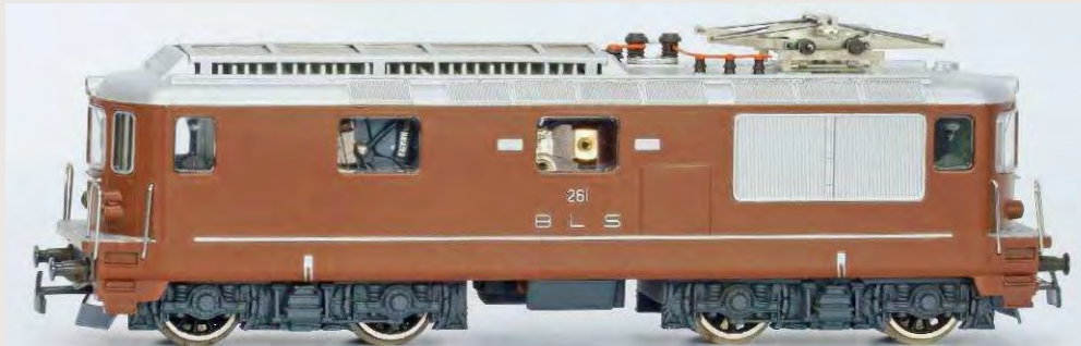
Die BLS Ae 4/4 261 von HAG als Version im Ablieferungszustand, nachträglich verfeinert mit Riffblechfolie und einem Stromabnehmer aus der einstigen Zubehörfertigung von Am Ryhn
