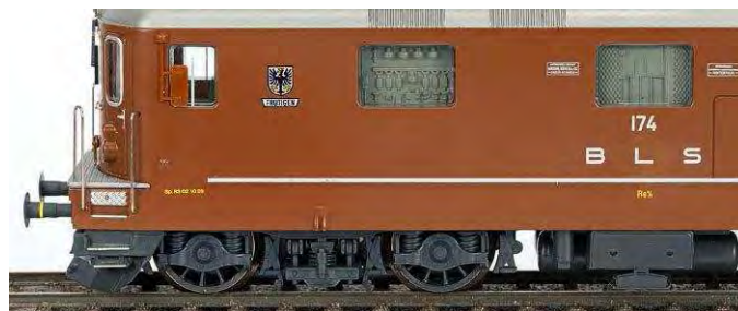
Die Proportionen von zu großem Achsstand und Rahmenblende stimmen bei der Rivarossi-Ellok überein. Die Maschinenraum-Ausstattung ist plastisch, jedoch nur einfarbig in Grün angedeutet
