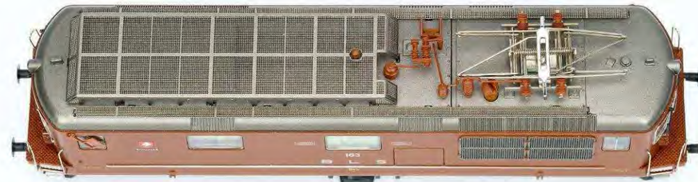
Erste Rivarossi-Modellserie mit durchgehend geätzter Gitterabdeckung des Aufbaues. Die Laufroste sind als durchbrochene Ätzteile angesteckt. Der Drehisolator mit Schlitz dient der O/U-Umschaltung
