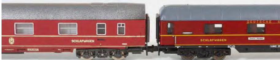
Die unterschiedlichen Dachformen fallen vor allem im Direktvergleich zweier aneinandergekuppelter Fahrzeuge auf: N-Modelle von Atlas/Rivarossi (links) und Minitrix (rechts)
