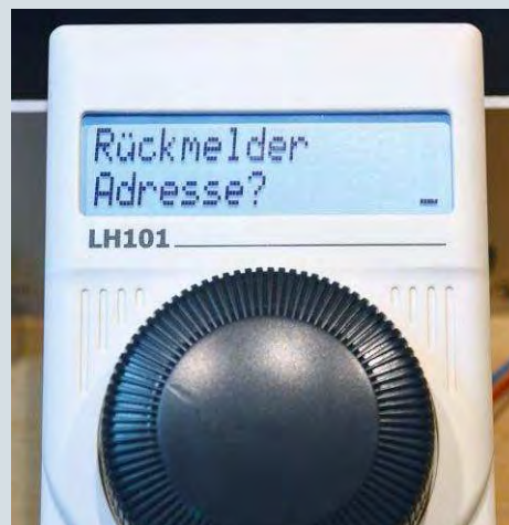
Um die Rückmeldedaten am Handregler – wie hier am LH101 von Lenz – anzuzeigen, muss zuerst die Rückmelderadresse im Bereich von 1 bis 128 eingegeben werden
