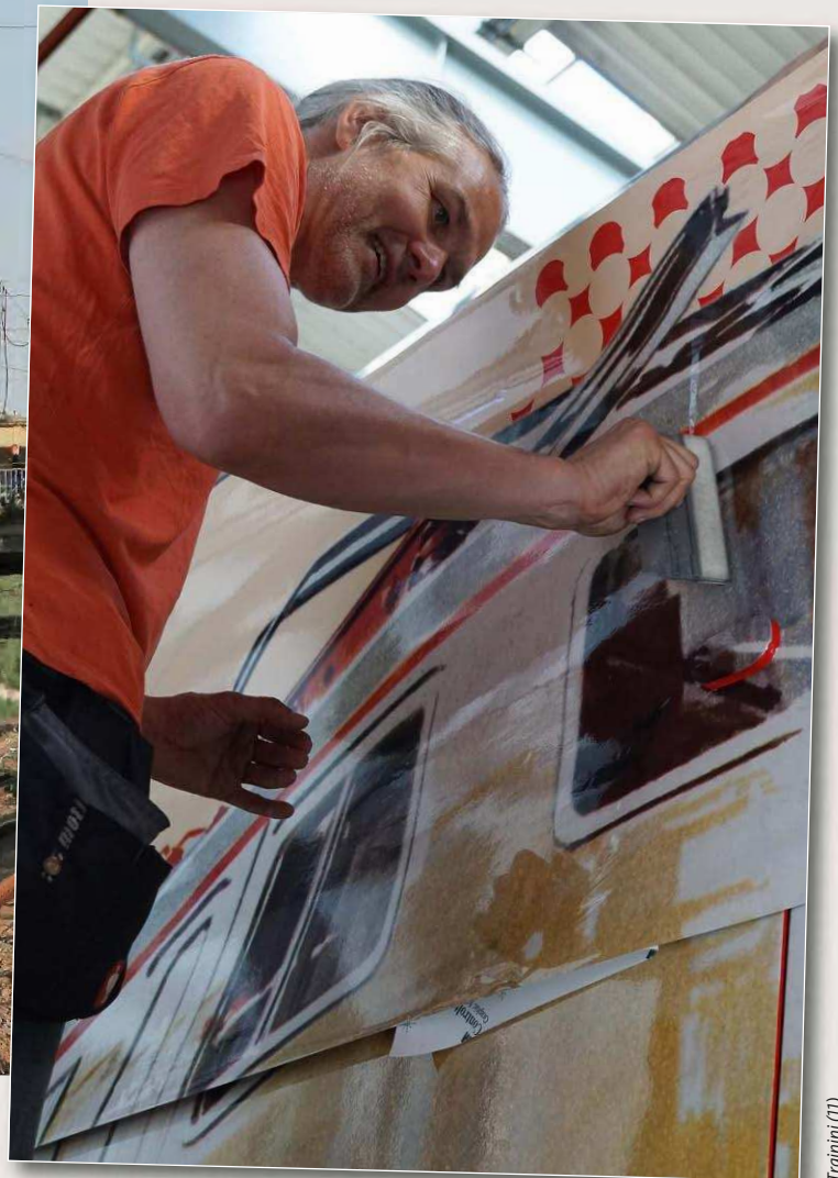
Viel Erfahrung und Geschicklichkeit sind erforderlich, um Werbefolien auf eine Lokomotive aufzukleben
