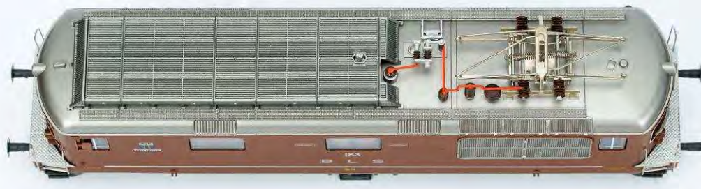
Der Dachaufbau der Lima-Ellok ist etwas vereinfacht aus einem gravierten Kunststoff-Aufsatzteil ohne Gittermuster gebildet. Die beidseitigen Laufstege haben eine Roststrukturimitation
