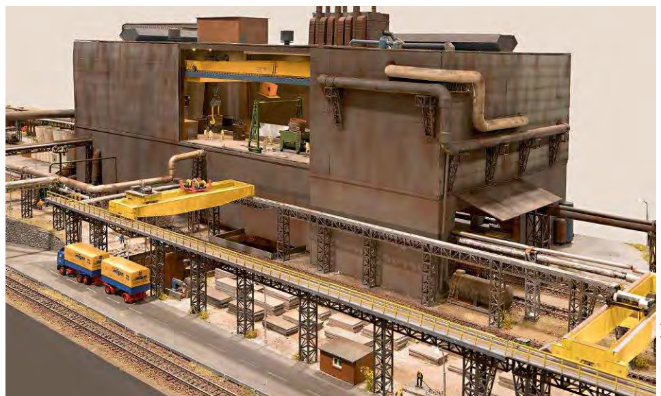
Blasstahlwerk mit offener Stranggießbühne und -kanal sowie Brammenlager
