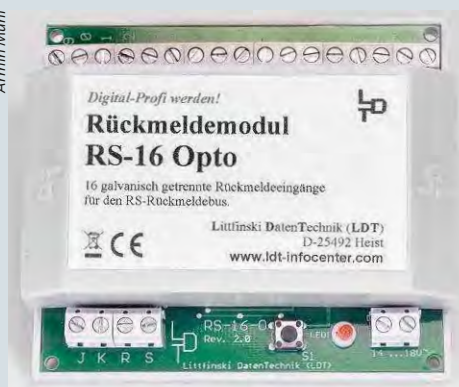
Littfinski-Rückmelder RS-16-Opto für 16 mögliche Schalteingänge
