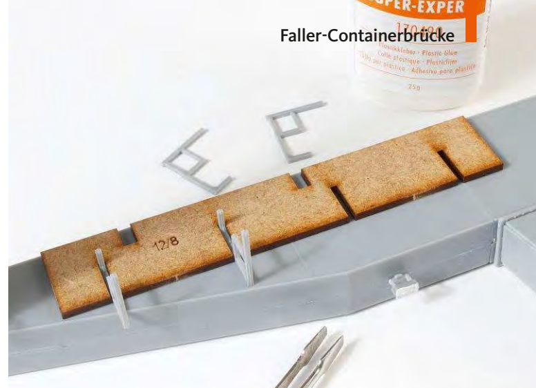
Eine gelaserte Montagehilfe aus MDF-Material legt den richtigen Abstand der aufzuklebenden Bühnenhalter zueinander fest
