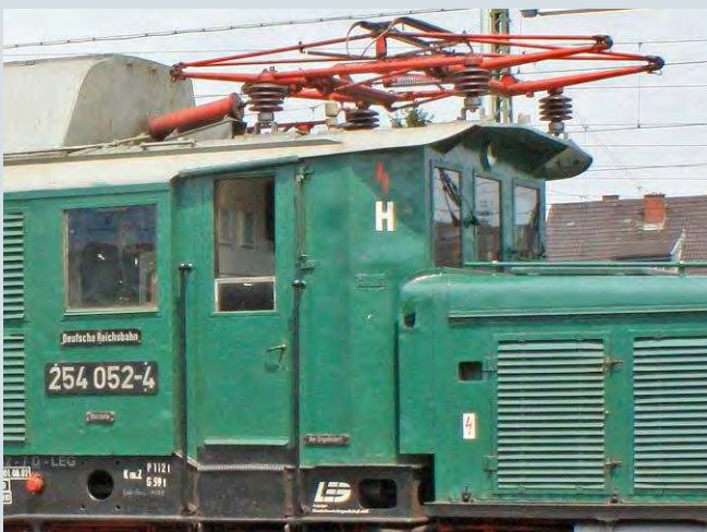
Rote Pfeile warnen an DR-Ellok 254 052 sowohl vor Spannung im Stromabnehmer bzw. Fahrdrat als auch im Vorbau
