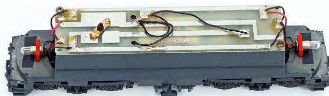
Das Chassis der Lima-Ellok mit Glühlämpchen und einfacher Platine ohne Digitalschnittstelle, wie es Anfang der 1990er Jahre durchaus noch üblich war
