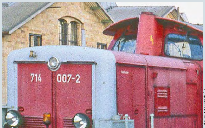
Auf der Rettungszug-Lokomotive 714 007 warnt ein gelber Blitz vor möglicher Hochspannung über der Lokomotive (Fulda, 1997)
