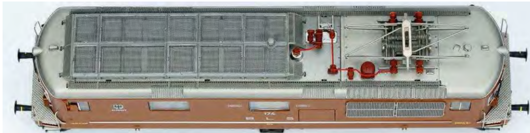
Die zuletzt ausgelieferte Rivarossi-Ausführung zeigt fein geätzte, transparente Gitterelemente auf der Dachaufbau-Oberseite. Ebenfalls sind die Laufroste nach wie vor durchbrochen geätzte Ansteckteile
