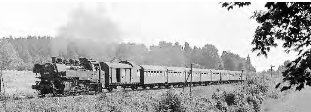
Am 17. August 1973 brachte die mit Usedom-typischen Witte-Windleitblechen ausgestattete 86 1563 den P 18182 nach Wolgaster Fähre; im Hintergrund das Einfahrsignal von Bansin
