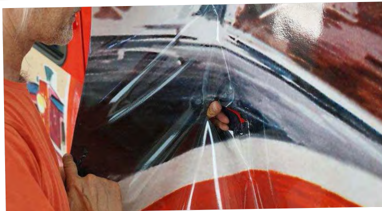
Die Sockel der Haltestangen erlauben kein Warten und müssen sofort ausgeschnitten werden
