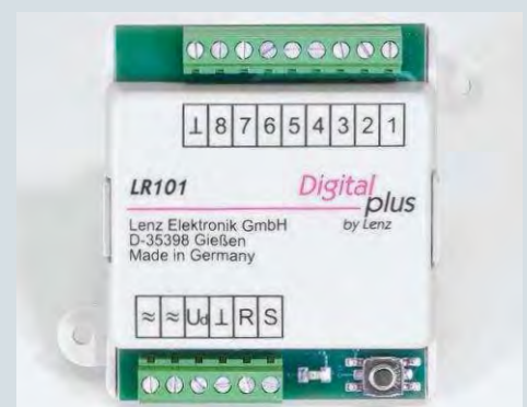
Beim Lenz-LR101 sind oben die acht Rückmeldeeingänge und die gemeinsame Masseklemme vorhanden; unten die Anschlüsse für Programmierung bzw. Spannungsversorgung, für die Gleisspannungsüberwachung und rechts für den RS-Bus
