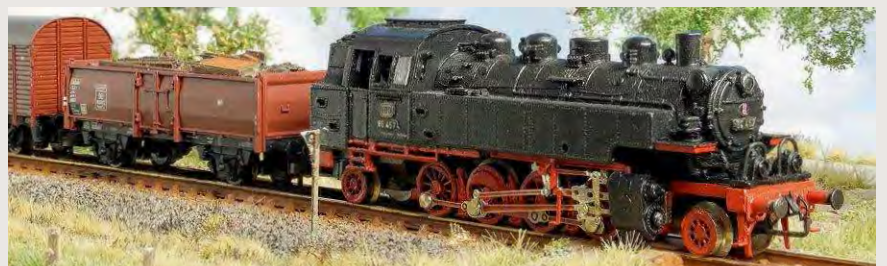
86 457 zeigt die neue, vollbewegliche Steuerung von Bahls samt Bremsnachbildungen, Pufferbohlenaufstiegen, Hakenkupplung, Bremsschläuchen und größenrichtigen Pufferfellertern. Aufbau, Lampenbügel und Beschilderung wurden vom Kunden bearbeitet
