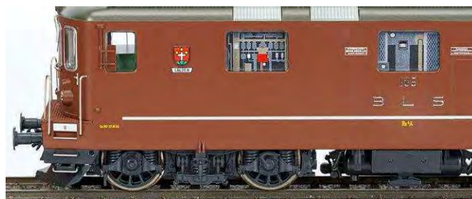
Der Achsstand ist bei der Roco-Maschine etwas knapp geraten, harmonisiert aber mit der Rahmenblende. Der Maschinenraum wird durch mehrfarbige Dekorgrafiken als Digitaldruck imitiert
