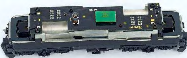
Roco hat eine PluX22-Schnittstelle in seiner BLS-Ellok installiert. Im Rahmen sind außerdem zwei große Aussparungen für etwaige Stromspeicherbausteine für den Digitalbetrieb vorhanden
