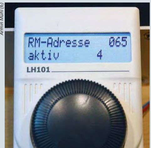
Der Rückmelder LR101 hat als Werkeinstellung die Adresse 065. In der unteren Zeile wird angezeigt, welche der acht Eingänge gerade aktiv, also mit Masse verbunden sind
