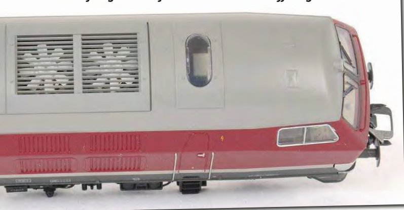
Funktionsfähige Dachlüfter und Lichteintrittsöffnung
