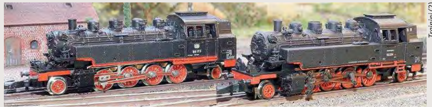
Die Gegenüberstellung der Ursprungsversion (8896) und des Modells von 2019 nach der Produktpflege (88962) demonstriert die optische und technische Märklin-Z-Entwicklung
