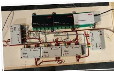
**Ein Teil der Elektronik-Steuerbausteine, die für die Abläufe in den Schattenbahnhöfen und für Blocksteuerungen eingesetzt werden**
