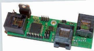
und anderen Bus-Systemen gebaut werden können. So gibt es Adapter für den BiDiBus, wo man S88-N-Module anschließen kann, aber auch von S88-N zum LocoNet gibt es Adapter und für den Märklin-CAN-Bus ebenfalls. Das Wort Adapter trifft es aber nur teilweise. Diese Bausteine können meistens deutlich mehr als nur die Umsetzung, sondern sind oft auch schon vollwertige Rückmelder.
