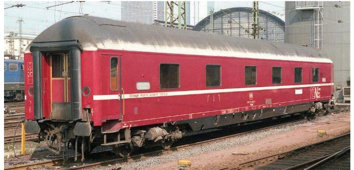
Der Universalschlafwagen vom Typ Hansa (vgl. o.) wurde mehrfach weiterentwickelt. Der 1984 in Frankfurt (Main) aufgenommene WLABmh<sup>75</sup> ist in den TEN-Wagenpool eingestellt
