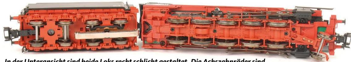
*In der Unteransicht sind beide Loks recht schlicht gestaltet. Die Achszahnräder sind geschützt abgedeckt. Der Schleifer ist bei Märklin unter dem Tender, bei Roco unter der Lok platziert*
