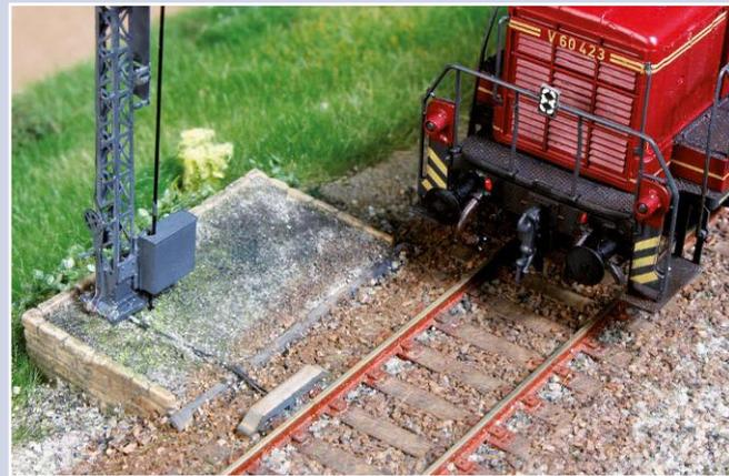
**3** Der fertige Indusi-Magnet – hier von NMW – kann nun neben dem Gleis montiert werden. Dafür wird eine 1,4-mm-Bohrung für den Befestigungsstift eingebracht, 3,7 mm (Bohrungsmitte) von der Schieneninnenseite aus gemessen. Die Bohrung sollte zudem mittig zwischen zwei Schwellen liegen.
