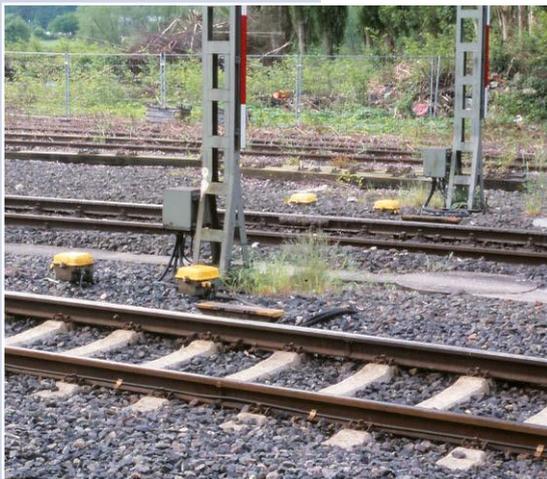
Indusi-Magnete an Lichtsignalen im Bahnhof Fröndenberg samt dazugehöriger Anschlussdosen mit gelben Deckeln – sie sind in dieser Form seit der Epoche IV gebräuchlich.
