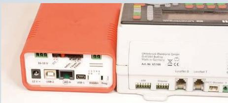
Anschluss an der Digitalzentrale – hier als S88-N bei der RedBox von Tams (links) und als klassischer Anschluss an der Intellibox 2 der Firma Uhlenbrock Elektronik (rechts)
