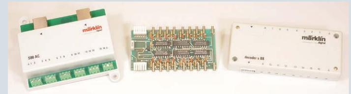
Märklin hat das klassische S88-Modul (im Bild rechts) inzwischen aus dem Sortiment genommen. Der Nachfolger, im Bild links der S88 AC (60881), verfügt schon über den S88-N-Anschluss
