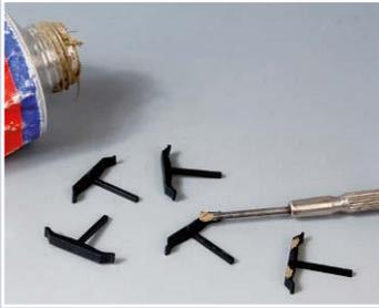
**1** Für eine gleichmäßige Oberfläche verschleißt man die Abdrücke der Auswerfer von der Spritzgussform an den Indusi-Gleismagneten #8702 von NMW mit Nitrospachtel aus der Tube.
