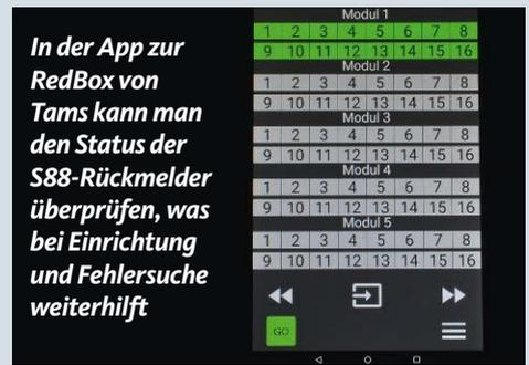
In der App zur RedBox von Tams kann man den Status der S88-Rückmelder überprüfen, was bei Einrichtung und Fehlersuche weiterhilft
