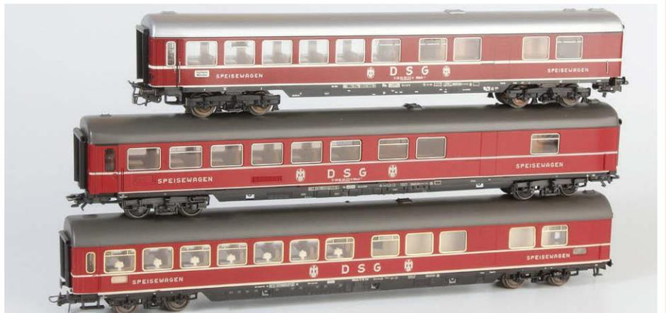
Längenvergleich und unterschiedliche Fensterumsetzungen beim WR4üm-64 von Märklin in 24- und 27-Zentimeter-Versionen (oben und Mitte) und beim Roco-Modell
