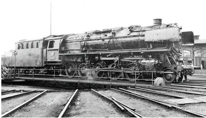
**Die DB-Schleppenderlok 44 1264 – das Original der Märklin-HO-Lok – am 19. Februar 1959 auf der Drehscheibe ihres Heimat-Bw Bebra; diese Maschine war eine der ersten 44er, die 1958 versuchsweise auf Ölhauptfeuerung umgebaut wurden. Mit der Elektrifizierung der Nord-Süd-Strecke kam 44 1264 nach Kassel, wo sie am 3. Dezember 1969 ausgemustert wurde** Helmut Först/Slg. Eisenbahnstiftung
