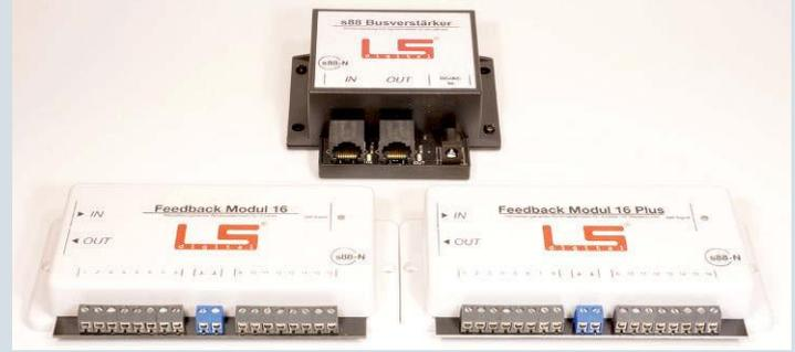
LSdigital bietet auch zwei Module mit Rückmeldeeingängen, wobei das „16 Plus“ die zweite als Meldeschiene genutzte Schiene mit Masse versorgt. Der Busverstärker (oben) dient auch als Stromspeisung
