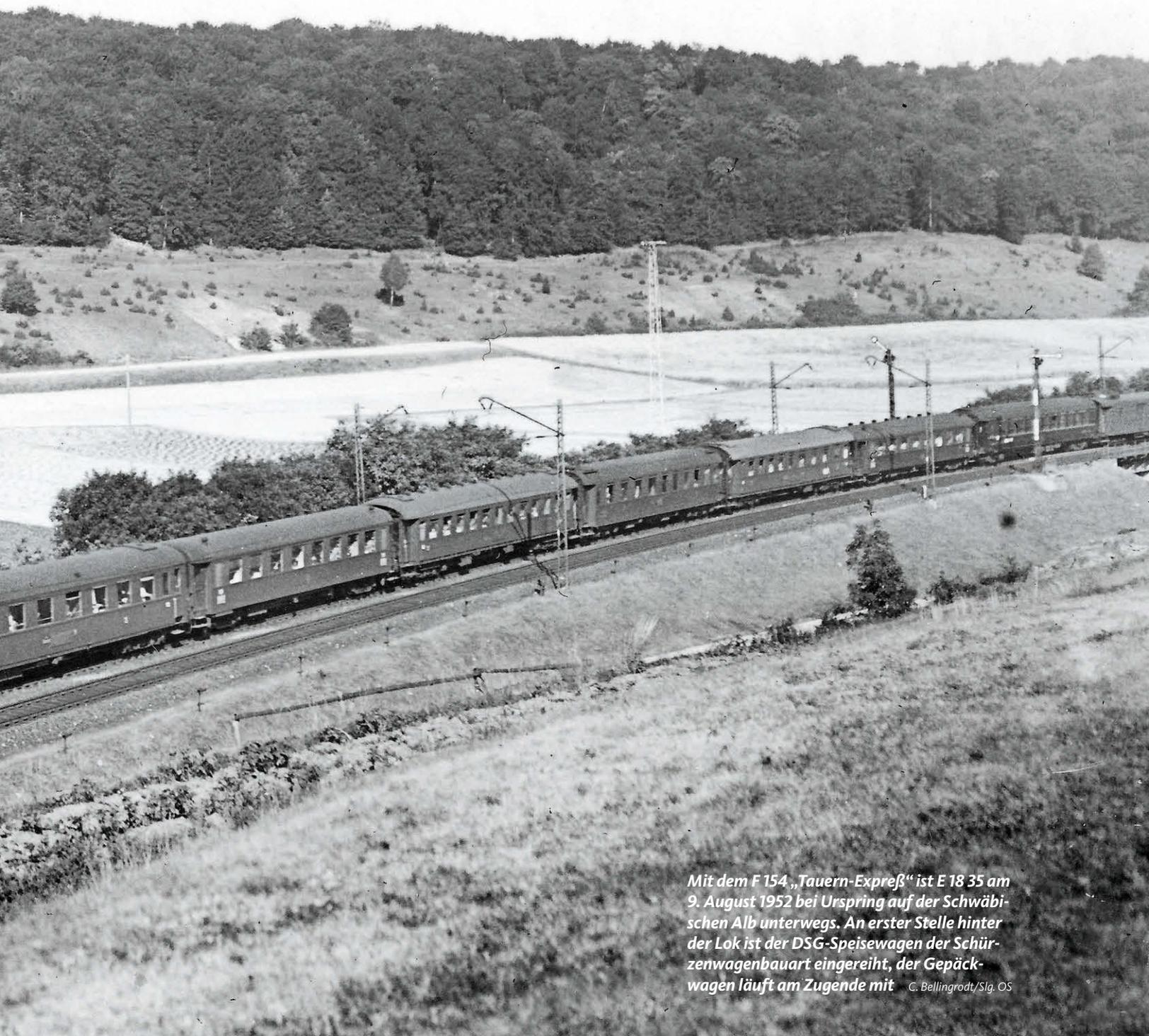
*Mit dem F 154 „Tauern-Expreß“ ist E 18 35 am 9. August 1952 bei Urspring auf der Schwäbischen Alb unterwegs. An erster Stelle hinter der Lok ist der DSG-Speisewagen der Schürzenwagenbauart eingereiht, der Gepäckwagen läuft am Zugende mit* C. Bellingrodt/Slg. OS
