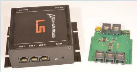
S88-Interfaces von LSDigital (links) und Tams (rechts); ebenso gut geeignet wäre das hier nicht abgebildete High-Speed-Interface der Firma Littfinski-Datentechnik
