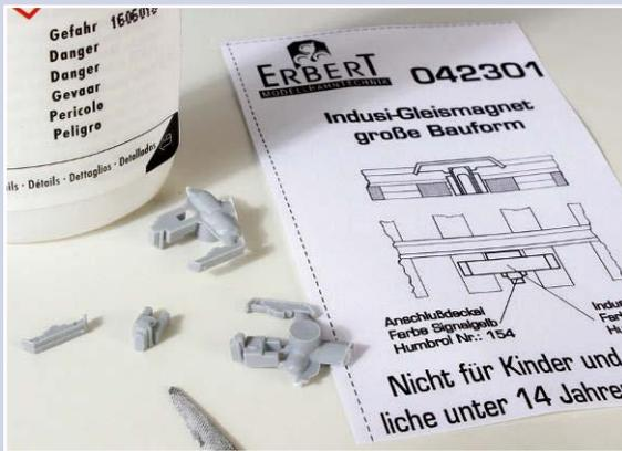
**1** Die für einen Indusimagnet benötigten beiden Teile befinden sich im Erbert/SMF-Bausatz #0042301 an einem Polystyrol-Spritzling. Zum Versäubern nutzt man eine Nadelfeile oder eine Schleifleiste.
