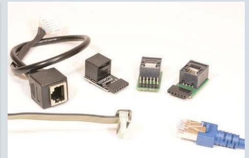
Um altes und neues Verkabelungssystem zu verbinden, gibt es Adapter von Tams und Digikeijs, falls das S88-Modul nur Steckver- bindungen eines der beiden Systeme besitzt
