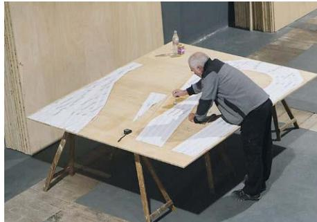
**Die Gleispläne wurden auf Sperrholzplatten geklebt, die Trassen danach ausgeschnitten und mit einer Gummi-Bettung versehen**
