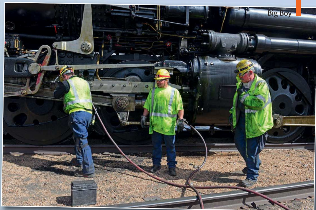
Mit Hilfe von Hydraulikpressen wird das Triebwerk von 4014 gefettet. In Rock Springs kümmern sich am 5. Mai 2019 unter anderem Troy Plagge (links) und Bruce Kirk (rechts) um diese Arbeit
