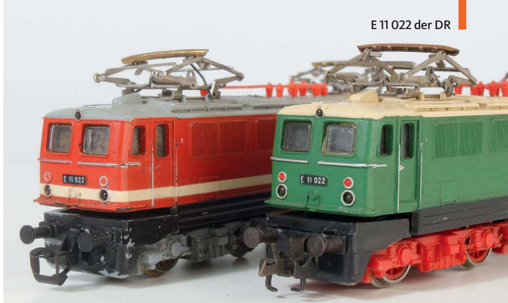
Die beiden TT-Ellok-Schwestern E 11 022 sind nicht nur hinsichtlich ihres Farbkleides verschieden, sondern auch hinsichtlich der Kupplungen, die gebräuchlich waren
