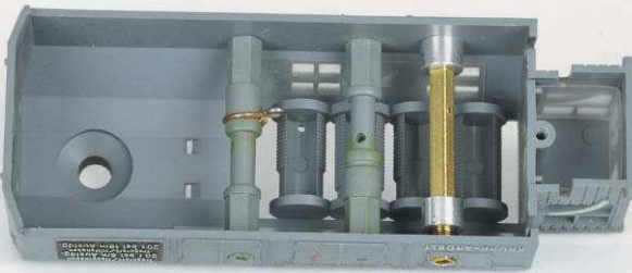
Messing-Gegengewicht und zusätzlich eingebaute Kurbel im Gehäuse
