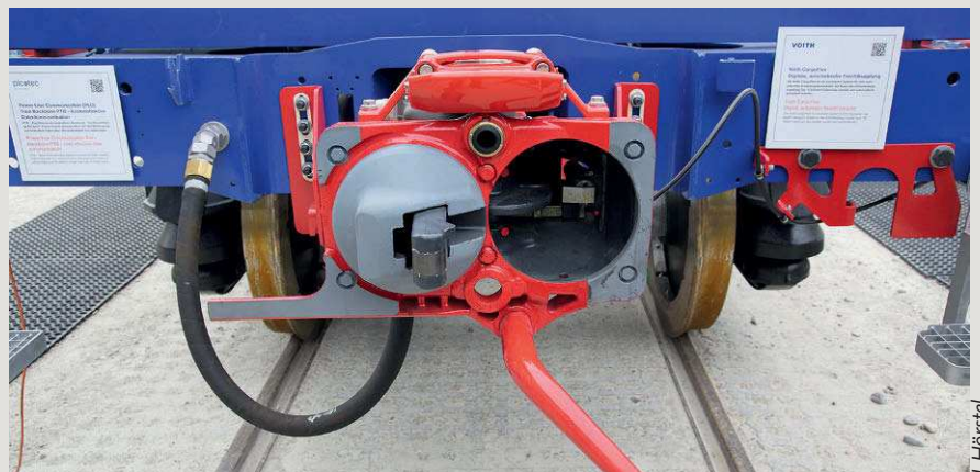
Innovatives Projekt „5L-Zug“ der SBB: Die automatische Kupplung Voith Cargo Flex am Containertragwagen Bauart Sgns ermöglicht auch Daten- und Energieübertragung
