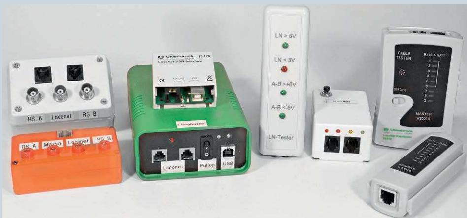
Für Diagnosezwecke gibt es beim LocoNet neben dem Interface von Uhlenbrock und dem Selbstbau-Interface LocoBuffer auch noch Kabeltester, diverse Adapter für Messgeräte und Oszilloskop sowie den Pegeltester. Diese sind als Selbstbau-Projekte sowie bei den Modellbahnherstellern HOFine, Uhlenbrock und Hans Deloof aus Belgien verfügbar
