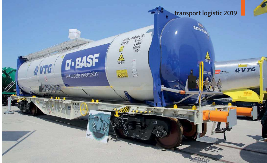
Bei Güterwagen geht die Tendenz zur Trennung von Aufbau und Fahrgestell; ein Beispiel dafür Sgmnss 195 mit VTG/BASF-Tankcontainer
