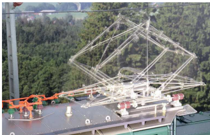
Die Pantografen werden über Servomotoren um 53 Millimeter gehoben und wippen beim Hochfahren vorbildgerecht sanft nach
