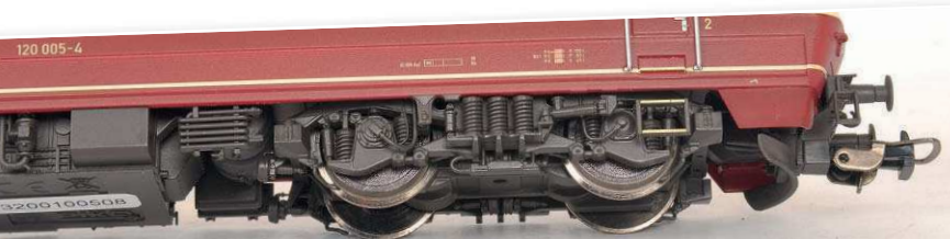
Drehgestelle mit angesetzten Teilen
