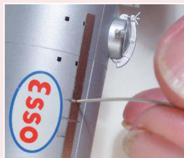
**14** Als Markierung dienen die auf dem Kessel angezeichnete Mittellinie sowie eine eingeritzte Linie auf der Schablone. Die Bohrungen körrnt man mit einer Stecknadel an.
