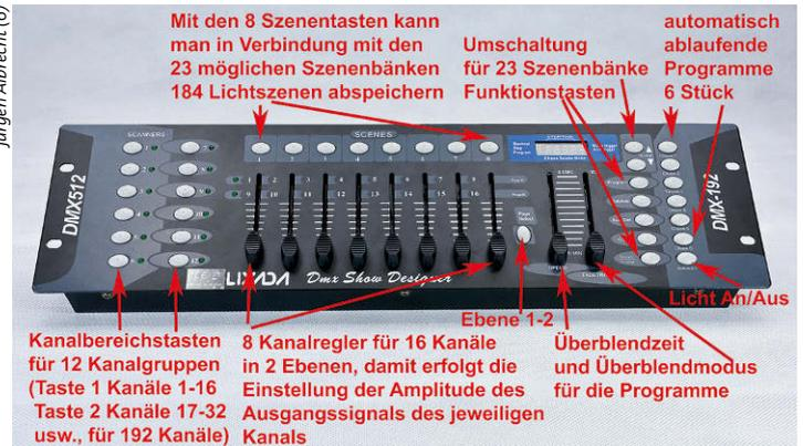
Controller Lixida 192 DMX samt der Erläuterungen für die Tastenbelegung
