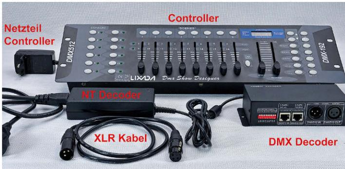
Minimal benötigte Grundkomponenten für eine DMX-Lichtsteuerung
