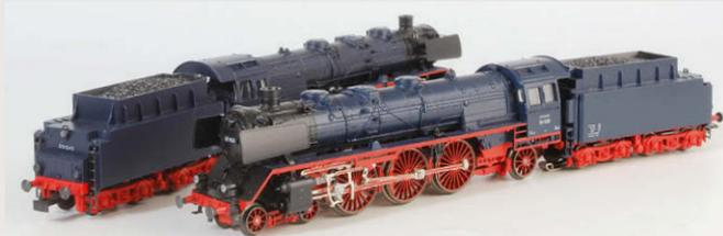
Die als Dreizylinderlokomotiven O3 1023 und 1043 benummerten Märklin-Maschinen mit teils blauem Kessel basieren natürlich auf dem falschen Fahrwerk der Zweizylinder-Konstruktion
