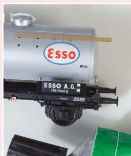
**13** Danach kann die Bohrschablone waagrecht mit einem Montagekleber, z. B. Fixogum, angeklebt werden.
