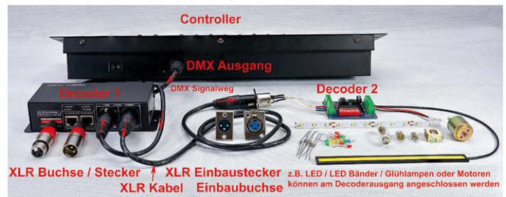
signal über eine XLR-Steckverbindung; es wird über ein dreipoliges XLR-Kabel zu den Decodern geleitet. Sind keine XLR-Steckverbindungen an den Decodern vorhanden, wird das Kabel über die vorhandenen Klemmbuchsen angeschlossen. Die Preise für Controller beginnen unter 50 Euro.
