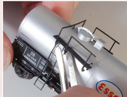
**11** in der Waagerechten. In der Senkrechten orientiert man sich an der Mitte des aufgedruckten Schilds, zeichnet eine Mittellinie auf und misst beidseitig 3,5 mm ab. Um Beschädigungen zu vermeiden, werden die Plattformen mit ...
