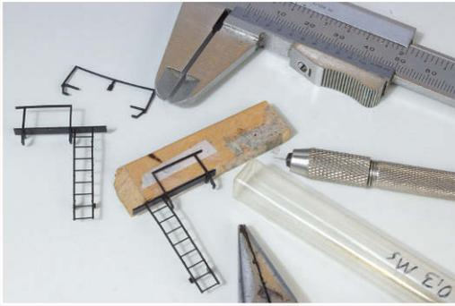
**1** Für die Ausrüstung der Aufstiegsleitern der Bedienplattformen mit vorbildgerechten Griffstangen benötigt man neben 0,3-mm-Messingdraht eine Spitzzange, einen Bohrerhalter, 0,3- und 0,4-mm-Spiralbohrer sowie diverse Holz- oder Polystyrolleisten als Bohrunterlage.
