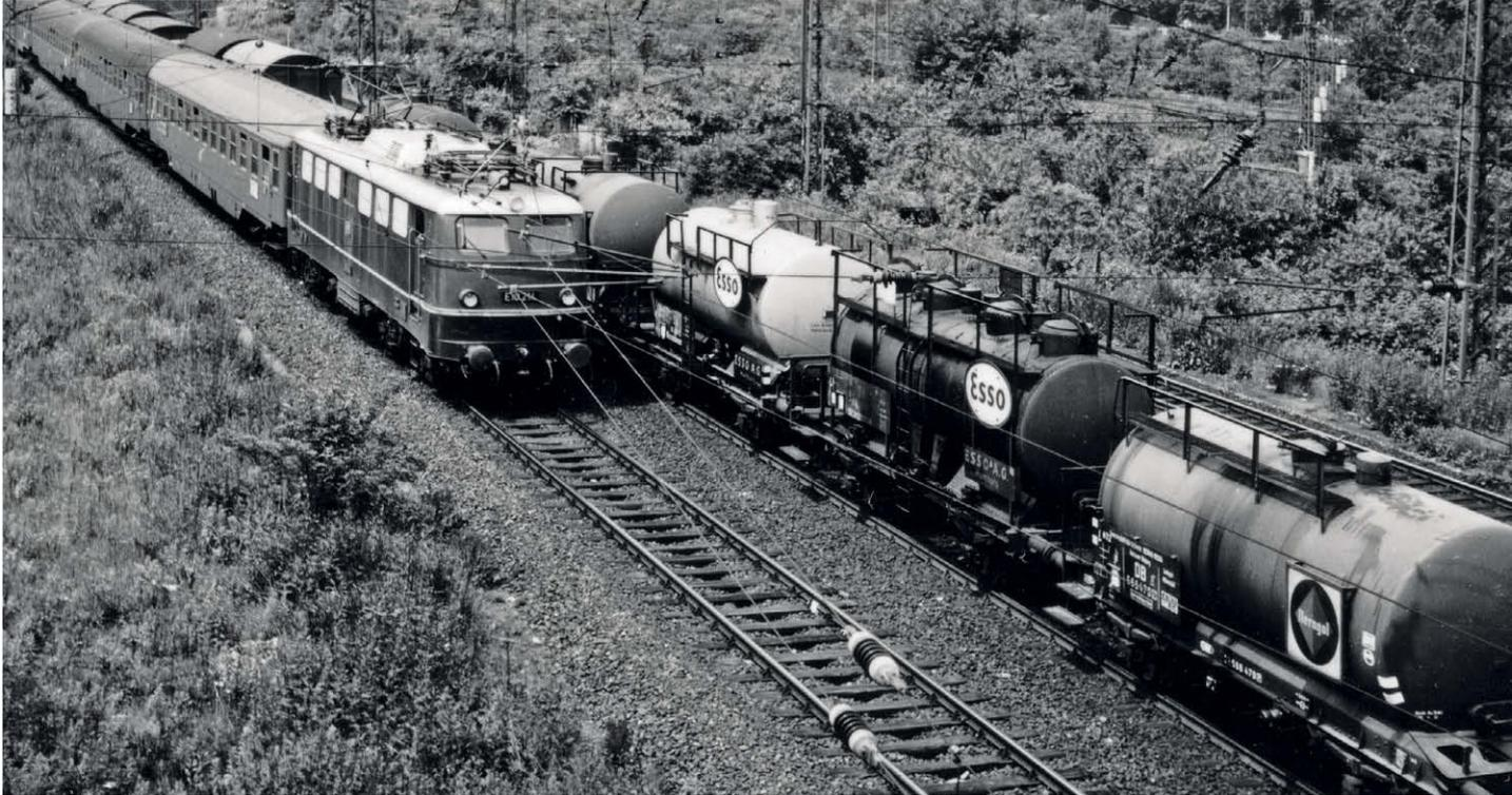
Oben: Firmentafeln an Mineralöl-Kesselwagen gab es in den verschiedensten Ausführungen passend zu den Firmenlogos. Während die beiden vorderen Wagen Esso-Tafeln ihr Eigen nennen, gehört der Kesselwagen der Einheitsbauart dahinter zur Gewerkschaft Erdölraffinerie Deurag-Nerag, ansässig im Raum Hannover, mit dem typischen Neragol-Zeichen.
