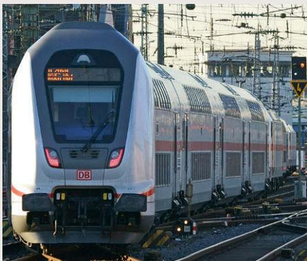
Der TWINDEXX-VARIO-Steuerwagen mit den markanten LED-Leuchtfeldern; im Hintergrund rechts sieht man den Gegenzug in den Kölner Hauptbahnhof einfahren
