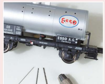
**15** Anschließend werden die Löcher für die Halter stufenweise mit 0,4-, 0,6- und 0,8-mm-Spiralbohrern eingebracht.
