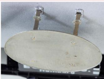
**19** Die Bohrungen lassen sich mit den beiliegenden Flanschplatten abdecken. Dafür fädelt man sie auf die Halter auf, positioniert die Kesseltafel und klebt die Plättchen mit wenig Sekundenkleber an den Kessel.
