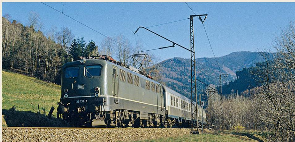
**Nach der 145 wickelt die Baureihe 139 (E 40 mit elektrischer Widerstandsbremse) den Betrieb auf der Höllental- und Dreiseisenbahn ab; Foto bei Hinterzarten, 1993**
