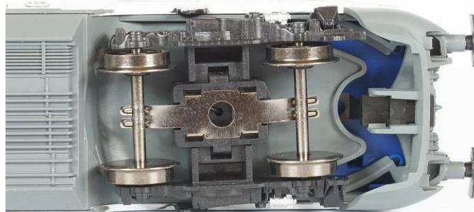
**Piko: Die Magnetschienenbremse ist schmal angedeutet; die Schleiferbleche für die Stromabnahme sind unauffällig schmal**
