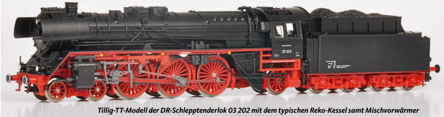
**Tillig-TT-Modell der DR-Schlepptenderlokom 03 202 mit dem typischen Reko-Kessel samt Mischvorwärmer**
