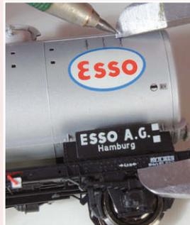
**10** Beim Anzeichnen der oberen Bohrungspositionen, 27 mm ab der Unterkante Längsträger, dient die Bedienplattform als Bezugspunkt
