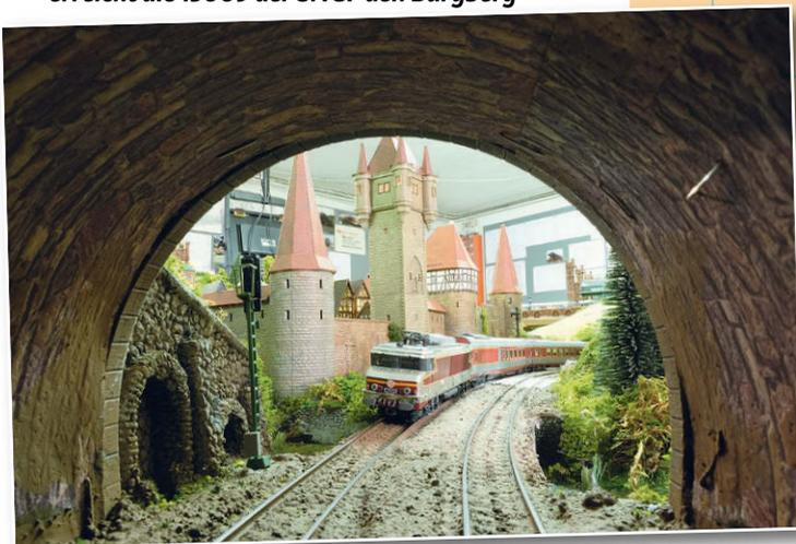
der überschüssigen Steinen wurden die Gleise patiniert. Dabei wurde um die Weichengestänge ein „großer Bogen“ gemacht, was zwar nicht schön aussieht, aber der Betriebssicherheit dient. Fast alle sichtbaren Weichen werden unterflur angetrieben – hauptsächlich mit den zuverlässigen Conrad-Weichenantrieben samt Endabschaltung und Herzstück-Polarisierung.
