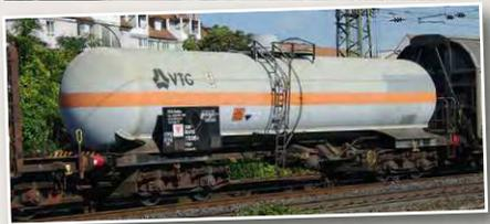
*Inzwischen wurden die alten zweiachsigen Fährbootwagen durch neue vierachsige Spezialwagen privater Einsteller abgelöst. Dazu gehören unter anderem Kesselwagen wie links im Bild, aber auch Schiebewand- und Coil-Transportwagen*
