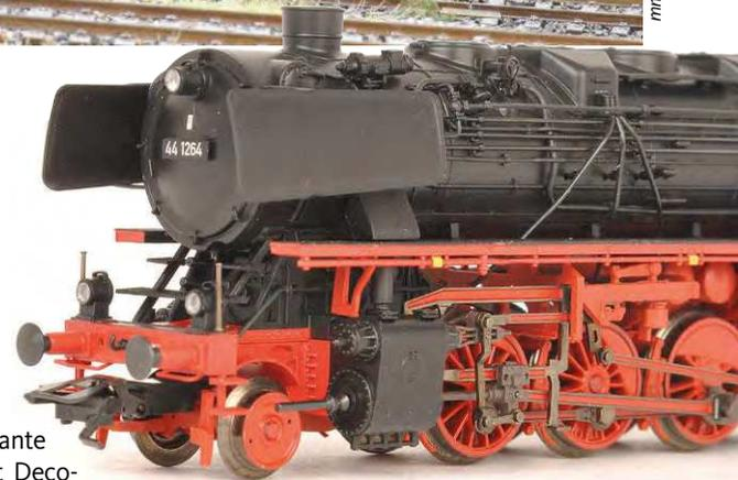
Frontansicht mit eingesteckten Kolbenstangenschutzrohren
