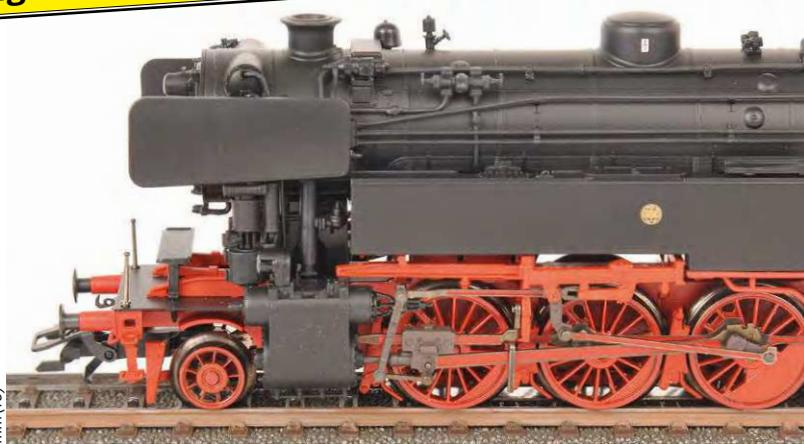
**Witte-Windleitbleche, Zylinder, Gestänge und Rahmen an der Heizerseite der 65 018 (links) und 65 012 im direkten Vergleich**
