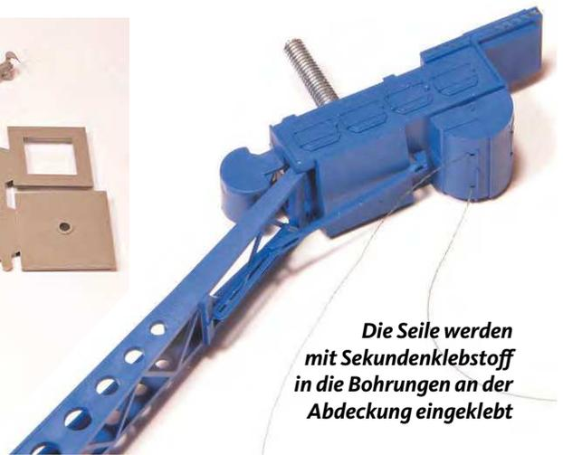
Die Seile werden mit Sekundenklebstoff in die Bohrungen an der Abdeckung eingeklebt
