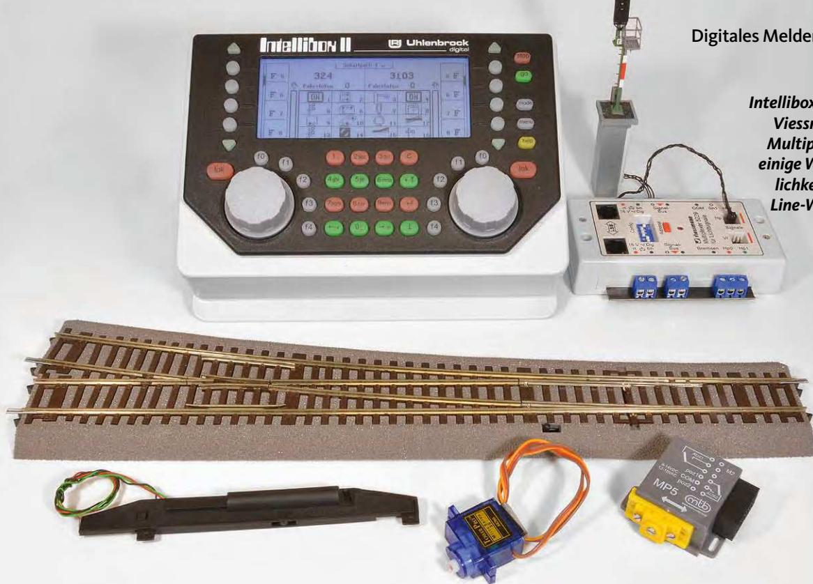
**Intellibox II von Uhlenbrock, Viessmann Ks-Signal am Multiplexer-Decoder und einige Weichenschaltmöglichkeiten für eine Roco-Line-Weiche mit Bettung**
