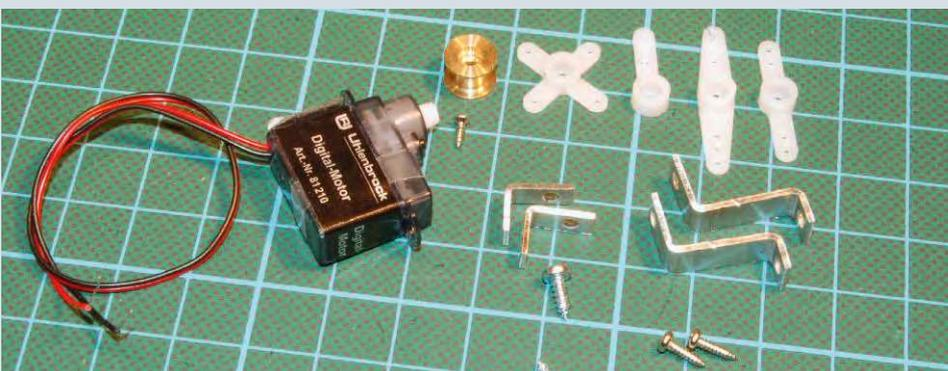
Der Digitalmotor 81210 von Uhlenbrock ist ein recht exotisches Gerät mit integriertem Decoder und wird mit zahlreichen mechanischen Zusatzteilen angeboten
