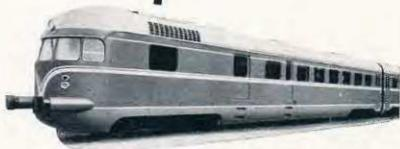
1000 PS Dieseltriebzug für den Nahen Osten mit 130 km/h Höchstgeschwindigkeit
