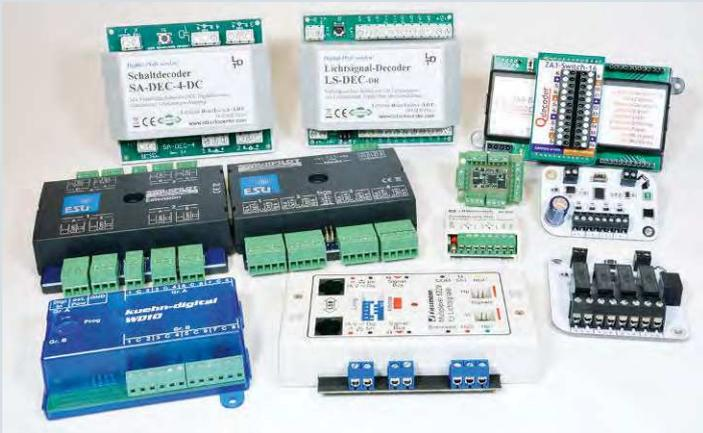
Die Schaltdecoder bzw. die als solche nutzbaren Decoder von Littfinski, hier auch als Signaldecoder vorkonfiguriert, Qdecoder, ESU, Zimo, Uhlenbrock, Decoderwerk mit Relais- und MOSFET-Ausgang, kuehn sowie der für Multiplex-Signale nötige Viessmann-Decoder
