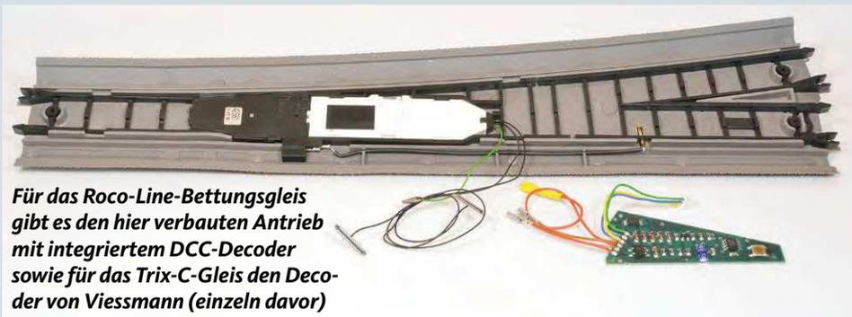
Für das Roco-Line-Bettungsgleis gibt es den hier verbauten Antrieb mit integriertem DCC-Decoder sowie für das Trix-C-Gleis den Decoder von Viessmann (einzeln davor)
