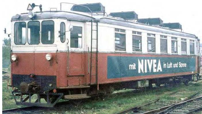
**Panier HOm/e: meter-spuriger DWK-Triebwagen als T 27 der Sylter Inselbahn, hier mit Werbebanner im Vorbildeinsatz**
