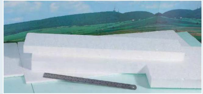
**2** Ungefähr sollte man das Ergebnis schon vor Augen haben. Denn es ist hilfreich, wenn das Material in etwa zur angestrebten Geländeform passt. Dafür wurde der rechteckige Ausschnitt im dicken 50-mm-Styropor mit dem Tischgerät ausgeführt.
