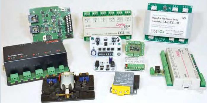
**Schaltdecoder, die speziell für Motorweichen gebaut wurden bzw. dafür bei passender Konfiguration nutzbar sind: Tams, Lenz, Littfinski, Märklin, Decoderwerk, Zimo, Uhlenbrock sowie ganz rechts unten ein Lenz-LS100 mit Adapter für den Anschluss von Motorweichenantrieben**
