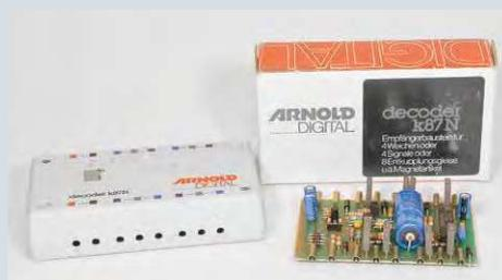
**Der erste DCC-Weichendecoder war einst der k87 von Arnold – hier mit Verpackung, Decoder und Platine. Dieser ist noch immer nutzbar, aber altersbedingt sind fast keine Einstellmöglichkeiten vorhanden**
