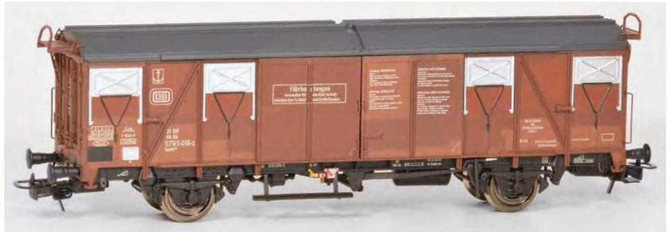
ferbohle montiert sind. Auch diese sollten am Modell immer vorhanden sein. Bei älteren Wagen kommt im Regelfall noch die britische Rangierhandbremse dazu, die auch recht markant ist. Moderne Wagen verfügen meist nur noch über Handräder für die Feststellbremse.
