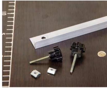
... nicht auf hohe Präzision ankommt. Die Rändelschrauben sind in kleine Nutenstei-ne geschraubt. Beides zusammen im Schlitz zu verschieben, ist hakelig – nicht optimal, um den Anschlag exakt zu fixieren.
