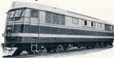
C'C 1900 PS dieselhydraulische Lokomotive für Meterspur brasilianischer Bahnen
