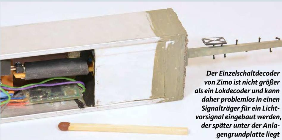
Der Einzeldecoder von Zimo ist nicht größer als ein Lokdecoder und kann daher problemlos in einen Signalträger für ein Lichtsignal eingebaut werden, der später unter der Anlagengrundplatte liegt
