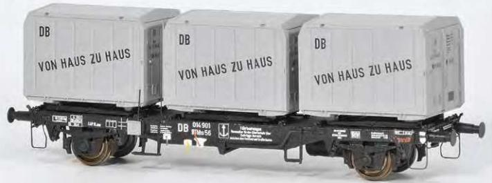
**HO-Modelle aus dem 3D-Drucker der Firma Epoche 3D: Kühlwagen Tbnhs 30 (links) und Behältertragwagen BTbs 56 als Vorabmuster mit Brawa-Containern (rechts), die als Bausatz mit allen Zurüstkteilen auch über den Vertriebsservice von Wagenwerk zu beziehen sind**
