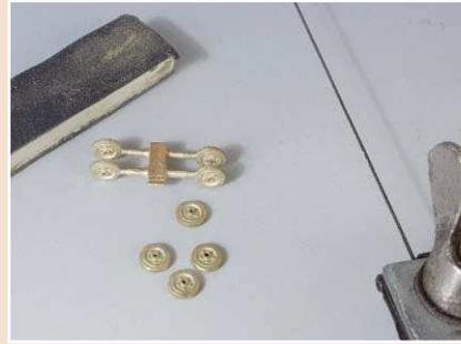
**2** Bevor man mit der eigentlichen Bausatzmontage beginnt, werden zuerst die Räder vom Gussast abgetrennt. Dazu eignet sich eine Laubsäge mit einem Sägeblatt feiner Zahnung. Anschließend werden sie versäubert.
