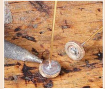
**3** Das Einlöten der Achsen gelingt am einfachsten, indem der beiliegende 0,4-Millimeter-Ms-Draht samt Rad in einer entsprechenden Bohrung in einem Hartholzklötz fixiert wird.
