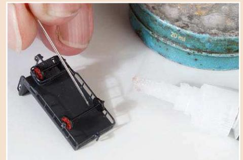
**13** ... zunächst nur lose aufgefädelt, bevor man die Achse in die Ösen anschließt. Anschließend werden die Räder rechtwinklig zur Achse ausgerichtet und von hinten mit einem Tropfen Sekun- denkleber fixiert.
