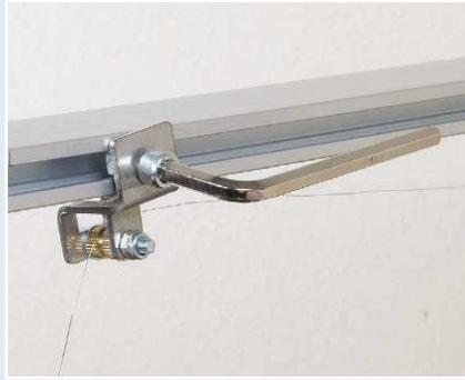
Statt eines kombinierten Sattels gibt es bei diesem Gerät eine separat zu fixierende Umlenkrolle, die den Winkel des Drahts bestimmt. Dahinter ist die genauso verschiebbare Drahtspule am Bügel ...
