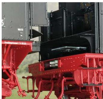
Die neu entwickelte Lok-Tender-Kupplung von KM 1 rastet selbst ein
