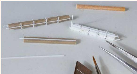
**3** Nun werden Streifen aus 0,5 x 0,25-mm-Polystyrol als Längsbindung mit möglichst wenig Nitroverdünnung aufgeklebt. Dann folgt die Querverbindung aus kleinen Polystyrolabschnitten gleicher Dimension.
