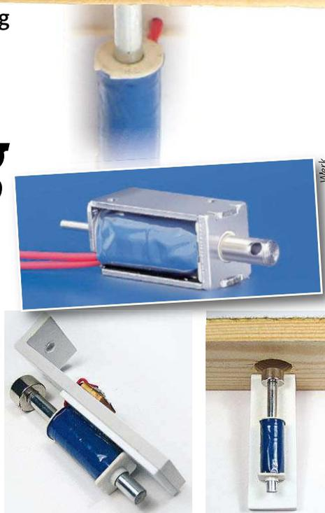
**Original-Hubmagnet aus dem Sortiment von conrad electronic sowie mit längerem Eisenkern und Winkel versehene Eigenbau-Version, die unter die Anlagenplatte montiert wird**
