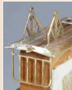
**13** Der Zapfen wird nach dem Einlöten in die Strebe auf die passende Länge abgetrennt und beigeleift, da sich so das Kupplungsmaul einfacher waagrecht ausrichten lässt.
