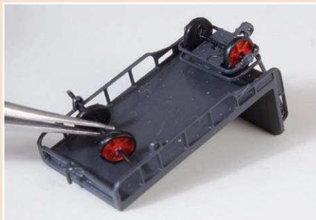
**12** ... RAL 3002 (Weinert #2611) lackierten Felgen mit Maskol von Humbrol ab. Beim Entfernen der Maskolabdeckung hat sich ein Zahnstocher bewährt. Bei der Montage der außen gelagerten Hinterachse werden die Räder ...
