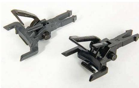
**Rocos Universalkupplung und die ESU-Kurzkupplungsinterpretation (rechts) im Direktvergleich; beiden Kupplungen können gute Betriebseigenschaften zugeschrieben werden**
