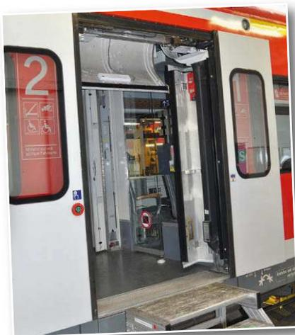
**425 223 der zweiten Bauserie erhielt zur Überbrückung des Spalts zwischen Triebzug und Bahnsteig einen Klapptritt zwischen den Doppelschwenktüren**
