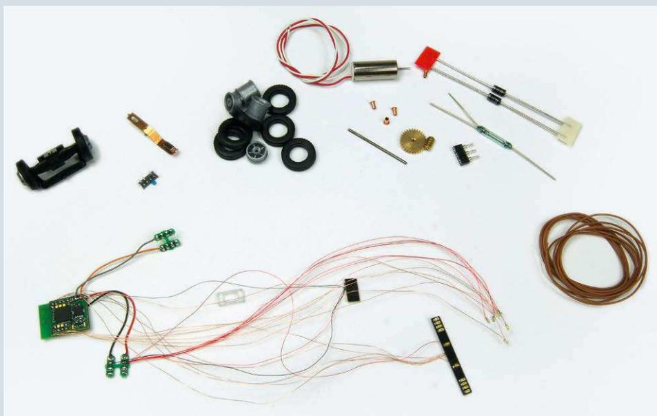
**Für Fahrzeug-Umbauten werden alle benötigten mechanischen und elektronischen Einzelteile separat angeboten. Auch ein Fahrzeugdecoder mit angelöteter Peripherie ist verfügbar**
