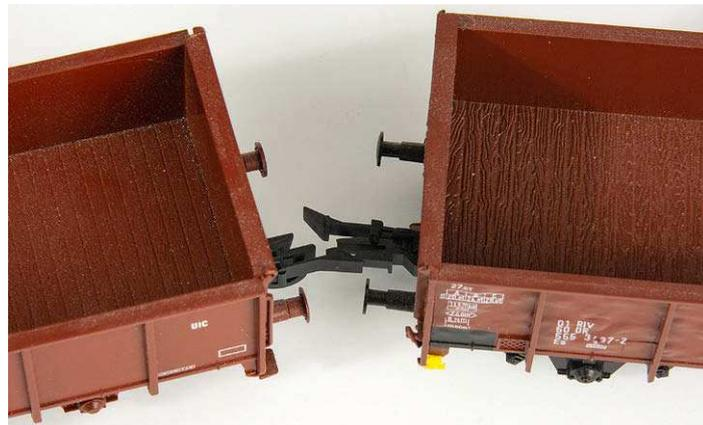
Eine Alternative zu flexibel trennbaren Bügel-, Universal- oder Kurzkupplungen sind starre Verbindungen zwischen zwei Fahrzeugen, die in die Schächte eingesteckt werden; im kleinen Bild links oben Piko, Mitte Ribu/Rietze und unten Märklin
