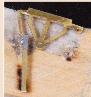
**14** Da die angeätzten Bremsklötze zu flach wirken, sollten sie mit 0,3-mm-Messingblechstreifen aus dem Ätzrahmen aufgedickt und entsprechend der vorgegebenen Form beigeleift oder befeilt werden.
