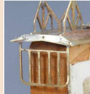
**10** ... hintere Strebe eine 0,4-mm-Bohrung für das Kupplungsmaul. Die vier Ecken dickt man auf einer Länge von 2,4 mm zusätzlich mit zirka einen Millimeter breiten, 0,3 mm starken Abschnitten von Ms-Blechstreifen auf.
