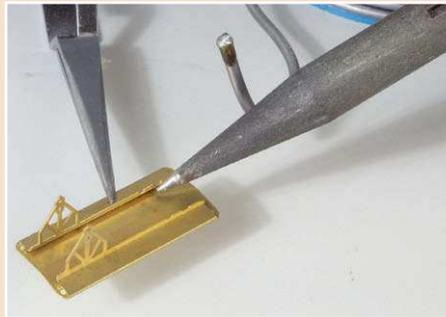
**5** Aus Stabilitätsgründen und damit später beim Lackieren kein Lack in die vorhandenen Spalten fließen kann, sollten auf der Plattformunterseite innen die Längsträger sowie die stirnseitigen Kanten verlötet werden.
