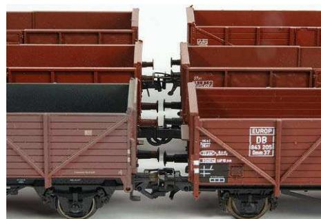
**Unterschiedliche Puffer-Abstände bei Standard-Bügelkupplung (hinten), Roco-Kurzkupplung (Mitte) und Roco-Universaltyp**
