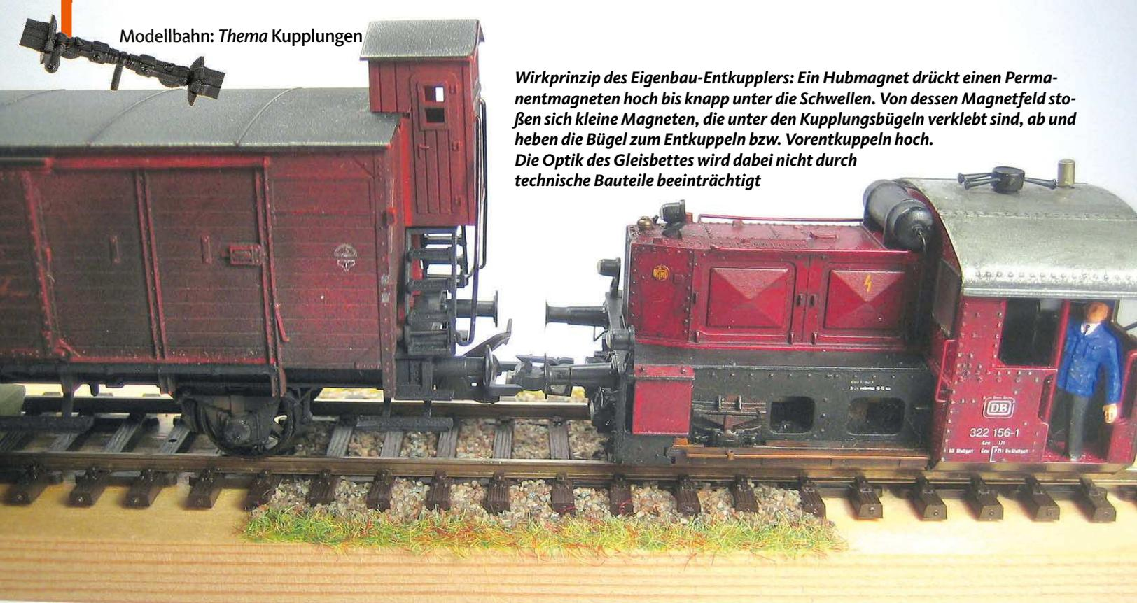
**Wirkprinzip des Eigenbau-Entkupplers: Ein Hubmagnet drückt einen Permanentmagneten hoch bis knapp unter die Schwellen. Von dessen Magnetfeld stoßen sich kleine Magneten, die unter den Kupplungsbügeln verklebt sind, ab und heben die Bügel zum Entkuppeln bzw. Vorentkuppeln hoch. Die Optik des Gleisbettes wird dabei nicht durch technische Bauteile beeinträchtigt**
