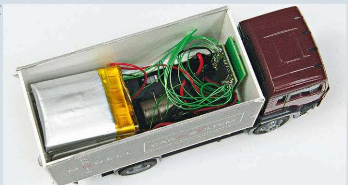
Die Fahrzeuge im Krois-Car-System ähneln auf den ersten Blick den bekannten Modellen aus Gütenbach, sind im Detail aber mit zusätzlichen Features wie Lichtfunktionen und Abstandssensoren ausgerüstet. Die beiden Leiterplatten des Fahrzeugdecoders finden auch in kleineren Kfz-Modellen Platz. Als optimale Stromversorgung dient ein einzelliger 3,7-Volt-Lipo-Akku, der bei Lkw-Modellen gut unterzubringen ist
