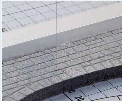
Mit einer Hand wird der Anschlag gehalten, mit der anderen das Werkstück geführt. Dann gelingt ein durchgängig sauberer Schnitt exakt innerhalb der Mauerfuge (Tunnelportal aus Styroplast).
