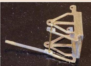
**15** Nachdem die 0,3-mm-Bohrungen neben den Bremsklötzen eingebracht sind, wird das fehlende Bremsgestänge noch durch ein 0,3-mm-Ms-Drahtstückchen komplettiert.
