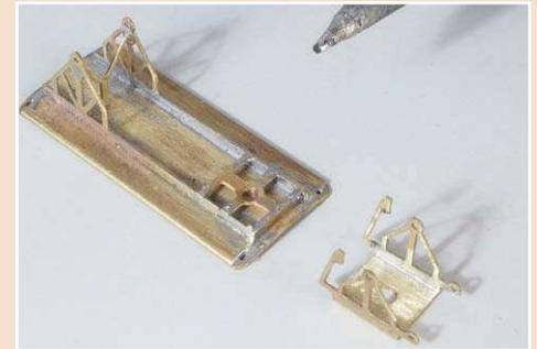
**6** Anschließend werden das Trägerblech für den Drehschemel und die hintere Versteifung zwischen die Achshalter gelötet. Die Seitenwangen des Drehschemels biegt man mit einer Flachzange um rechten Winkel und lötet die Biegekanten zu.
