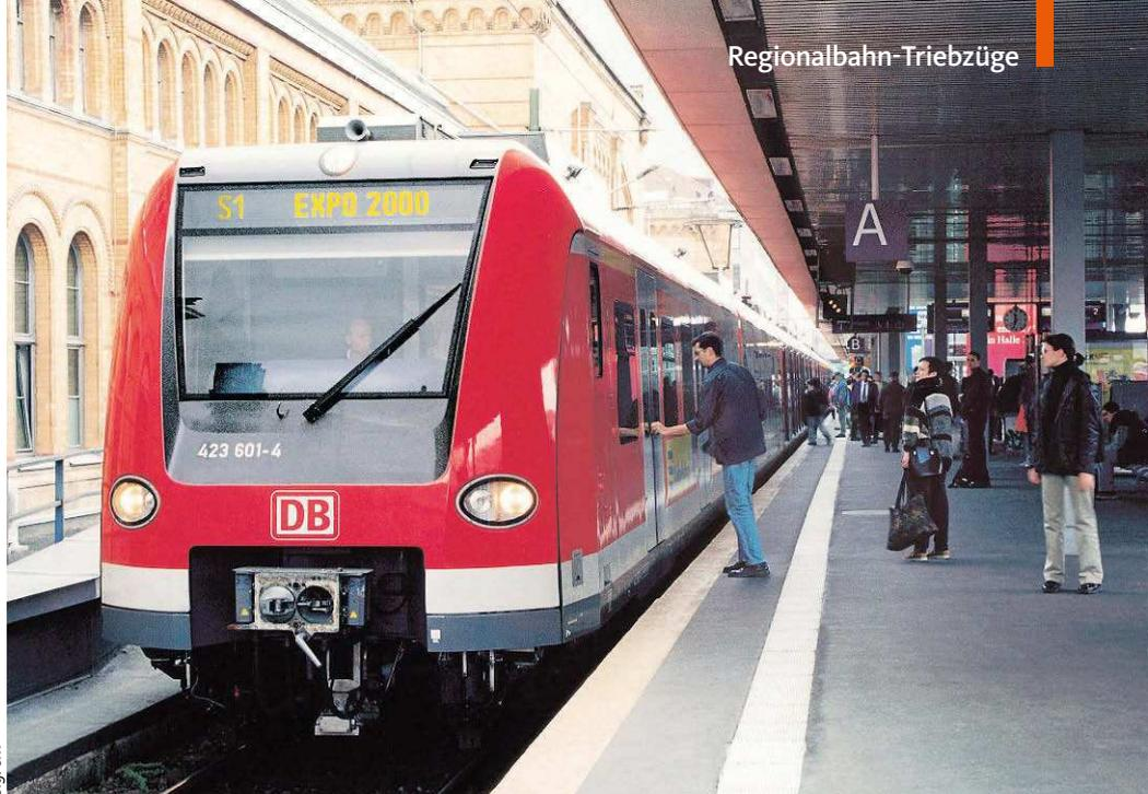
Wird die für Hochbahnsteige ausgelegte Baureihe 423 an flacheren Bahnsteigen eingesetzt, ergibt sich eine Stufe im Türbereich
