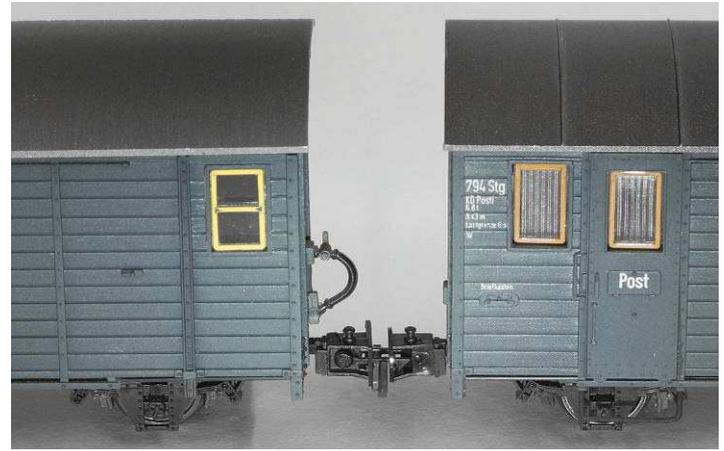
Die höhenjustierbaren Glöckner-Trichterkupplungen kurz vor dem automatischen Einkuppeln (links) und im gekuppelten Zustand
