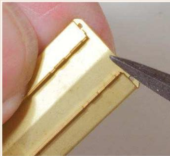
**4** Die Anätzungen auf der Unterseite der vorgebogenen Plattform entfernt man mit einer Nadelfeile in Schwertform.
