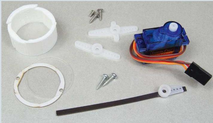
Für Abzweige und Kreuzungen bietet Krois einen Weichenbausatz an. Das Magnetband wird dabei zum Fahrbahnwechsel von einem Servo unterhalb der verlegten Fahrbahn verschoben
