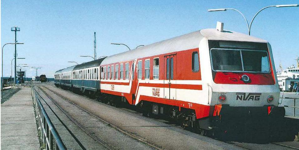
**Wagen 101 der NVAG wurde umfassend modernisiert und mit einem Steuerkopf der Bauart „Wittenberge“ ausgestattet. Am 28. August 1993 hat er Dagebüll Mole erreicht**
