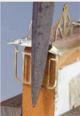
**11** Der jeweils mittlere Teil der Plattformenden wird anschließend bis auf die eingelöteten Blechstreben beigeleift, alle Ecken werden abgerundet.
