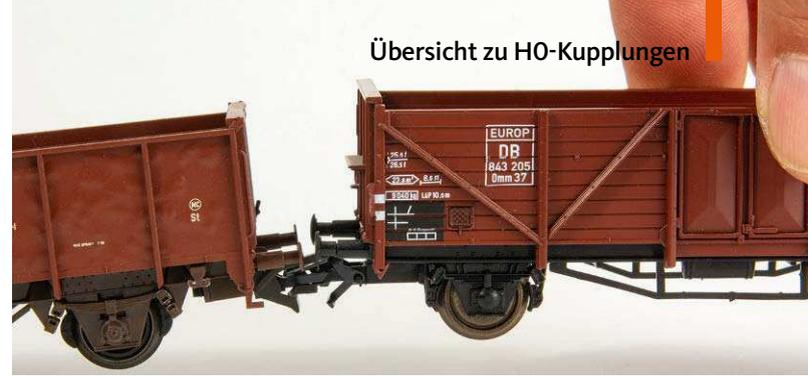
**Wagen mit Roco- oder Fleischmann-Kurzkupplung lassen sich leicht durch Anheben trennen, wie links zu sehen, was bei den Universalkupplungen (rechts) nicht funktioniert – hier müssen die Wagen zum Trennen meist verdreht werden**
