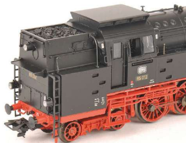
Der große Kohlevorrat erforderte ein stützendes Drehgestell an der Rückseite
