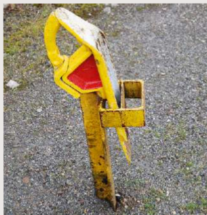
Zwischen den Gleisen kann man die verschiedensten Gestelle für die Ablage der Hemmschuhe finden
