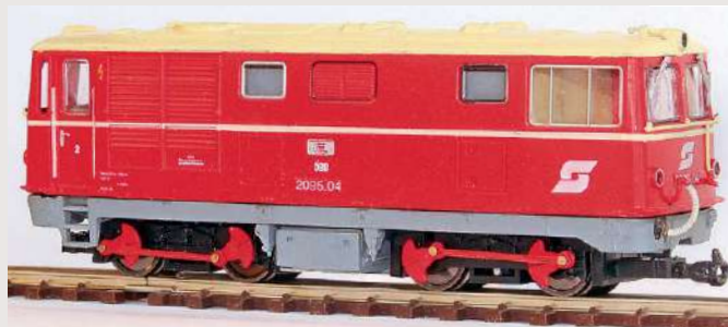
Liliput-Nachfertigung der Firma Stängl von 1998 mit verbesserten Bestückungsteilen und komplett neu konstruiertem Fahrwerk
