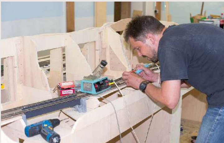
Das Verlegen der Gleise war die Arbeit von Dirk Lauterbach. In regelmäßigen Abständen wurden Stromzuleitungen an die Schienen gelötet
