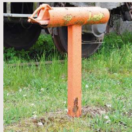
Zwischen den Gleisen kann man die verschiedensten Gestelle für die Ablage der Hemmschuhe finden
