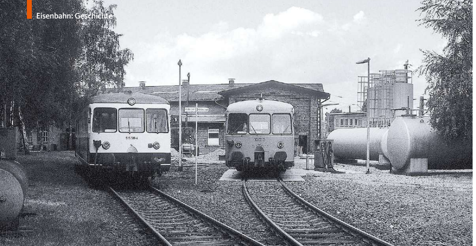
Akkutrieb- und -steuerwagen in den beiden im Frühjahr 1982 aktuellen Lackierungen am Rundschuppen des Bahnbetriebswerkes Hameln. Der 815 steht auf dem Diesel-Tankgleis, rechts sind die Türme der Besandungsanlage und die Lokleitung zu erkennen
