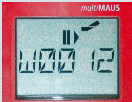
Bei der Roco-multiMaus erfolgt die Eingabe der Weichenadresse über eine Zehner-Tastatur, und auch der Piko-SmartController verfährt so
