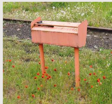
Zwischen den Gleisen kann man die verschiedensten Gestelle für die Ablage der Hemmschuhe finden
