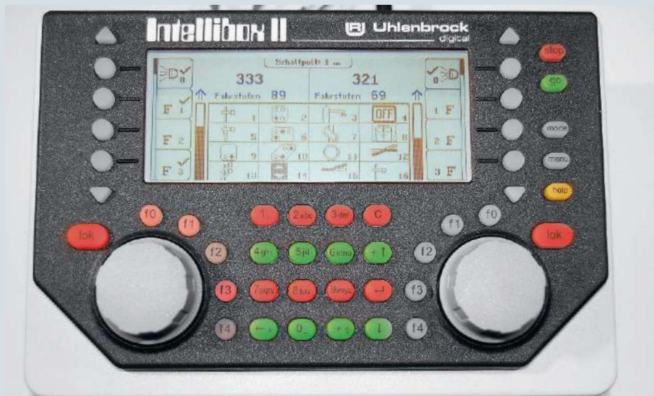
An der Uhlenbrock-Intellibox II ist das klassische Tastenfeld mit zweimal je vier roten und grünen Tasten für die beiden Weichenlagen vorhanden
