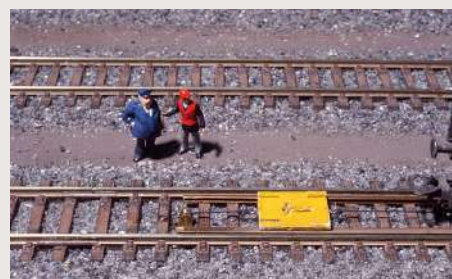
Im Gleis sind die Zusatzschienen und die Seilführung der Transporteinrichtung zu sehen
