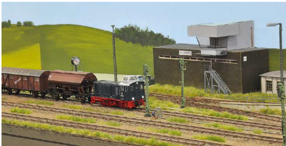
Die ankommenden Güterzüge werden zunächst auf den Gruppengleisen vor dem Stellwerk erfasst und dann in das Ausziehgleis gezogen
