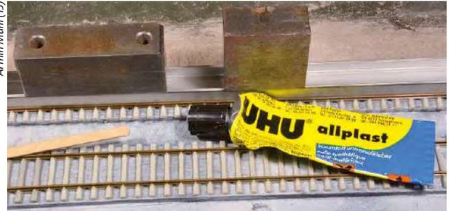
Nach dem Einziehen der Schienenprofile wurde das Gleisjoch mit einer Profillehre exakt gerade ausgerichtet und verklebt
