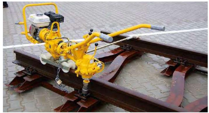
Streckensperrung führten. Durch die geringe Bauhöhe und die schmale Schotterbettbreite sind Y-Schwellen bei beengten Einbauverhältnissen, etwa in Tunneln, vorteilhafter als der klassische Oberbau. Bei mehreren Privat- und auch bei vielen Werksbahnen sind Y-Schwellen weit verbreitet, bei den Harzer Schmalspurbahnen sogar in Meterspur. Angeboten werden die Schwellen für Vorbild-Spurweiten von 750 bis 1.520 Millimetern.
