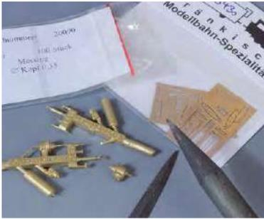
**10** Die 14-Zoll-KE-Bremse der Fränkischen Modellbahnteilfabrik besteht aus dem Gussteilensatz sowie dem Neusilber-Ätzblech. Zusätzlich benötigt man 0,3-mm-Nieten mit 0,35-mm-Kopf als Verbindungsstifte vom Wagenwerk; ...
