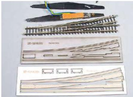
Die beiden unterschiedlich gelaserten Pflisterelemente für eine mini-club-Weiche. Der Antrieb wird mit einer kleinen Laubsäge entfernt. Die Betätigung der Weiche erfolgt später mit einem Unterflurantrieb
