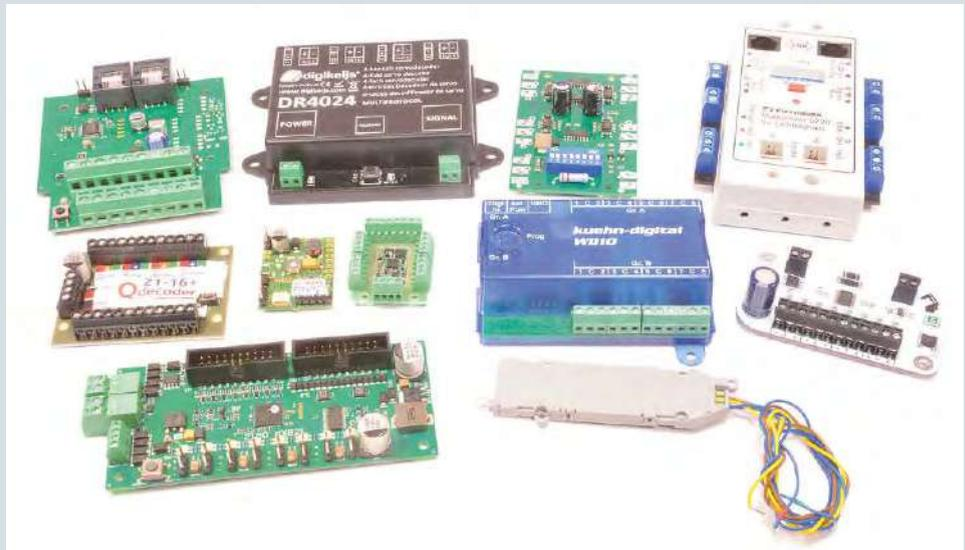
Verschiedene Schalt- und Servodecoder der Anbieter Decoderwerk, Dietz, digikeijs, kuehn, QElectronics, Tams, Viessmann und Zimo sowie ein Weichenantrieb mit eingebautem Decoder
