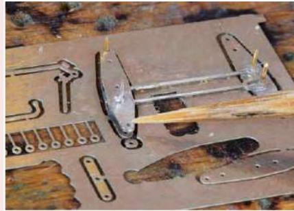
**11** ... kleine Abschnitte eines 0,3-mm-Messingdrahtes erfüllen den selben Zweck. Das Bremsgestänge wird entsprechend der Bauanleitung zusammengelötet. Dabei hat sich dessen Fixierung durch 0,3-mm-MS-Drahtstücke in einem Hartholzklotz als vorteilhaft ...
