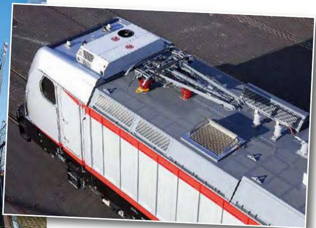
**Die TRAXX 3 für Israel Railways unterscheiden sich in Details von den europäischen Schwesterloks. Auffällig ist die im Dachbereich über den Führerständen installierte zusätzliche Klimaanlage**
