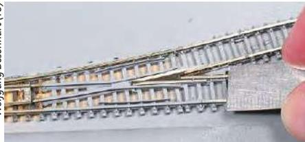
Mit einem Zahnstocher, den man mit einer kleinen Kerbe versehen hat, lassen sich die Schienenköpfe gut vom Haftgrund befreien, alternativ kann für die Reinigung auch ein ausgedientes Lineal verwendet werden
