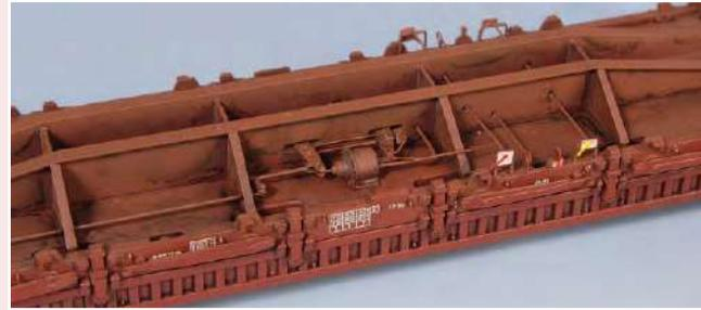
**17** Die fertig montierte Bremsanlage auf der Bremszylinderseite samt Handbremsgestänge und Umstellhebeln aus dem Weinert-Ätzblech, Gestänge aus 0,3-mm-Ms-Draht und Weinert-Lösezug.
