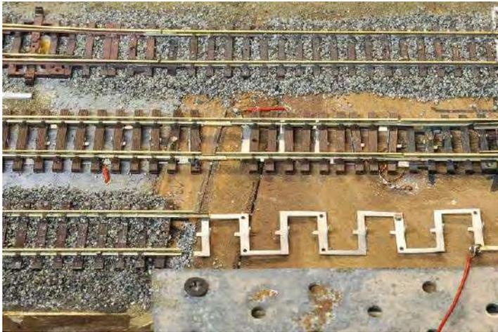
*Wenn das gestanzte Band zuerst auf der Anlage befestigt wird, müssen die Schwellen entsprechend ausgerichtet werden*
