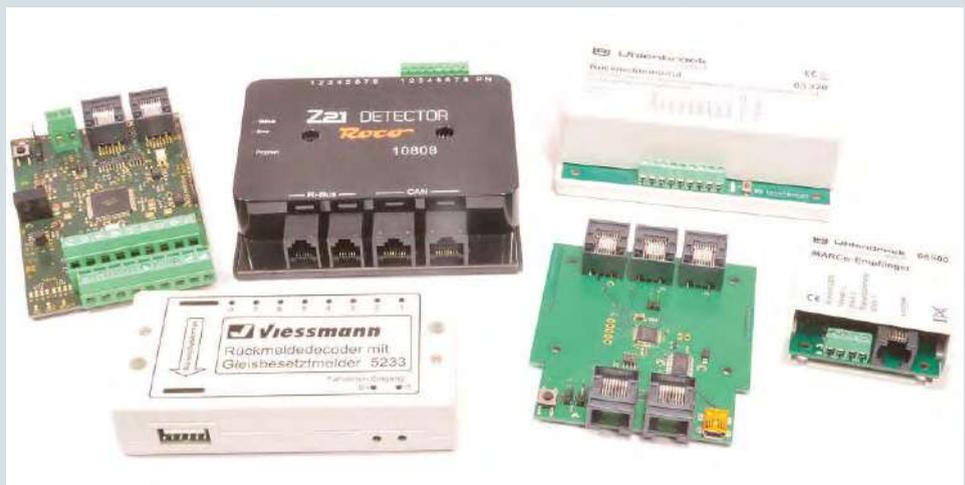
Rückmeldebausteine von Roco, Uhlenbrock, Viessmann und Tams für verschiedene Rückmeldesysteme und teilweise ausgestattet mit RailCom-Detektoren
