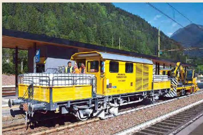
Einsatz der Lackiermaschine RFI zum Weißen der Schienenflanken gegen das Aufheizen bei Gleistrassen der Italienischen Staatsbahnen
