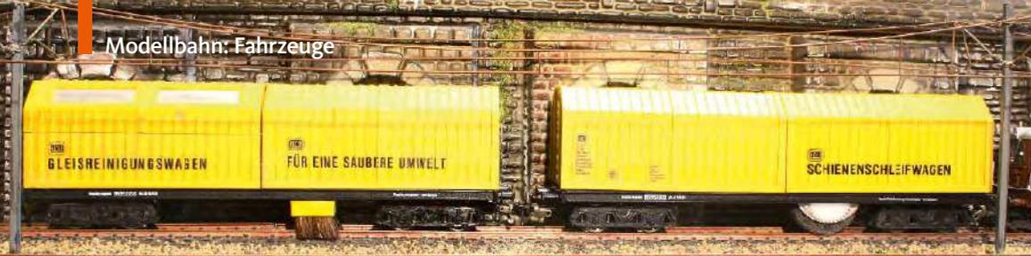
**Der Gleisreinigungswagen von Lux nimmt zuverlässig Staub auf und kann auch im Dauerbetrieb mit dem Schienenschleifwagen (rechts) eingesetzt werden**
