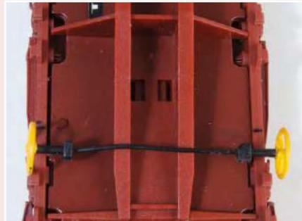
**14** ... diese mit einer beidseitig abgerundeten flachen Nadelfeile so weit auf, dass die Bremshebel hindurchpassen. Die Position der Handbremsräder (wenn nicht am Wagen vorhanden: Ersatzteil von Märklin/Trix oder Liliput) wird anhand von Vorbildfotos festgelegt; sie befindet ...
