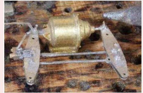
**12** ... erwiesen. Das Auflegen der Belegscheiben gelingt am einfachsten mit einem angefeuchteten Zahnstocher. Zum Einlöten des Bremszylinders bohrt man ein dem Befestigungszapfen entsprechendes Loch in den Hartholzklotz und fixiert ihn provisorisch mit Fixogum von Marabu.
