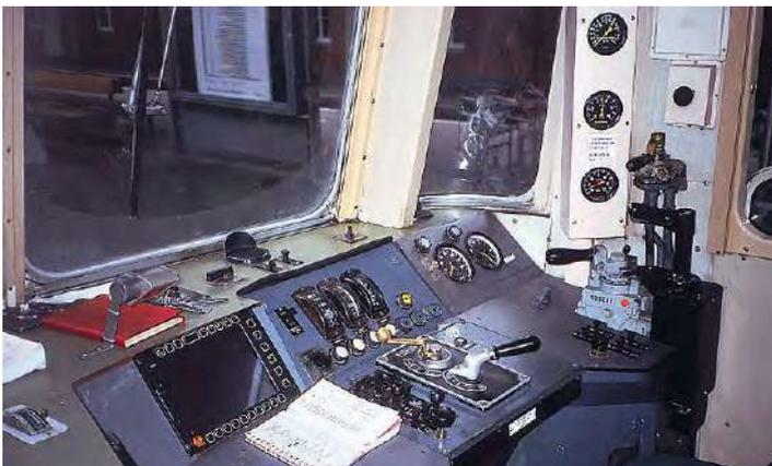
**Führerpult eines „Karlsruher Steuerwagens“; zur Bedienung von Elektro- oder Dieselloks sind in diesen Wagen unterschiedliche Pulte nötig**
