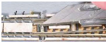
Die Kunststoffnasen der Stellschwelle und der Verbindungen zwischen den Zungen müssen abgetragen werden, da diese sonst später an der eingelegten Pflastereinlage klemmen würden
