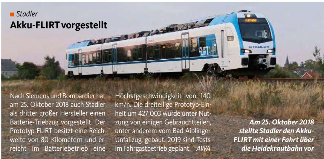
Nach Siemens und Bombardier hat am 25. Oktober 2018 auch Stadler als dritter großer Hersteller einen Batterie-Triebzug vorgestellt. Der Prototyp-FLIRT besitzt eine Reichweite von 80 Kilometern und erreicht im Batteriebetrieb eine
