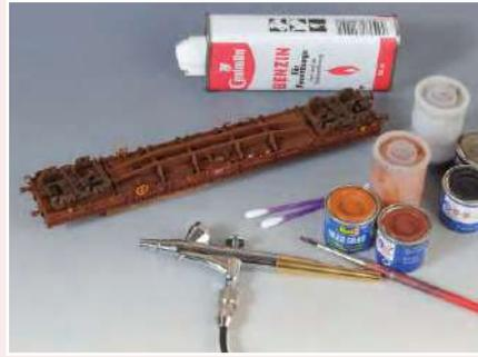
**5** Abschließend bekommt der Wagen eine vorbildgerechte Verschmutzung. Die Bremsstaub-Farbe mischt man sich aus folgenden Mattfarben zusammen: Tief-schwarz (Revell #8), Ziegelrot (Revell #37) und Orange (Revell #85). Als Verdünnung dient Feuerzeugbenzin.
