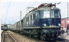
Für den schweren Schnellzugdienst lieferte AEG ab 1935 insgesamt 53 Exemplare der E 18 an die Deutsche Reichsbahn-Gesellschaft. Die mit Federtopf-Antrieb ausgerüsteten Eiloks der Achsfolge 1'Do1 bewährten sich sehr gut und kamen auch nach 1945 noch zum Einsatz; zwei weitere E 18 wurden nach Kriegsende gebaut. Während die DR nur eine kleine Zahl besaß, übernahm die DB mehr als 40 E 18, von denen die letzten bis 1984 fuhren. Im Bild T18 022 mit einem Eilzug 1974 im Bahnhof Rosenheim
