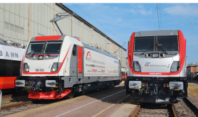
Die neueste TRAXX-Version ist die Mehrsystemvariante MS3: Im Bombardier-Werk Hennigsdorf steht am 20. September 2018 die TRAXX MS3 188 002 neben der TRAXX DC3 494 001.
