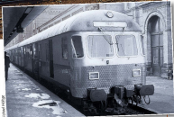
Der Wagen 50 80 82-34 042 mit Karlsruher Kopf hatte verschweisste eine automatische Mittelpufferkupplung
