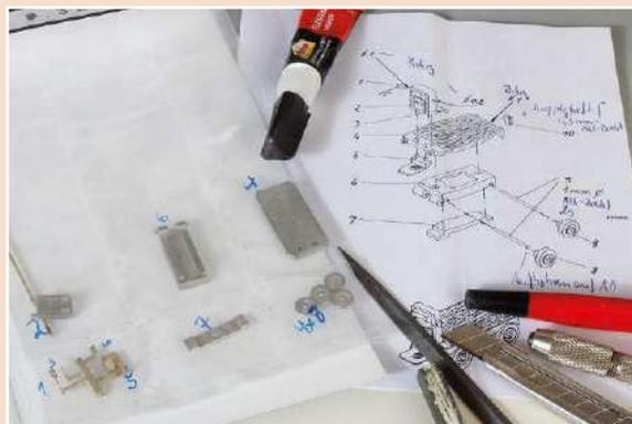
**1** Um die Übersicht beim Zusammenbau zu behalten, notiert man sich die Nummern der Bauteile mit einem feinen Permanentmarker auf die jeweiligen „Abteile“ der Verpackungsfolie.
