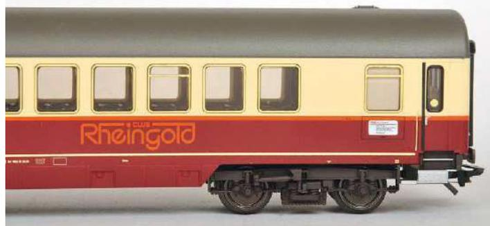
mm(s) Während es die Sitzwagen im Maßstab 1:93,5 schon länger von Märklin gibt, erscheint der Gesellschaftswagen WGmh<sup>854</sup> in TEE-Farbgebung sowie mit Drehgestellen der Bauart Minden-Deutz schwer mit Scheiben- und Magnetschienenbremse ohne Schlingerdämpfer erstmals in diesem verkürzten Längenmaßstab.
