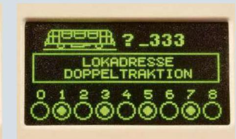
**Der Zuglok wurde eine Vorspannlokomotive mit der Adresse 333 zugeordnet**
