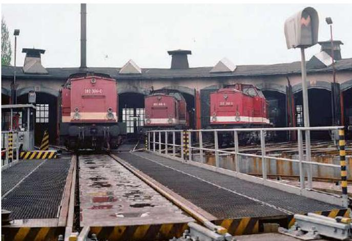
Bautzener Drehscheibe mit Leuchtmeldern für die Fahraufträge
