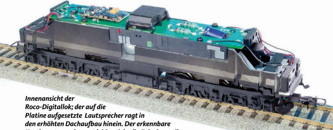
**Innenansicht der Roco-Digitallokomotive; der auf die Platine aufgesetzte Lautsprecher ragt in den erhöhten Dachaufbau hinein. Der erkennbare Kondensator verbessert leider nicht die Fahrdynamik**
