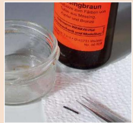
**8** ... Überstand ab und schleift dann die Achse so weit ab, dass das andere Rad ebenfalls bündig montiert werden kann. Damit die Achsen nach der Montage noch beweglich bleiben, werden sie am besten brüniert, zum Beispiel mit Messingbraun (#90909) von Fohrmann.
