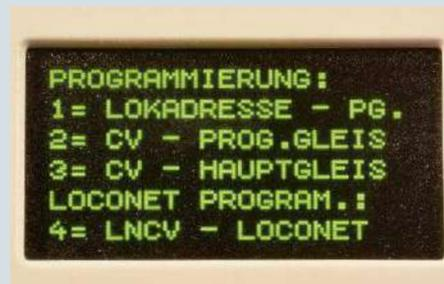
**Programmiermenu mit Decoder-Programmierung oder LNCV/LocoNet**
