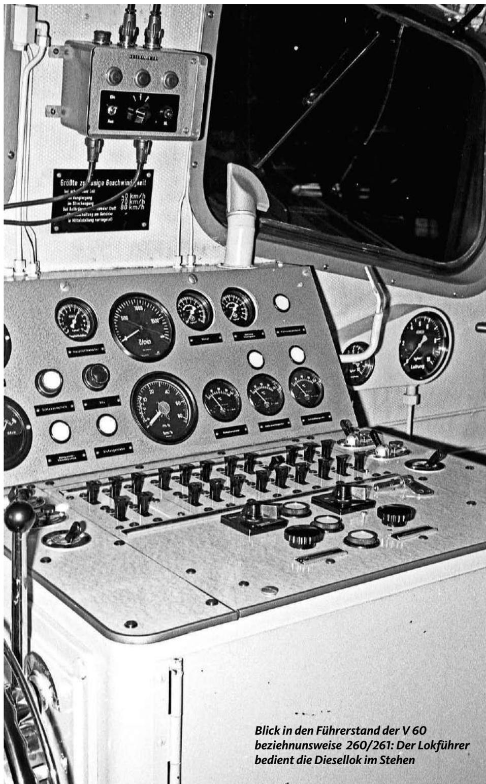
*Blick in den Führerstand der V 60 beziehungsweise 260/261: Der Lokführer bedient die Diesellok im Stehen*
