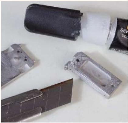
**6** Für eine bessere Kleberhaftung aller Weißmetallteile werden deren zu verklebende Flächen mittels eines Bastelmessers kreuzweise mit Riefen versehen.
