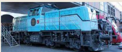
wird von der Lithium-Ionen-Traktionsbatterie abgedeckt. Die 80 km/h schnelle Lok (Anfahrzugkraft 220 kN) ist 13,3 Meter lang und wiegt 68 Tonnen.
