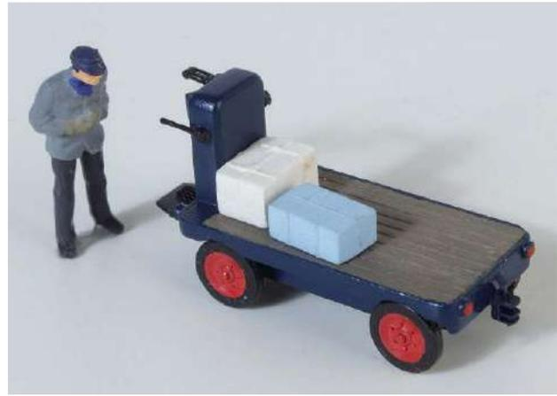
Oben: Ende der 1960er-Jahre drängten modernere Elektrokarren und -schlepper mit zeitgeistig-kantiger Frontpartie und deutlich verstärkter Leistung auf den Markt. Der EFZ 252-502 von PHB (Pohlig-Heckel-Bleichert) hat eine Zugkraft von alternativ 12 oder 20 Tonnen. Slg. OS
