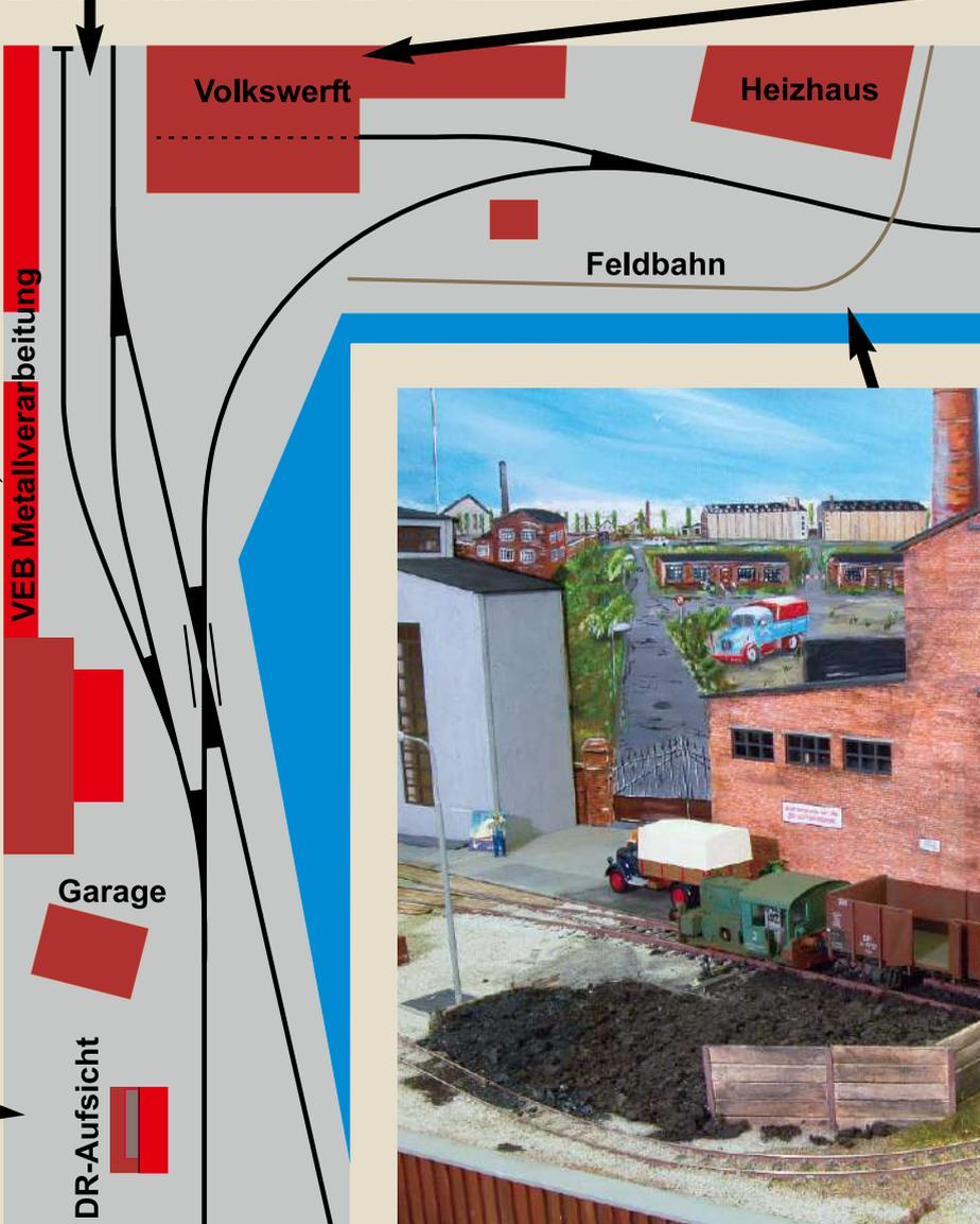
Dank des kurzen Umsetzgleises können die Güterwagen in alle Abstellgleise verschoben werden. An den Kopfstücken können Streckenstücke oder ein Fiddle yard angesetzt werden
