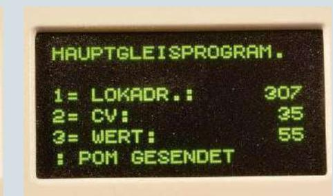
**Hauptgleisprogrammierung: Bei Lok 307 wird gerade das CV 35 auf 55 eingestellt**
