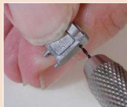
**5** Die Löcher für die Messingussteile bringt man am besten vor dem Zusammenbau entsprechend der Bauanleitung in die Bauteile ein.
