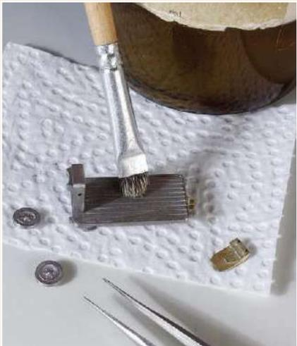
**9** Bevor man eine Lackiergrundierung auf Messing- oder Weißmetallbauteile aufträgt, sollte man diese auf jeden Fall mit Aceton entfetten. Nach dem Grundieren wird das Fahrzeug ...
