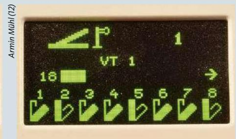
**Magnetartikel schalten ab Adresse 1, die rechts oben angegeben wird**
