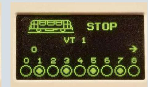
**Die Gleisspannungsabschaltung wird durch die Anzeige „STOP“ signalisiert**
