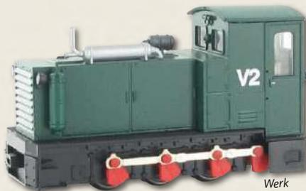
Die Diesellok V2 der Höllentalbahn ist seit zwei Jahren als HOe-Modell von Bemo verfügbar (Artikelnummer 1011 962). Der C-Kuppler mit Blindwelle basiert auf der Heeresfeldbahn-Bauart HF 130 C, von der
