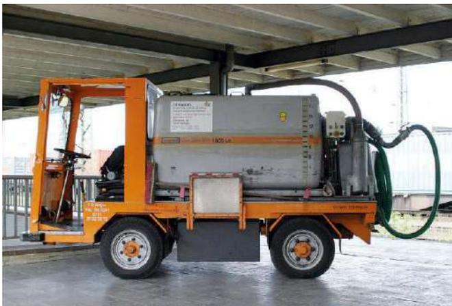
Auch heute noch kommen Elektrokarren auf den Bahnsteigen der DB zum Einsatz. Dieses moderne Gefährt dient mit seinem aufgesetzten Kunststofftank und den Schläuchen am Heck der Reinigung der Bahnanlagen. Das noch bei der DB Regio-Werkstatt in Stuttgart immatrikulierte Fahrzeug hat es im Sommer 2007 in den deutsch-niederländischen Grenzbahnhof Emmerich verschlagen. OS
