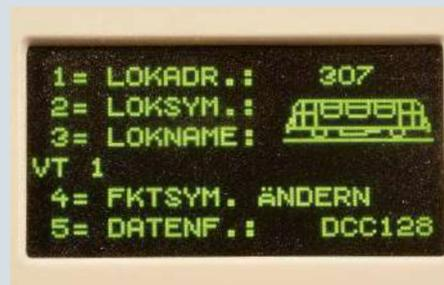
**Loksymbol, Funktionssymbole und Fahrstufenmodus werden zugewiesen**
