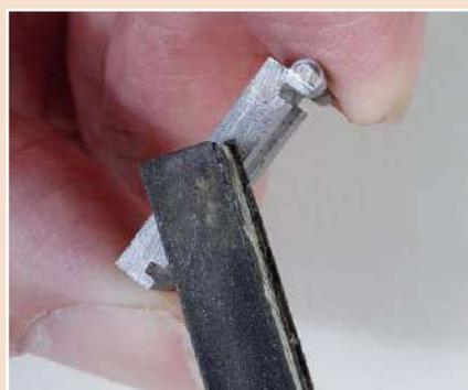
**3** ... dass man sie anschließend mit einem schmalen Schleifklötzchen, versehen mit 280er-Nassschleifpapier, wie die übrigen Oberflächen glätten kann.
