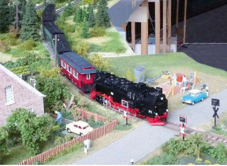
Eine Harzer Neubau-Dampflok der Baureihe 99<sup>72</sup>, montiert aus einem H0m-Bausatz von Weinert, überquert einen gesicherten Bahnübergang
