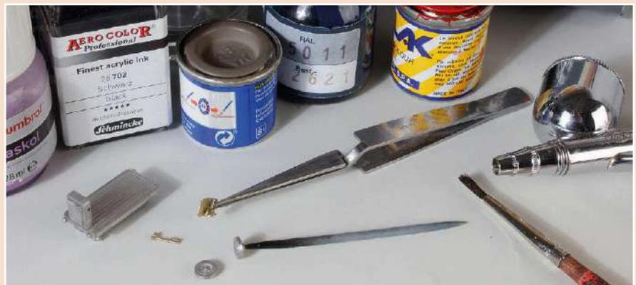
**10** ... für die Epoche IIIb mit der Airbrush stahlblau RAL 5011 (Weinert #2621) lackiert. Die Felgen färbt man karminrot RAL 3002 (Weinert #2611), die Bedienelemente und die Reifen tiefschwarz RAL 9005 (Weinert #2646). Danach erhält die Ladefläche einen holzbraunen (Revell #87) Anstrich. Zuletzt werden die Scheinwerfer silbern (Revell #90), die Bremslichter rot (Revell #330) abgesetzt.
