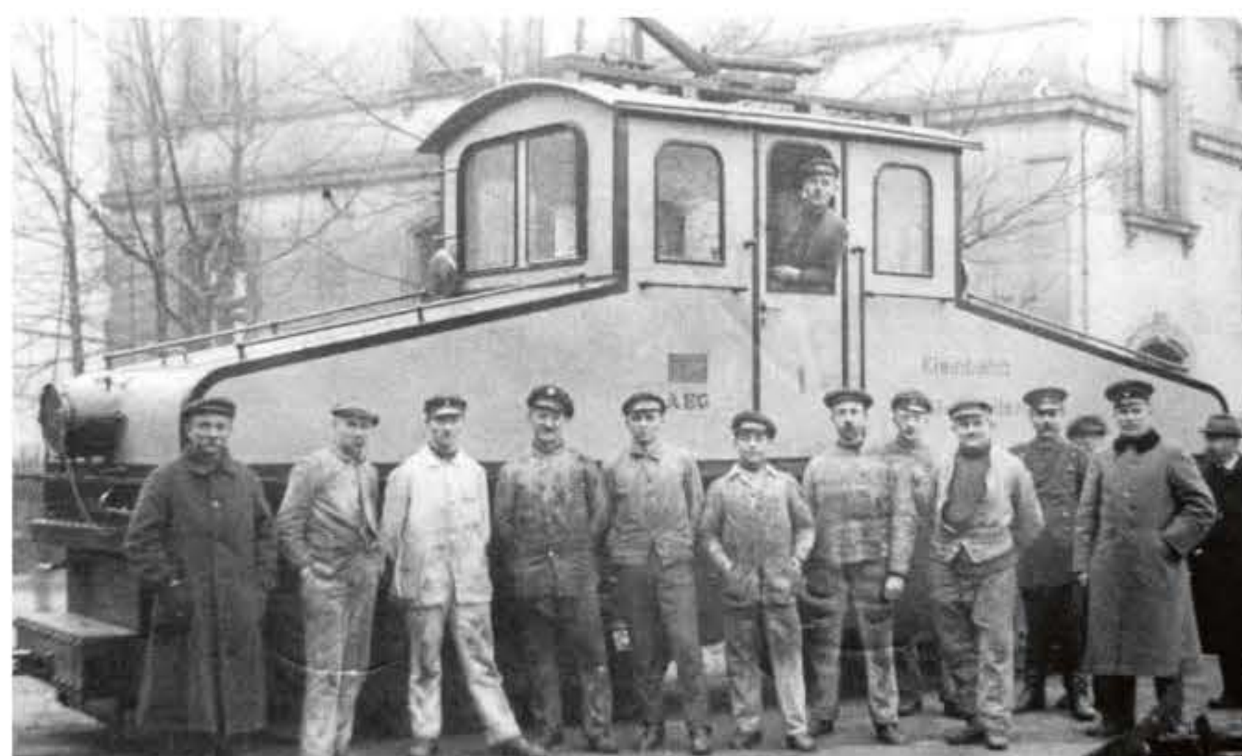
Ihre ursprüngliche Lackierung in Creme mit vermutlich grünen oder schwarzen Streifen behielt Lok 1 nicht lange, ebenso wenig den Lyrabügel. 1914 reichte der eine klobige Stirnscheinwerfer am Vorbau noch aus
