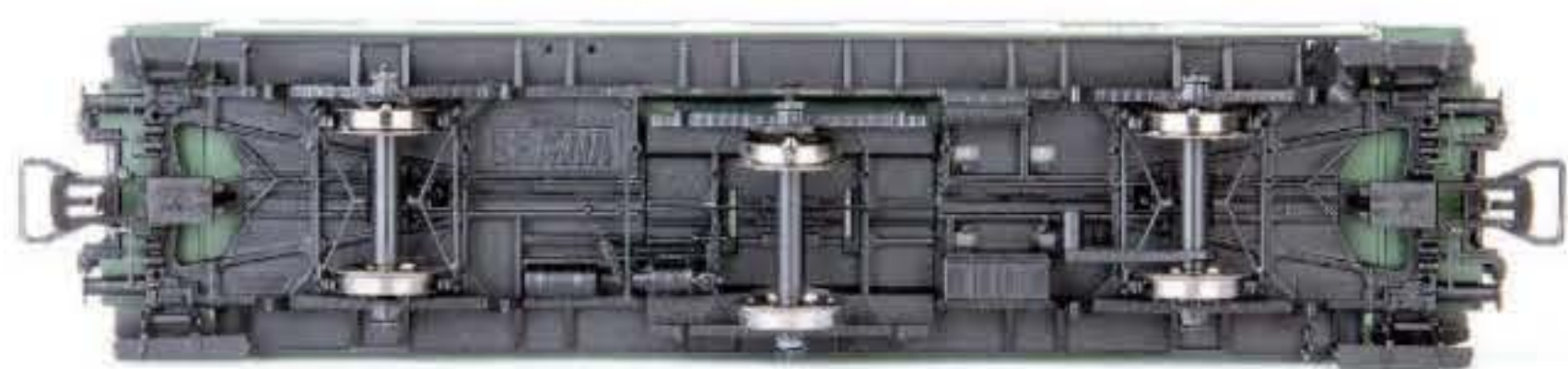
Brawa: Der mittlere Radsatz ist samt Wagenbodensegment und Außenachslagern seitenverschieblich gelagert
