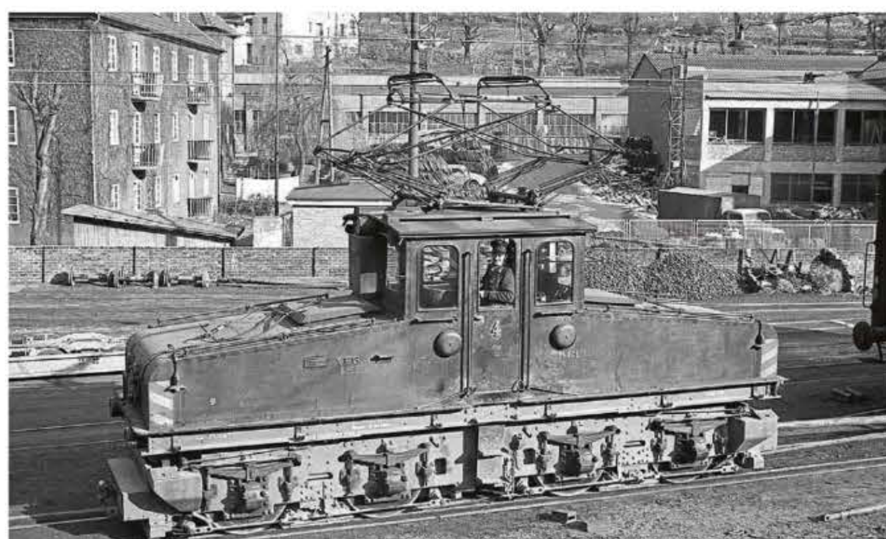
Lok 4 war die erste „Letmathe“-Serienlok. Die Vorbauten dienten als Ablage für ein Stahlseil, das beim Rangieren im Nebengleis gebraucht wurde. Die Weichenstelleisen sind am Führerhausaufstieg verstaut
