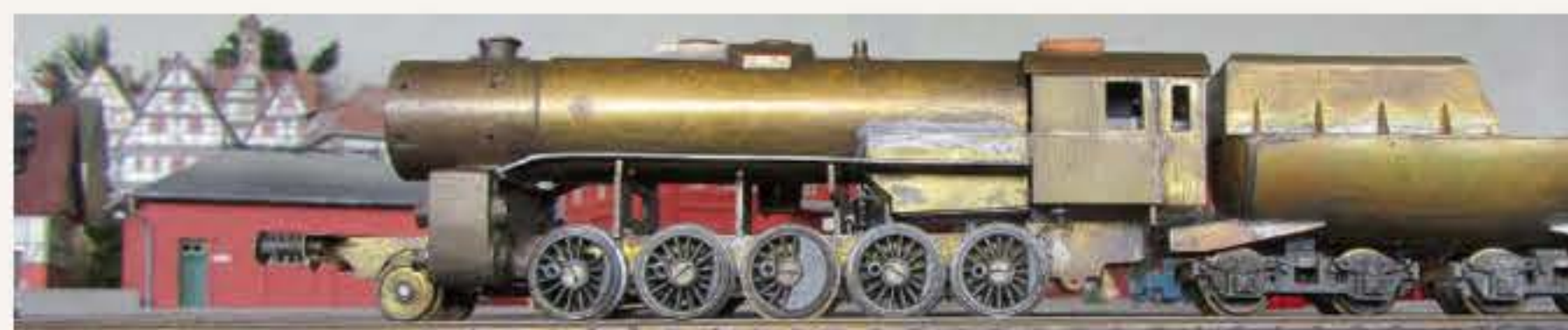
Aus Bauteilen von Eckardt und Heller nach einem alten Miba-Bauplan selbst gefertigte Baureihe 42 mit ausgetüfteltem Antriebskonzept
