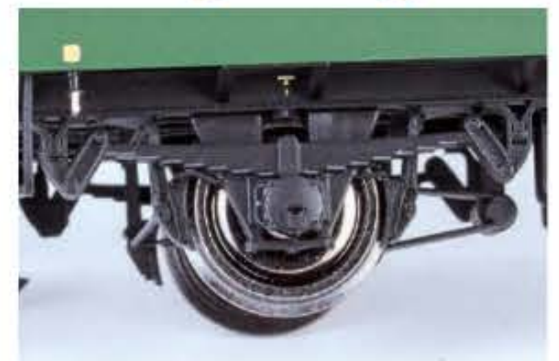
Brawa: Bremsbacken in Rad-ebene und detaillierte Rie-menlichtmaschine
