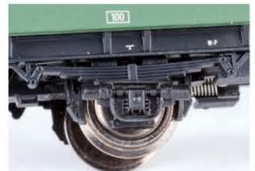
Roco: Bremsbacken in Rad-ebene und Nachbildung einer Doppellichtmaschine
