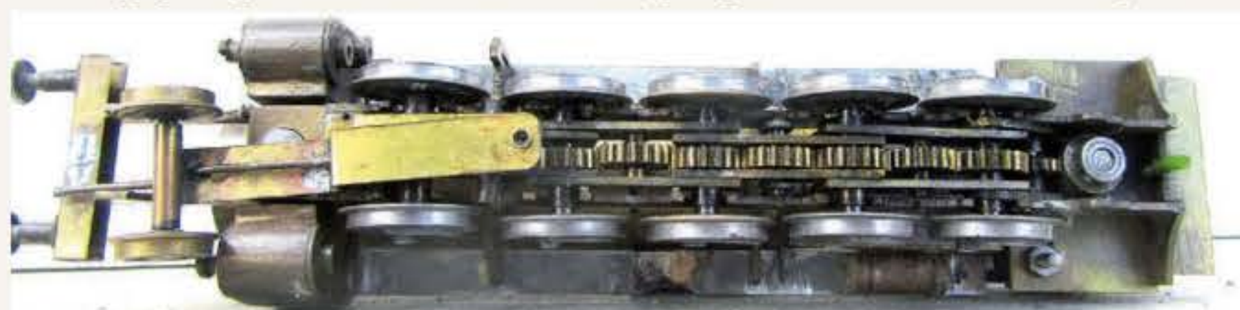
Aus Bauteilen von Eckardt und Heller nach einem alten Miba-Bauplan selbst gefertigte Baureihe 42 mit ausgetüfteltem Antriebskonzept
