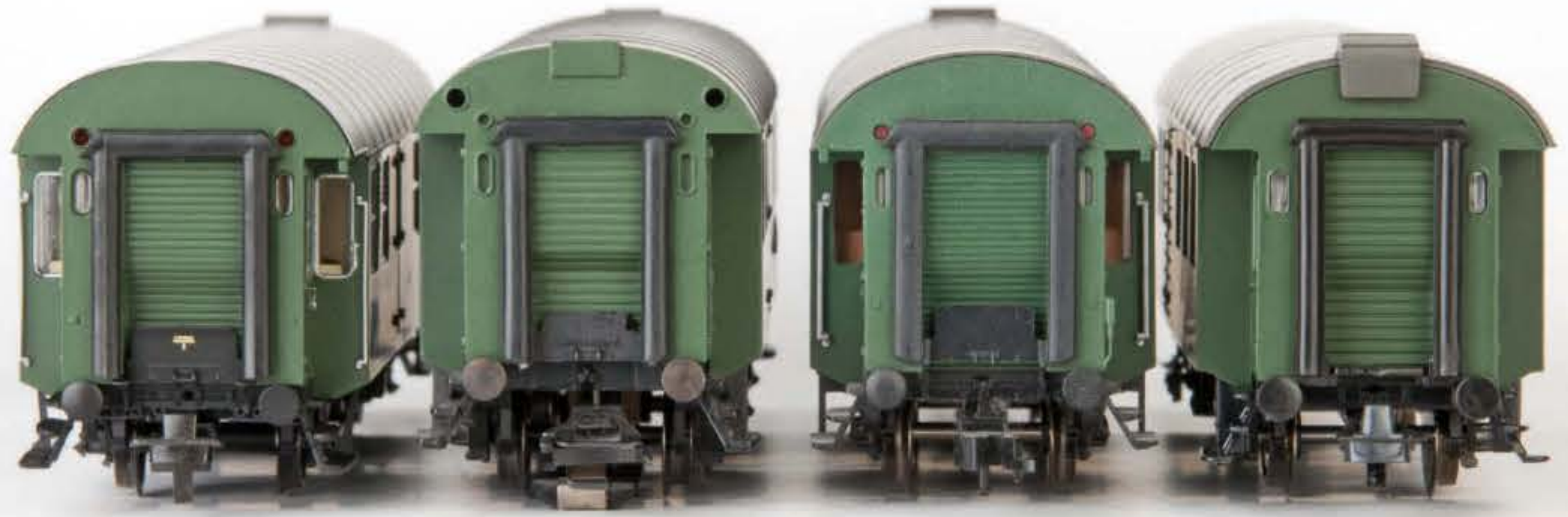
Stirnseiten der BD3yg von Brawa mit gerahmten großen Stirnfenstern (links), von Märklin mit zu hoch liegender Proportionierung und zusätzlichen Öffnungen (2.v.l.), von Fleischmann mit ungerahmten großen Stirnfenstern (3.v.l.) und von Roco mit der Pärchen-Innenstirnfront ohne Zugschlusslampen (rechts)
