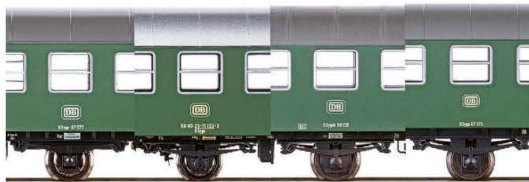
Deutliche Abweichungen gibt es bei den Höhenlagen der Wagen von Roco, Brawa, Fleischmann und Märklin (v.l.n.r.). Eine Paarbildung unter Fremdfabrikaten ist daher nur schwerlich machbar
