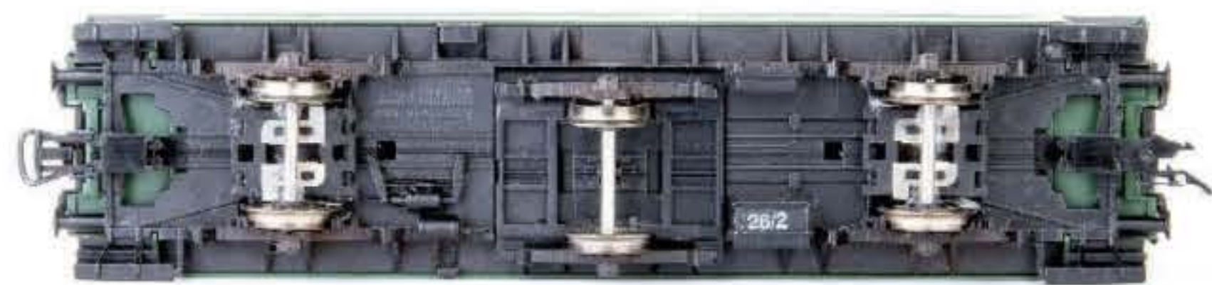
Fleischmann: Die Mittelachse ist samt Wagenbodensegment seitenverschieblich. Fürs Schlusslicht sind Radscheibenschleifer montiert
