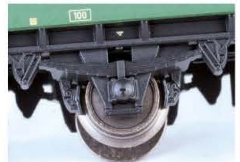
Märklin: Bremsbacken in Radebene, aber alles ein wenig gröber strukturiert
