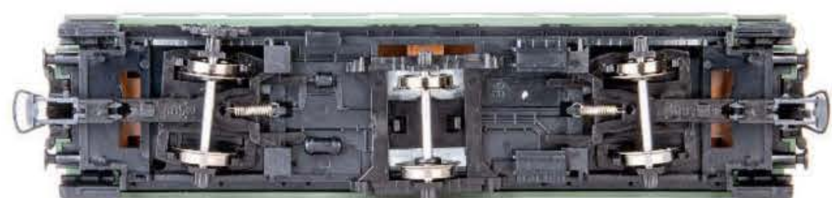
Roco: Die Mittelachse ist samt Achslagereinheit über einen breiten Spalt im Wagenboden verschiebbar, die Außenradsätze werden radial angelenkt
