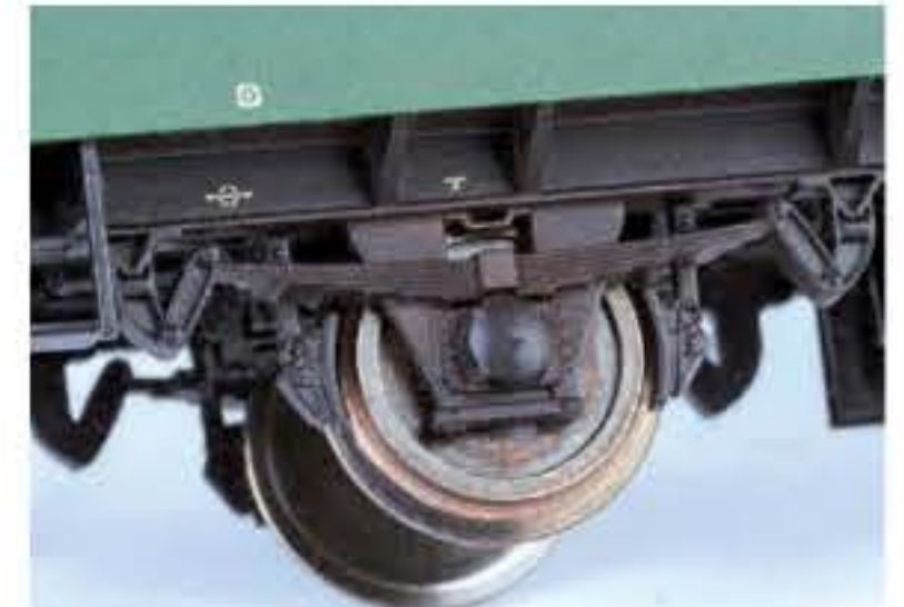
Fleischmann: Bremsbacken in Radebene an einem nach-träglich patinierten Chassis
