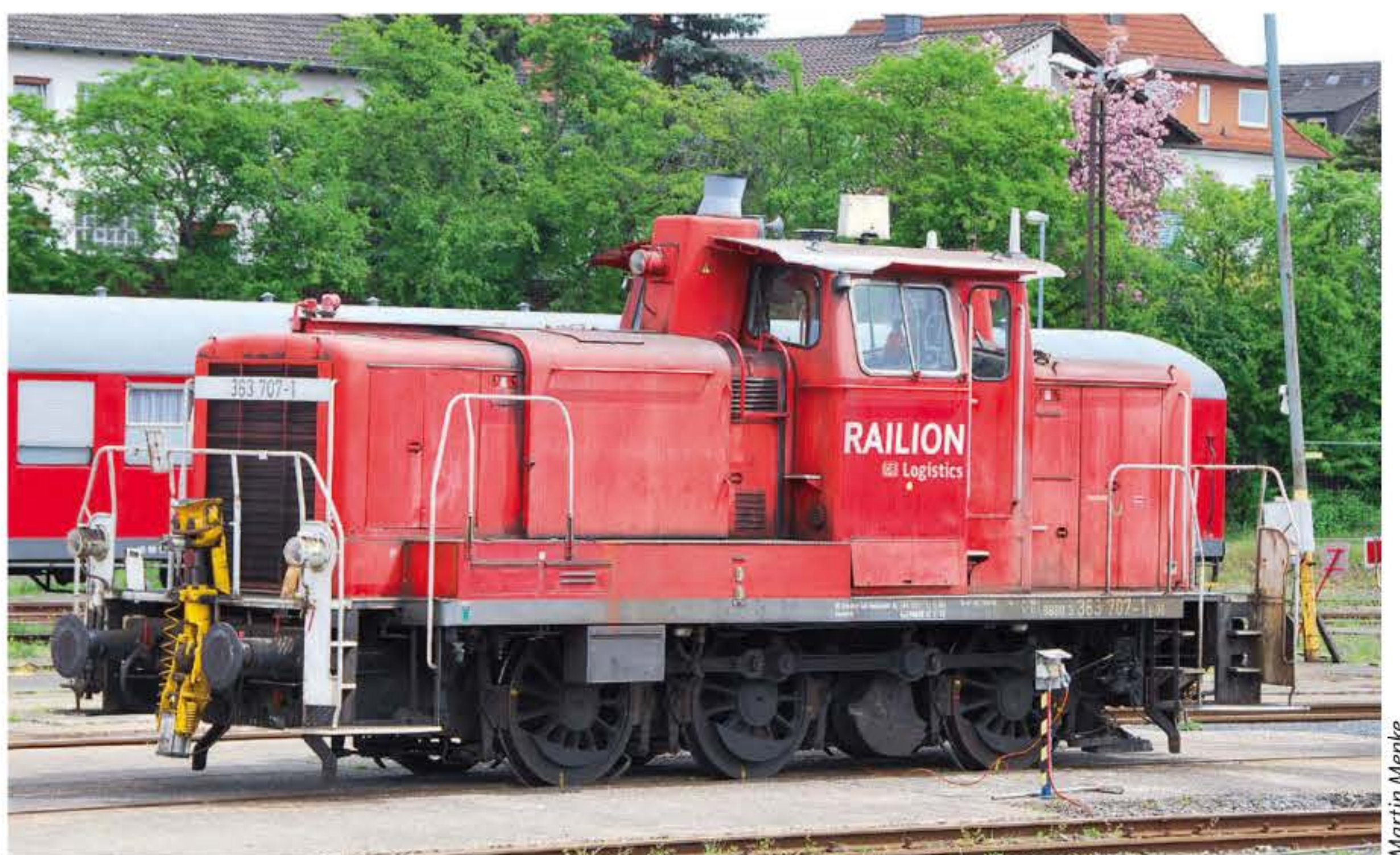
Mit Funkfernsteuerung, Rangierkupplung und neuem Caterpillar-Motor ist die im Mai 2013 im Betriebshof Fulda stionierte 363 707, eine Lok der schweren Bauart, ausgestattet
