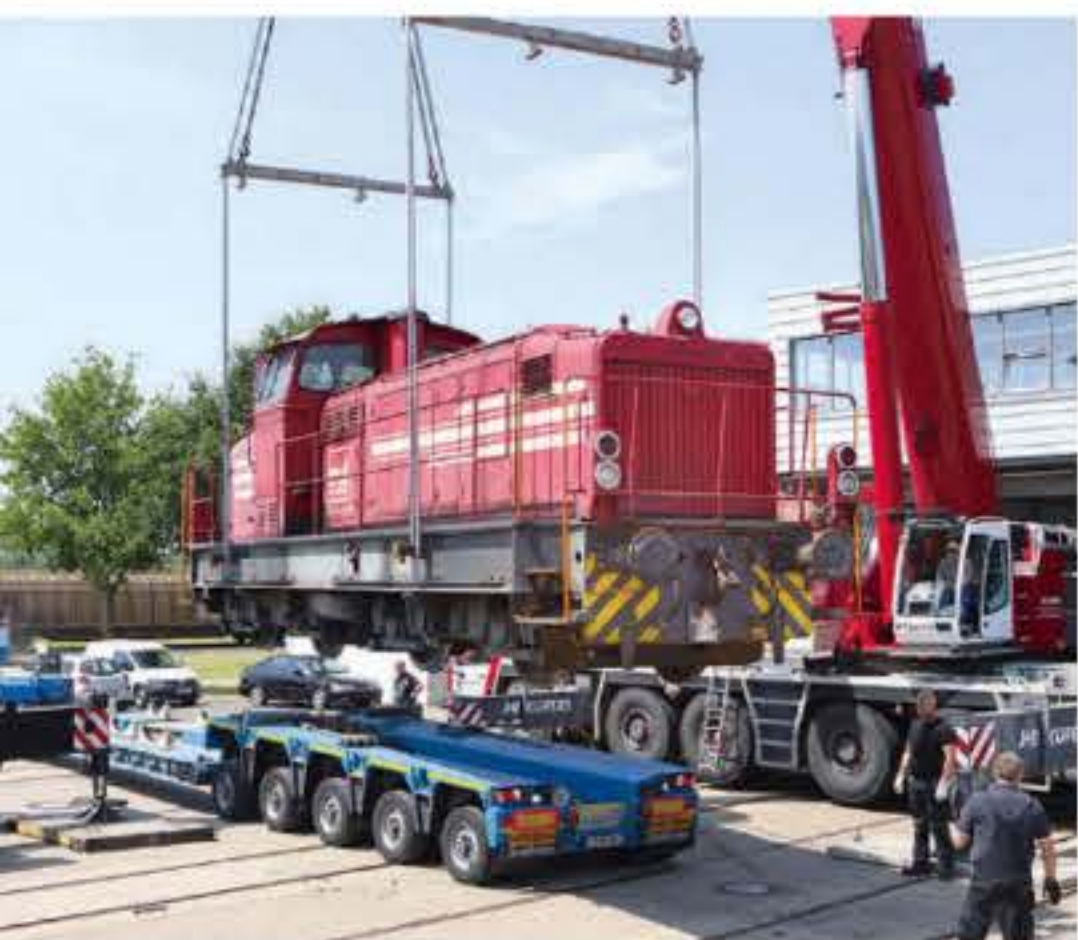
Am 4. Juli 2018 heben zwei Kräne in Nordhorn D 22 für den Transport nach Fano auf einen Tieflader Guus Ferrée
