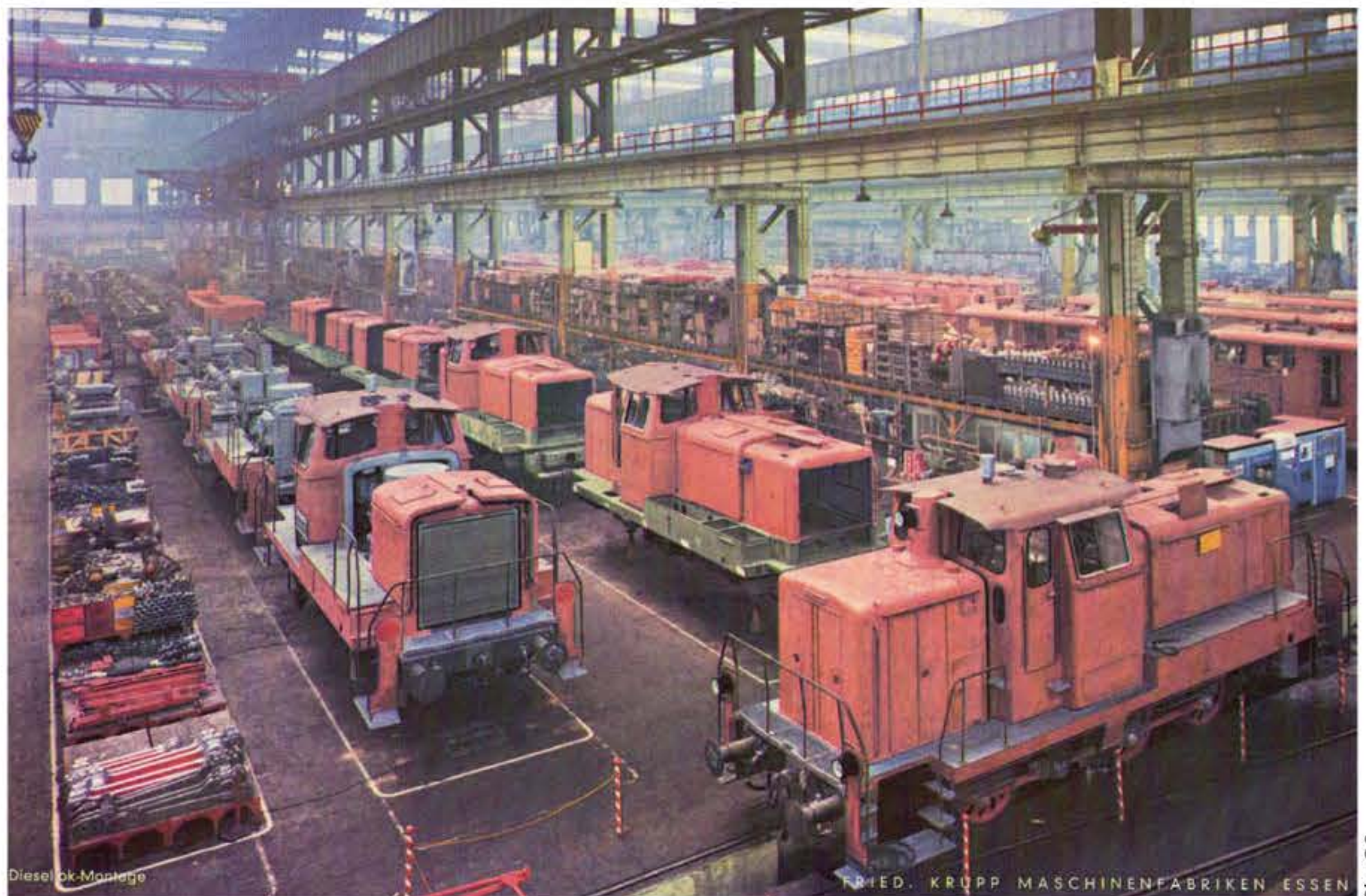
Die V 60 im Bau: Ende der 1950er-Jahre lief die Montage bei Krupp in Essen auf Hochtouren – mindestens zehn Loks sind hier in unterschiedlichen Baustadien zu sehen
