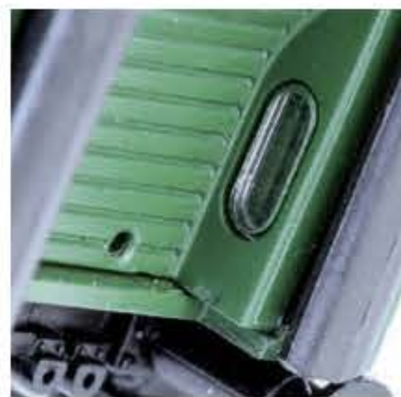
Brawa hat sogar die kleinen Seitenfenster in den Übergängen mit Scheibe und Rahmen (links) sowie die Regenabweiser und den unteren Rahmenteil des Übersetzfensters (rechts) nachgebildet
