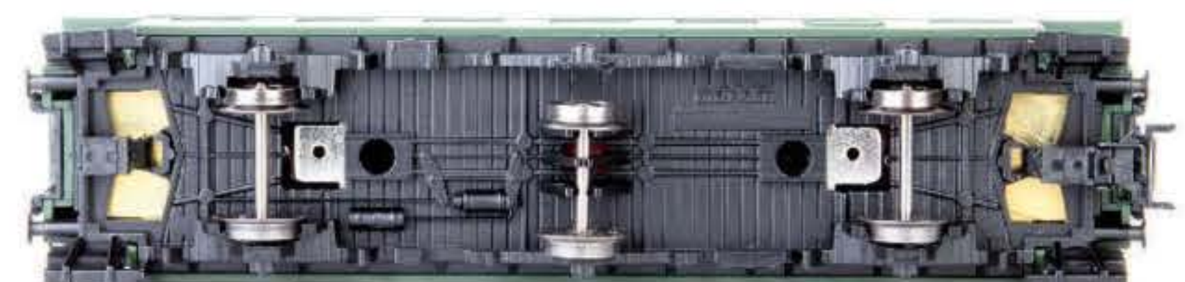
Märklin: Der mittlere Radsatz ist in seinem Innenlager seitenverschieblich mit feststehenden Achslagerattrappen gelagert
