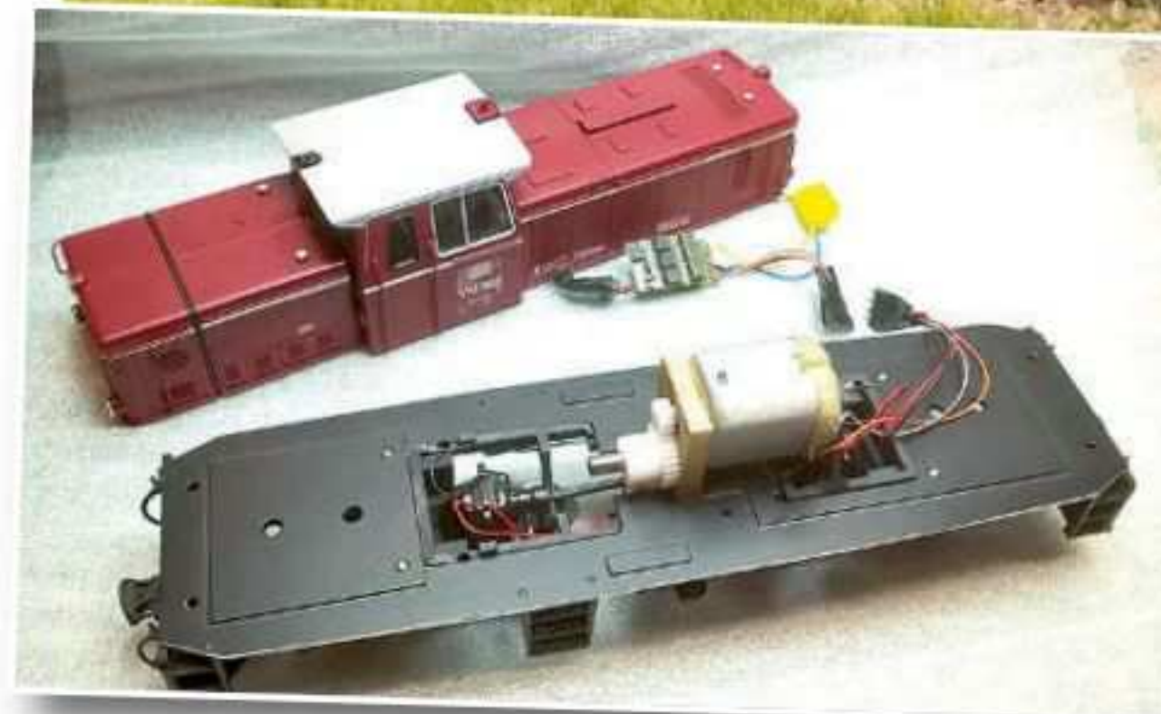
ZT Modellbahnen Oe: Diesellok der DB-Baureihe V 51 und ihre Bestandteile
