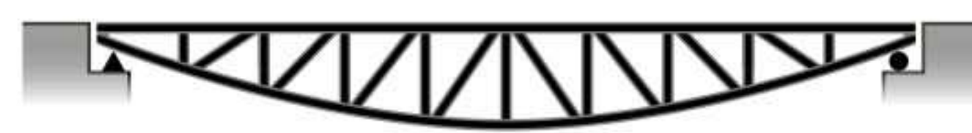
Fischbauchträger-Brücke (Fahrbahn oben)
