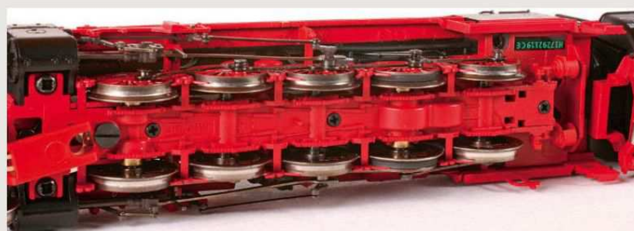
Märklin/Trix-Lok mit einem direkt übers Getriebe bewegten Radsatz
