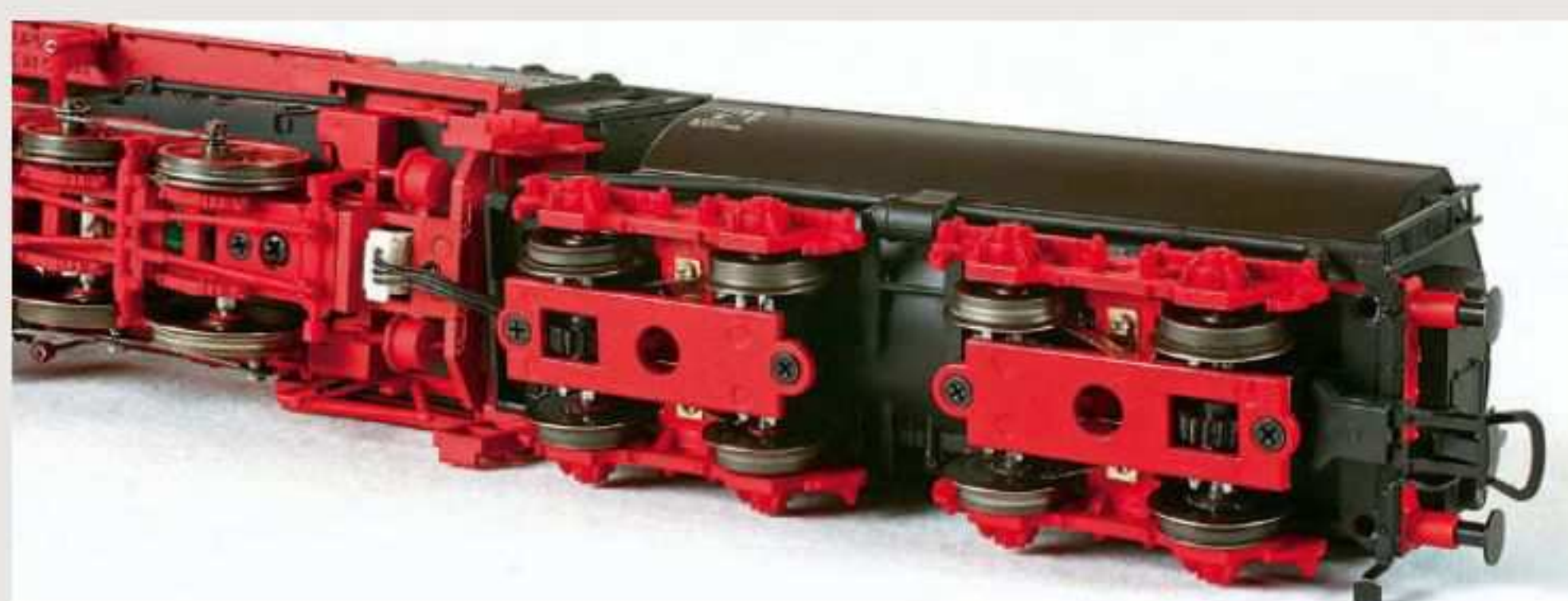
Liliput-Triebtender mit zwei Treibradsätzen und vier Haftreifen
