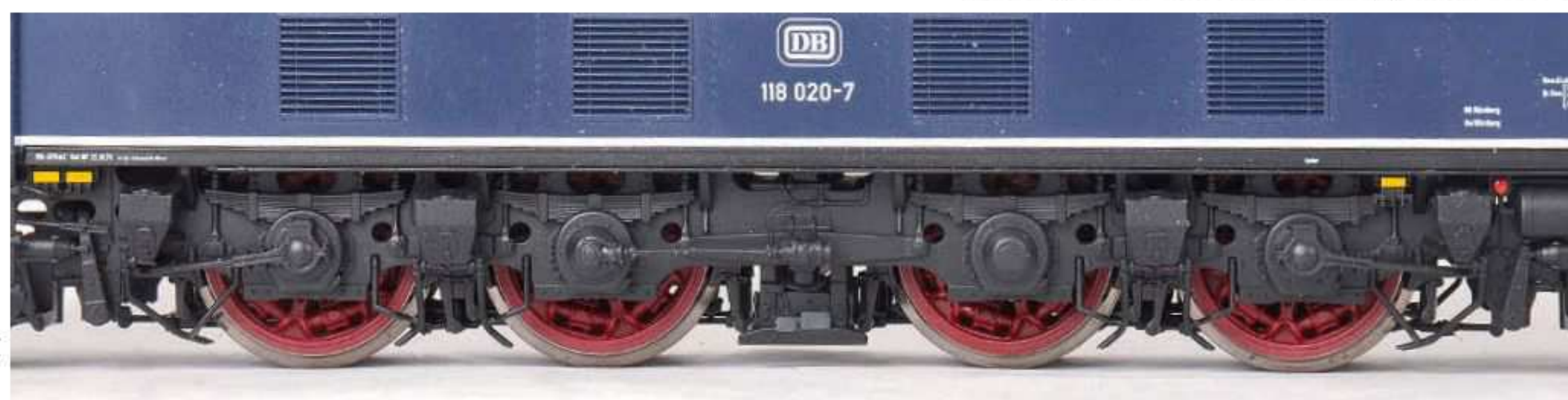
Fahrgestell mit Federtopfانtrieben
