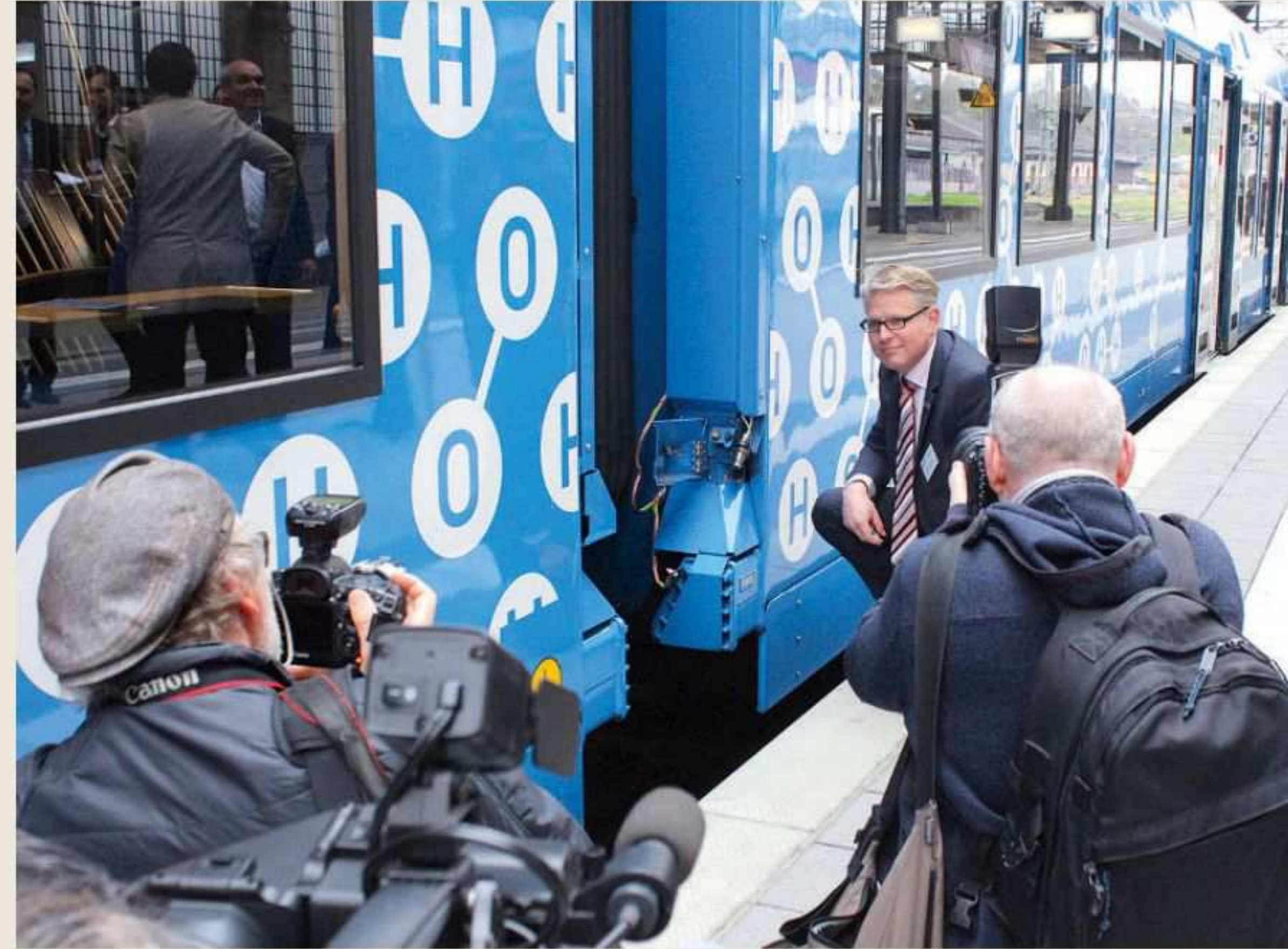
„Hier kommt der Wasserstoff ‘rein!’“ Dr. Stefan Schrank zeigt die Tanköffnung am iLINT. Die Tanks fassen 260 Kilogramm Wasserstoff – das reicht für 1.000 Kilometer Fahrt
