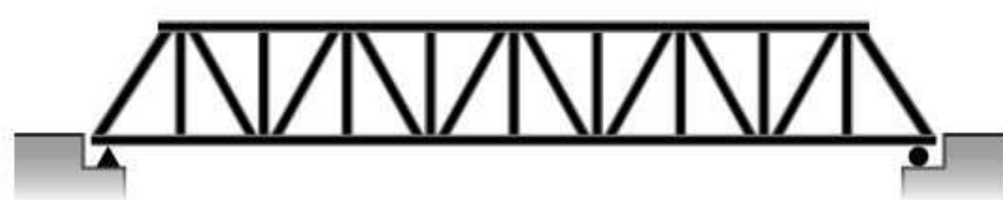
Parallele Gurte, fallende und steigende Streben
