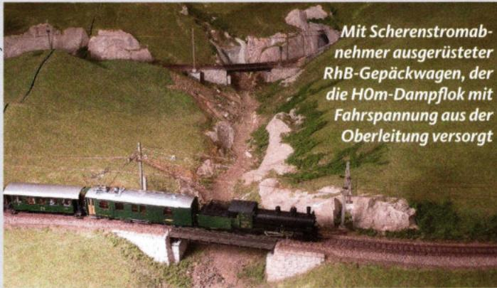
*Mit Scherenstromabnehmer ausgerüsteter RhB-Gepäckwagen, der die HOm-Dampflok mit Fahrspannung aus der Oberleitung versorgt*
