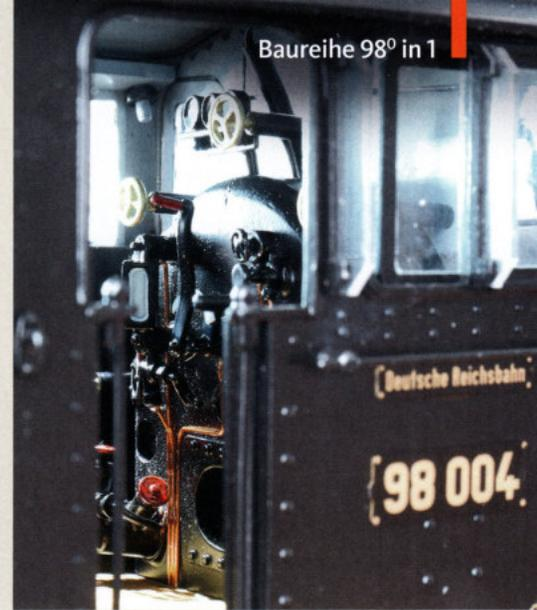
**Durch die zu öffnende Führerhaustür geht der Blick auf die mit Handrädern und Armaturen bestückte Stehkesselrückwand**
