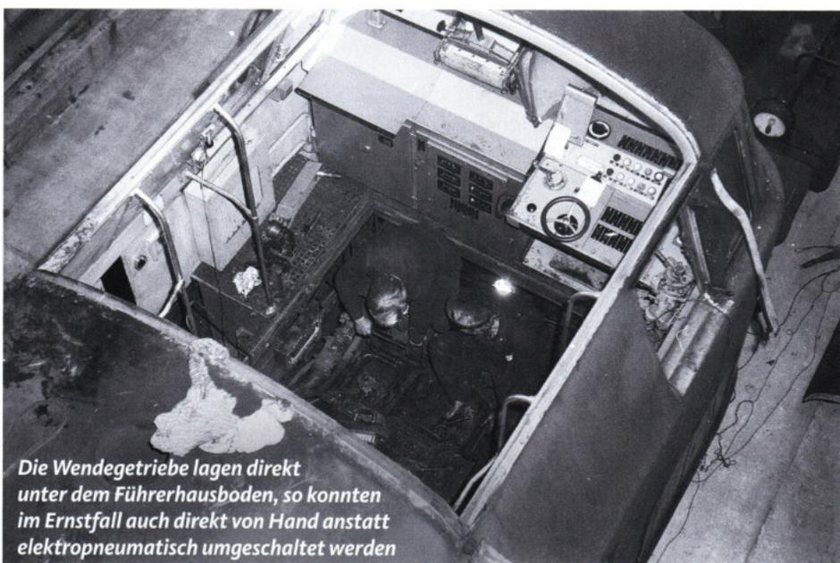
**Die Wendegetriebe lagen direkt unter dem Führerhausboden, so konnten im Ernstfall auch direkt von Hand anstatt elektropneumatisch umgeschaltet werden**
