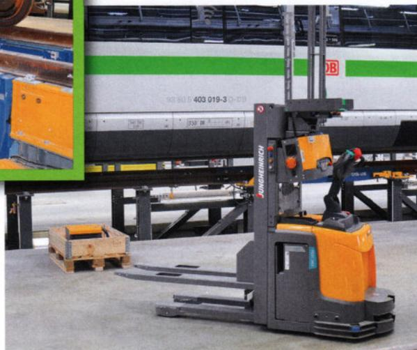
Die Flurförderfahrzeuge und Stapler bringen unbemannt die benötigten Ersatzteile vom Lager zum Einbauort
