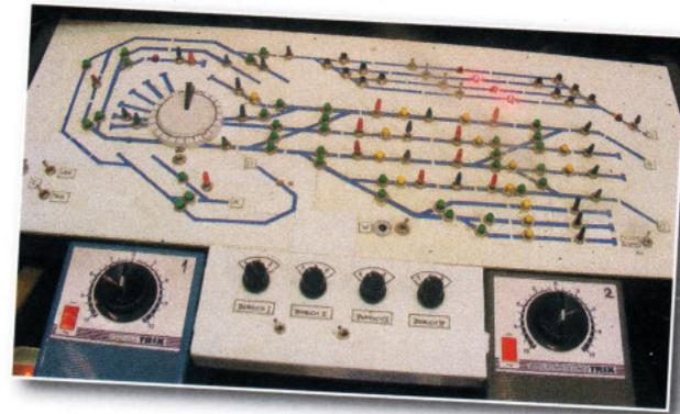
Das Gleisbildstellpult Marke Eigenbau verrät den analogen Betrieb nach dem Prinzip der bewährten Z-Schaltung; die Weichen werden über die grünen, paarig angeordneten Taster befehligt
