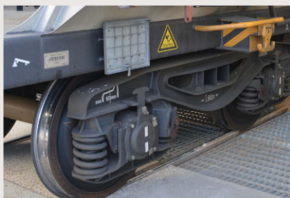
Dehgestell, hier ohne Feststellbremse, an einem Bohnhorst-Wagen
