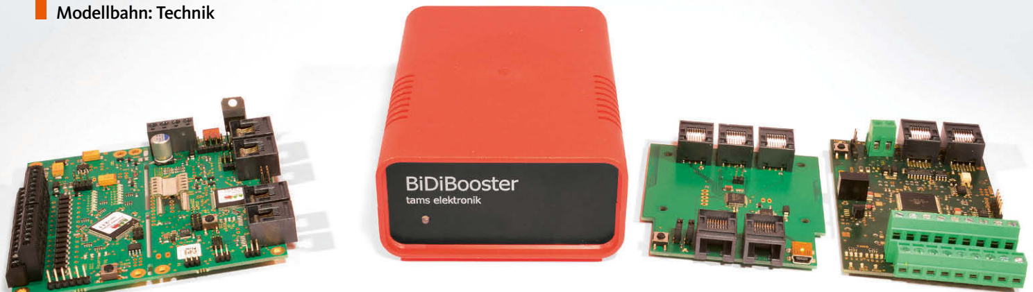
Bei Fichtelbahn sind das PC-Interface, die Gleissignalerzeugung, der Booster und ein 16-facher Besetztmelder auf einer Platine platziert (links); Tams setzt hingegen auf den modularen Aufbau mit einem Booster im Gehäuse, Interface/s88-Adapter und achtfachem Besetztmelder
