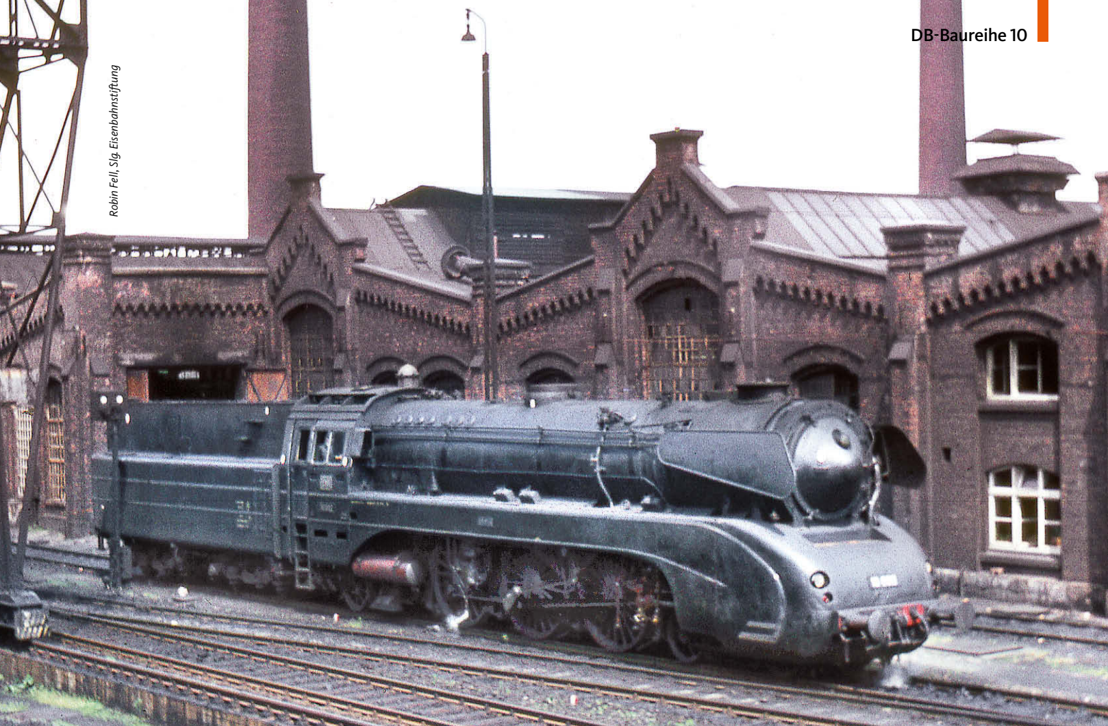
10 002 in ihrer Heimat-Dienststelle Bw Kassel am 2. Mai 1966. Deutlich sind die zwischen Kessel und Teilverkleidung untergebrachten Sandkästen zu erkennen
