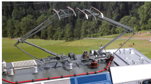
Auf diesem Foto sieht man im direkten Vergleich die Pantografen über dem Führerstand 2 für Italien (l.) und die Schweiz (r.)
