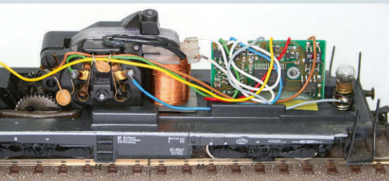
Sollen Decoderanschlüsse über Litzen in ein älteres Fahrzeugmodell eingelötet werden, muss vorher alles zur Polarität geklärt sein
