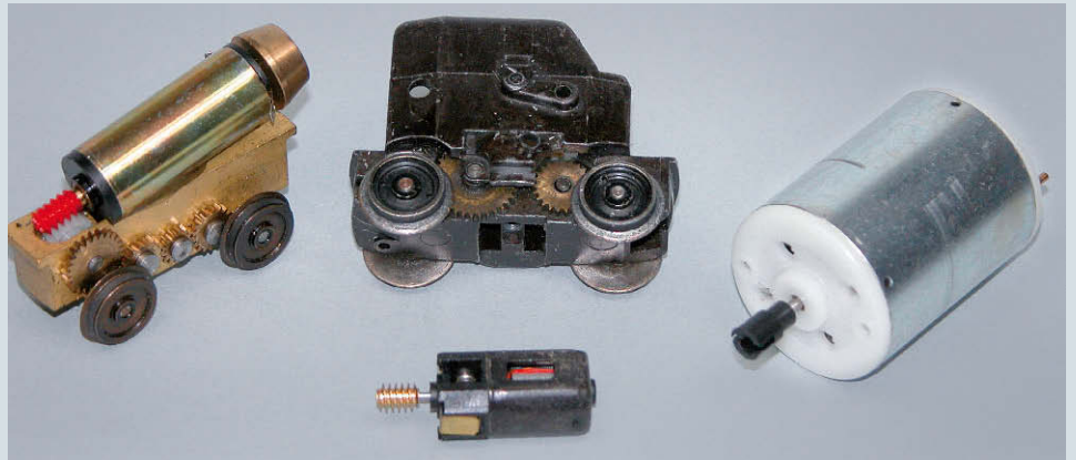
Bei der Wahl des geeigneten Triebfahrzeugdecoders muss zuerst der Strombedarf ermittelt werden, wobei besonders die leistungsunterschiedlichen Motortypen ausschlaggebend sind
