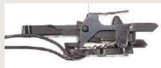
**Die neue Telex-Kupplung in einer Nahaufnahme von der Seite im zusammengezogenen Zustand der Folie mit der im Zickzack gefalteten Formgedächtnis-Legierung**
