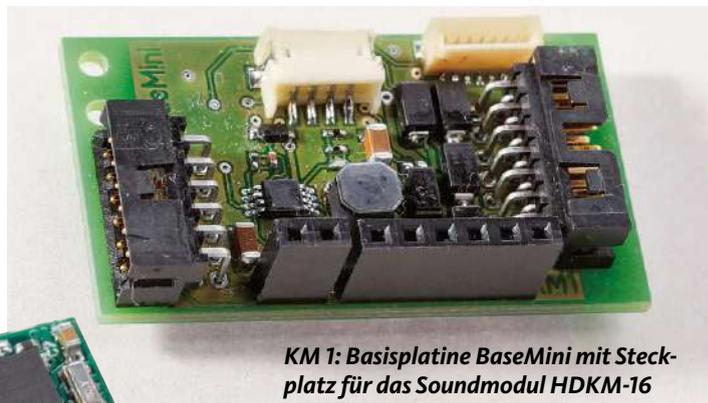
**KM 1: Basisplatine BaseMini mit Steckplatz für das Soundmodul HDKM-16**
