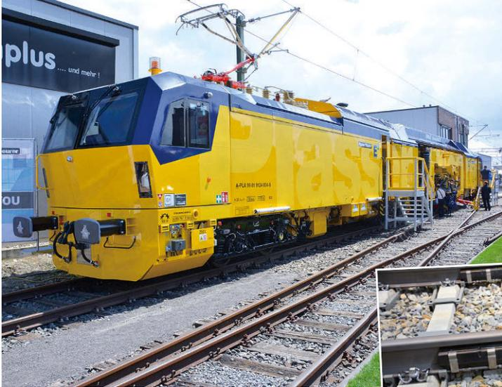
**UNIMAT 09-4x4/4S e³, so heißt die erste Stopfmaschine mit elektrischem Antrieb von Plasser und Theurer. Bisher wurden Gleisbaumaschinen für Vollbahnen im Regelfall mit Dieselantrieb gebaut**
