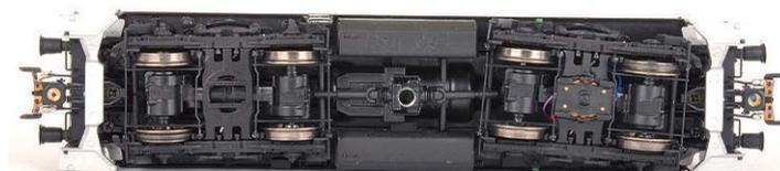
**Drehgestelle mit Skischleifer-Aufnahme und digitalen Kupplungen**
