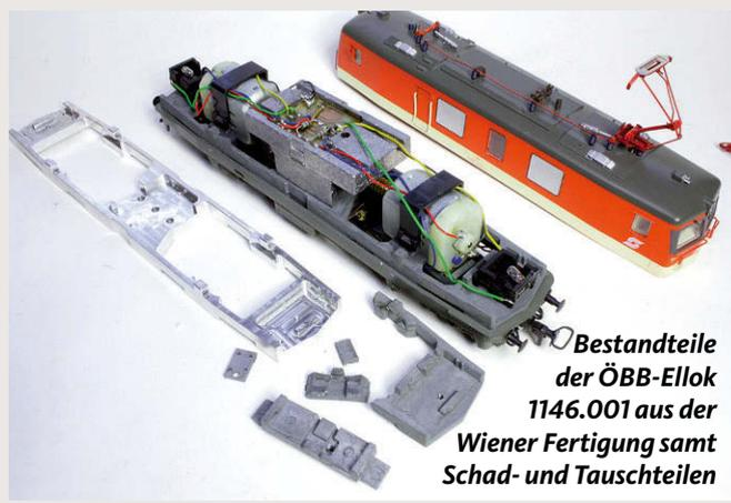
*Bestandteile der ÖBB-Ellok 1146.001 aus der Wiener Fertigung samt Schad- und Tauschteilen*
