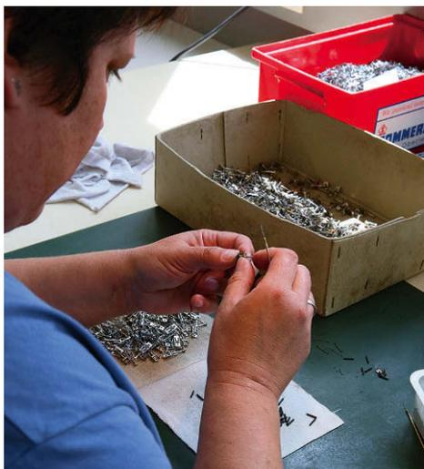
Bei der Montage eines Einholmstromabnehmers für Elloks ist beim Einhängen der winzigen Hebefeder viel Geduld gefragt
