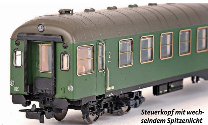
**Steuerkopf mit wechselndem Spitzenlicht**
