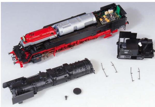
Das Innere der Roco-Lok nach Abnahme von Führerhaus und Kessel: vorn rot lackiert der Dampfgenerator mit Destillat-Reservoir, dahinter der Ballastblock, unter dem sich der Motor verbirgt, und im Führerhaus der Sounddecoder
