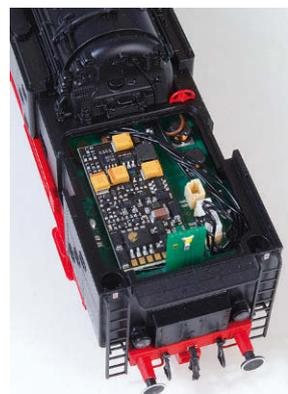
Auch wenn der Decoder Führerhaus und Kohlenkasten füllt, konnte der Stehkessel detailliert werden
