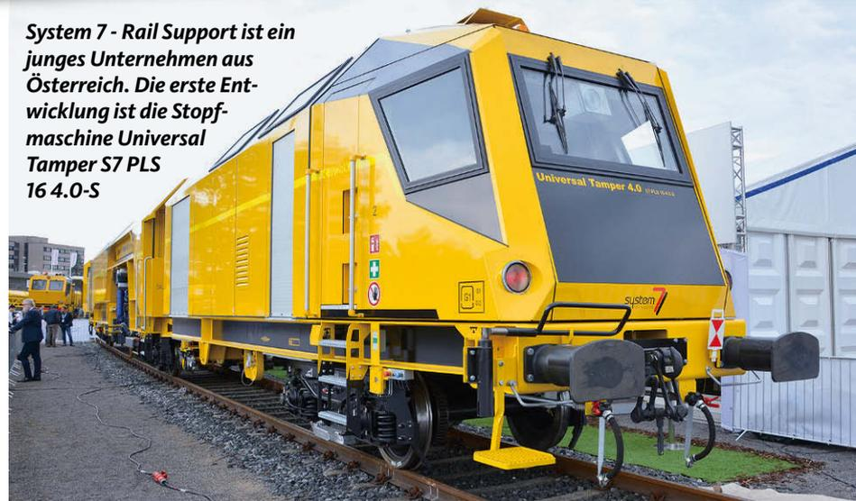
ckel und kann auch für Weichen eingesetzt werden. Das Stopfaggregat nutzt elektrisch angetriebene Stopfpickel.
