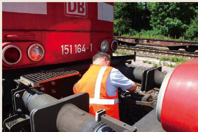
Uwe Schröder kuppelt die beiden Schiebeloks samt der Luftleitungen für die Erzzug-Leistung. Auf die Vielfachsteuerung verzichtet er ...
