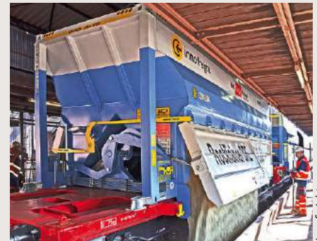
Schwerkraftentladung: RockTainer-Ore-Waggons auf dem Entlade-Sturzgleis im Stahlwerk Donawitz. Die Entladeklappen werden pneumatisch betätigt
