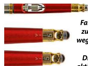
Der Blick auf den Luftkopf dieser Lackierpistole mit seinen seitlichen Luftkanälen (MSB – Enghorndüse) zeigt, dass sie hinsichtlich des Sprühstrahls ganz anderen Anforderungen genügen muss als ein Airbrush
