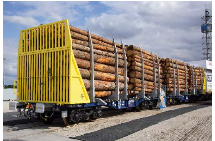
Der Sggrs 80 von Tatravagonka wurde mit Innofreight-„Holzpaletten“ ausgestattet, die aufgrund ihrer Größe für die Lichtraumprofilverhältnisse z.B. in Schweden geeignet sind
