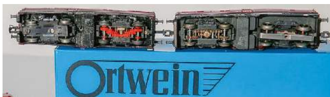
V 80 mit technischen Unterschieden, die große Wirkung hervorriefen: links das plamo/Tesmo-Getriebe, rechts das Metallzahnrad-Getriebe des Heinzl-Umbaus
