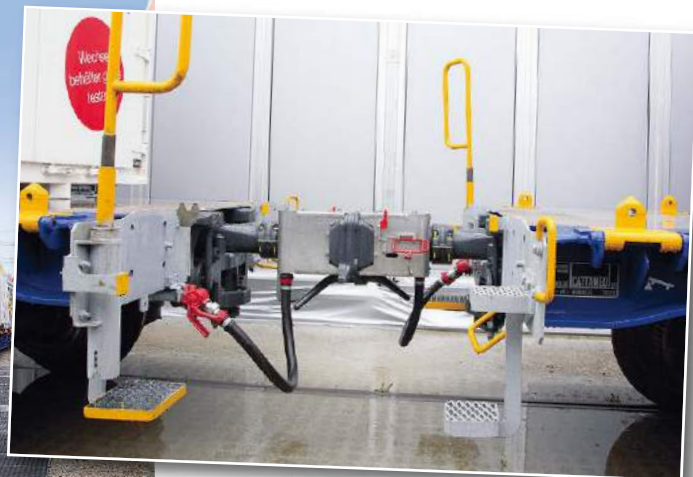
Die „5L“-Tragwagen der SBB Cargo weisen viele neue Details auf wie z.B. eine automatische Kupplung (AK) für Güterwagen, hier die Schaku-Bauart von Voith
