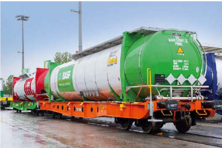
Die Wascosa-Tragwagen von Tatravagonka mit je einem 45- bzw. 52-Fuß-Tankcontainer von Van Hool für die BASF können den Einzelwagenverkehr mit Kesselwagen ersetzen
