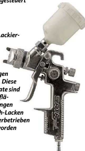
Bedienungshebel mit unabhängiger Doppelfunktion (independent double-action): Durch Niederdrücken des Hebels wird die Luft freigegeben, durch das Zurückziehen der Farbfluss gesteuert
