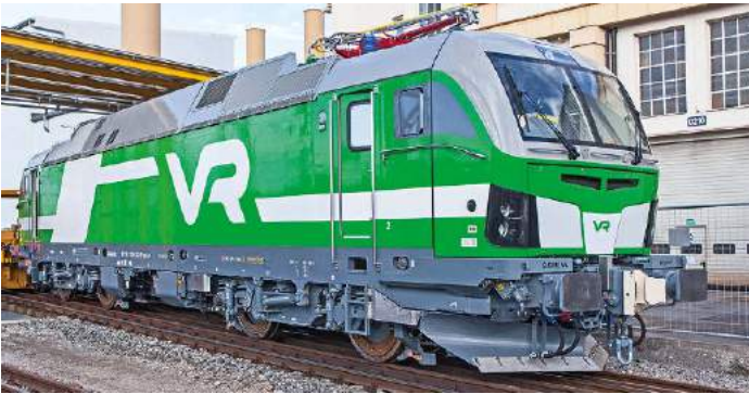
Finnische 25-kV-Breitspurlok VR-Sr3 3302 mit 360-kW-Dieselhilfsantrieb am 9. November 2015 in München-Allach; in der russischen Mittelpufferkupplung SA3 steckt ein Gemischtkuppeleinsatz
