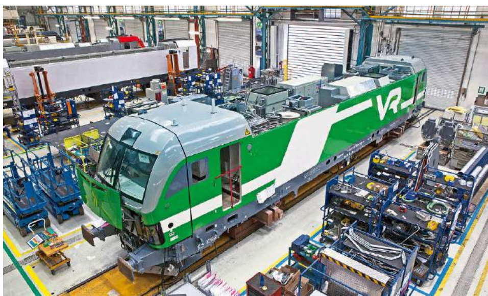
Montage des „Vectron“ in München-Allach am 20. November 2015; die breitspurige Sr3-3303 für Finnland zeigt erkennbar die identischen Kastenmaße wie die Standardloks im Hintergrund
