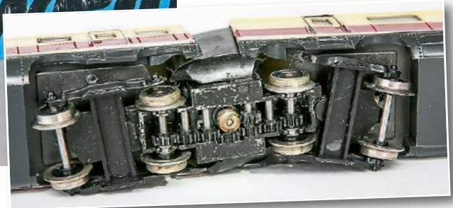
Ortwein-Triebzugvarianten des 601 (von vorn): InterCity mit Versuchsgehäuse (Vorserie), TEE „Helvetia“ sowie die No-name-Version, die meist mit Schildern zum Selbstanbau geliefert wurde; das kleine Bild zeigt das Drehgestellgetriebe mit Kunststoff-Zahnradern
