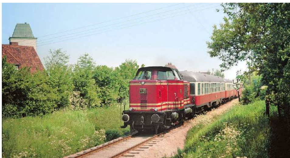
Höchstgeschwindigkeit 30 km/h, Läuten und Pfeifen – die schräg stehende Signaltafel hatte der Lokführer der 1958 gebauten und 800 PS starken V 82 bei Schönberg gerade passiert
