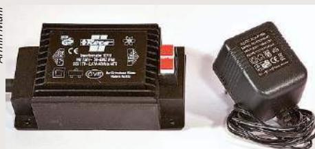
Links ein klassischer Zubehörtrafo von Roco, rechts ein typisches Steckernetzteil, wie es einem Decoder-Programmiergerät von ESU beiliegt
