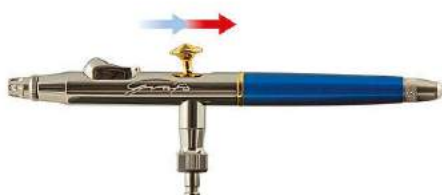
Airbrush mit einem Bedienhebel, der eine gekoppelte Doppelfunktion (fixed double-action) ausübt: Durch Zurückziehen des Hebels wird erst die Luft freigegeben und dann die Farbmenge dosiert
