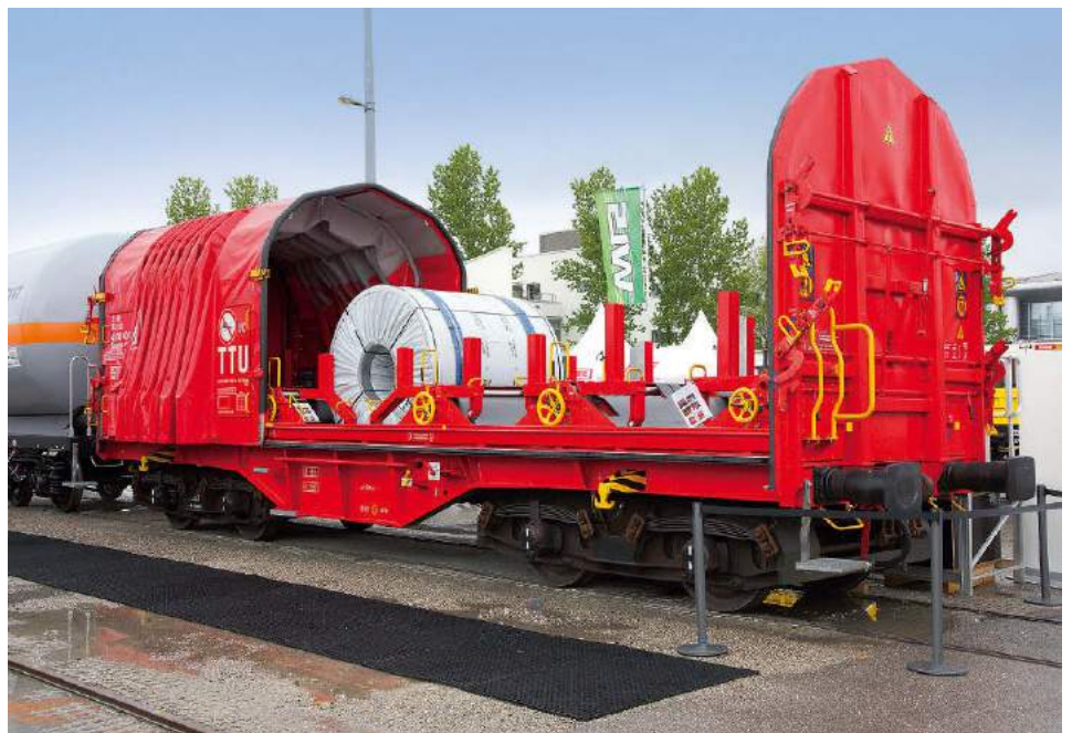
Prototyp mit Sensorik und Einmannbedienung: der Shimmns-ttu von DB Cargo
