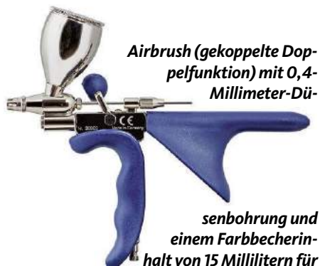
Airbrush mit einem Bedienhebel, der eine gekoppelte Doppelfunktion (fixed double-action) ausübt: Durch Zurückziehen des Hebels wird erst die Luft freigegeben und dann die Farbmenge dosiert
