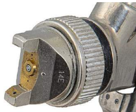
Der Blick auf den Luftkopf dieser Lackierpistole mit seinen seitlichen Luftkanälen (MSB – Enghorndüse) zeigt, dass sie hinsichtlich des Sprühstrahls ganz anderen Anforderungen genügen muss als ein Airbrush
