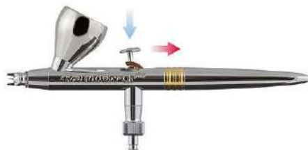
Bedienungshebel mit unabhängiger Doppelfunktion (independent double-action): Durch Niederdrücken des Hebels wird die Luft freigegeben, durch das Zurückziehen der Farbfluss gesteuert
