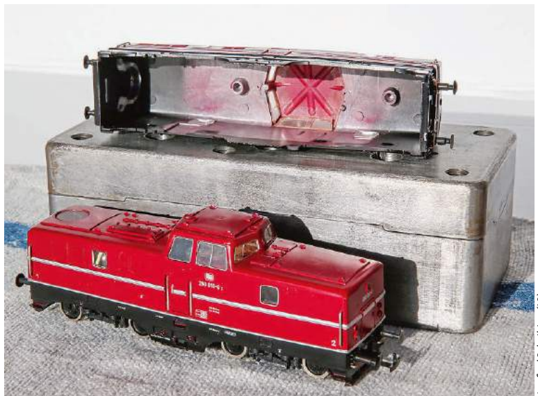
Spritzgussform und Lokgehäuse der Ortwein-280 010; es war nicht mehr mit dem Chassis verschraubt, sondern wurde auf den Rahmen aufgeklippt
