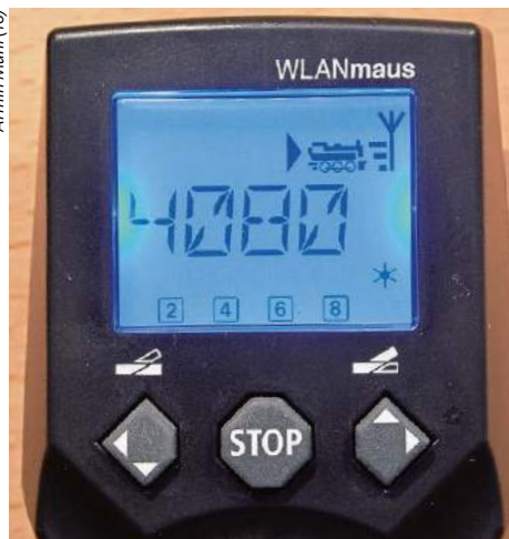
Die Lokadresse 4080 wurde im Lokadressen-Modus eingegeben. Die Lok fährt vorwärts, und es sind die Funktionen F0, F2, F4, F6, F8 eingeschaltet. Das Antennensymbol zeigt mit drei Balken das volle Empfangssignal an
