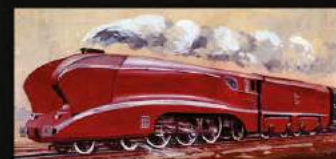
H0-011/2-P.O. MIDI 231-726 Stromliniendampflokomotive in roter Farbgebung, Bauzustand 1937
