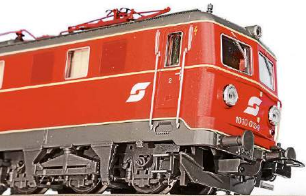
Drehgestell mit der tiefreichenden Stützkonstruktion für das „Andreaskreuz“
