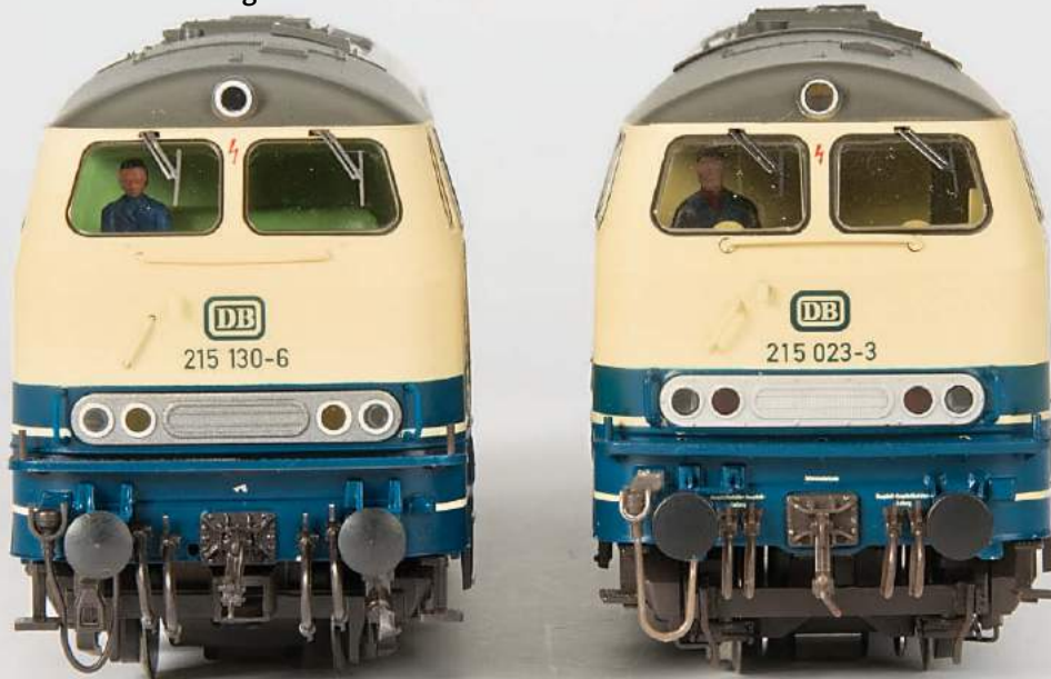
Der Frontvergleich zeigt, dass beide Hersteller die Lok gut getroffen haben. Optisch vorteilhafter ist beim ESU-Modell (rechts) der demontierte Normschacht, der für mehr Vorbildtreue sorgt
