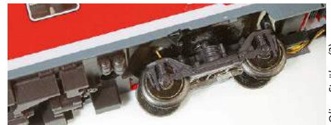
Piko-Drehgestell mit angesetzten Bauteilen der Neigetechnik und feinen Sandfallrohren (links) und im Vergleich das Schraubenfeder-Drehgestell des Fleischmann/Märklin-Zuges
