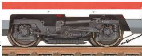
Piko-Drehgestell mit angesetzten Bauteilen der Neigetechnik und feinen Sandfallrohren (links) und im Vergleich das Schraubenfeder-Drehgestell des Fleischmann/Märklin-Zuges
