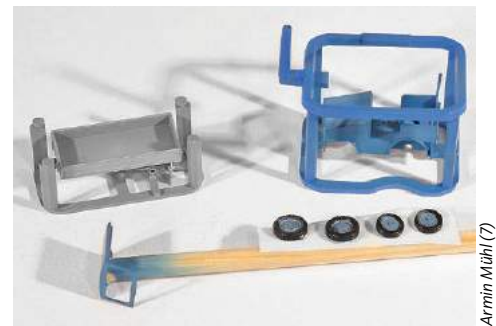
Die Teile von Schlepper und Anhänger wurden gleich am Spritzling umlackiert
