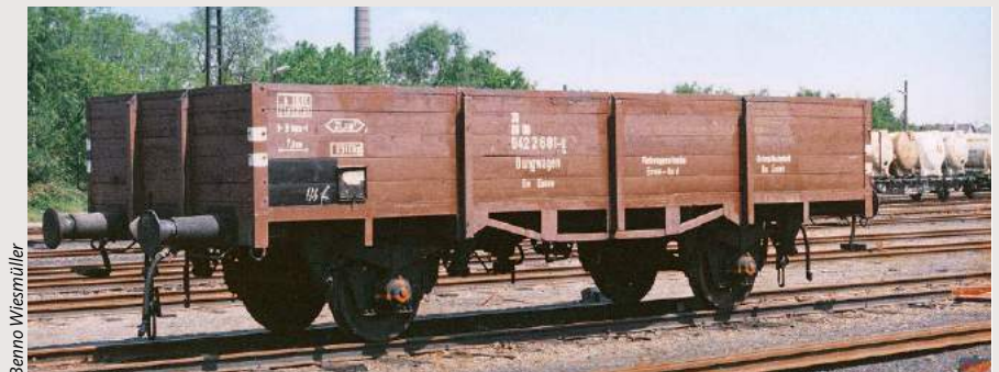
Auf größeren Bahnhöfen mit Viehumschlag waren Dienstgüterwagen für den Abtransport des Dungs zu finden, hier 1977 der Dungwagen der Viehwagenwäusche Essen Nord
