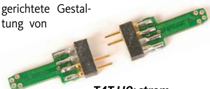
T4T HO: stromführende Kupplung TCP4
