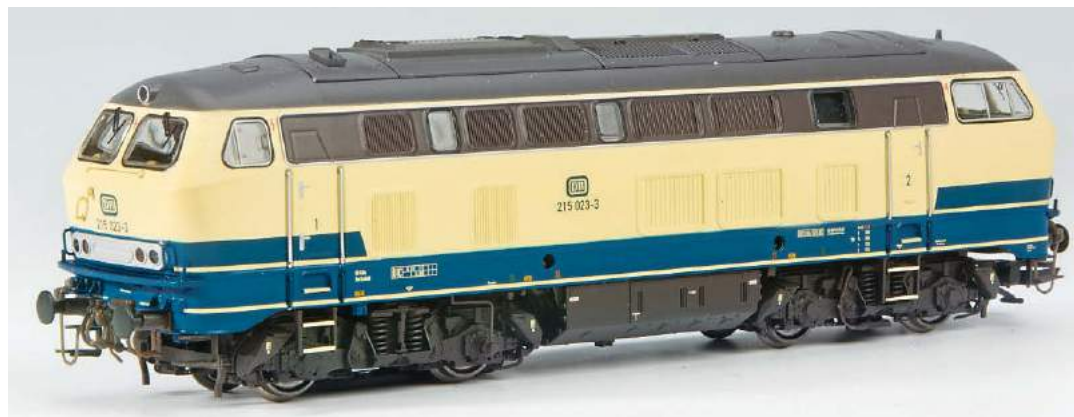
Seitenansicht des ESU-Modells der DB-Diesellok 215 023-3; Zurüsten ist hier nicht erforderlich, eher fallweise ein Abrüsten zum Ausstatten mit zweitem Normschacht samt Kupplung
