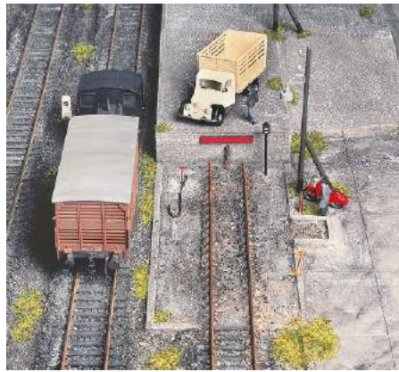
Der Viehwaggon kann nach dem Entladen auf der Waschplatte vor der Kopframpe gereinigt und desinfiziert werden
