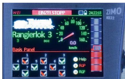
Soll ein lokbezogener Nothalt ausgelöst werden, reicht ein kurzer Druck auf die mit „S“ markierte Taste. Das Triebfahrzeug-Modell wird auf Fahrstufe 0 gesetzt, und die Fahrspannung bleibt eingeschaltet
