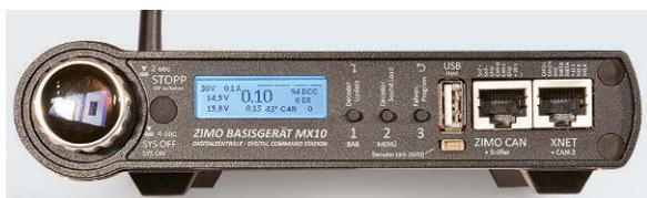
**Vordere Anschlüsse an der Zimo-Zentrale MX10 sowie das kleine Display für die Konfiguration des Gerätes**
