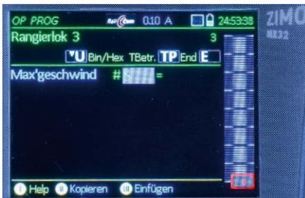
Drückt man die E- und kurz danach die F-Taste, kommt man in die Hauptgleis-Programmierung; hier wird über CV 5 die Maximalgeschwindigkeit programmiert
