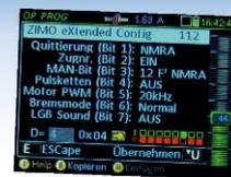
Programmieren der Einzelbits von CVs mit autom. Binär-/Dezimalumrechnung.
