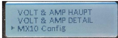
Im grau hinterlegten Display befindet man sich im Konfigurationsmenü; nun wird in „MX10 Config“ gewechselt, wo die Zentrale konfiguriert werden kann
