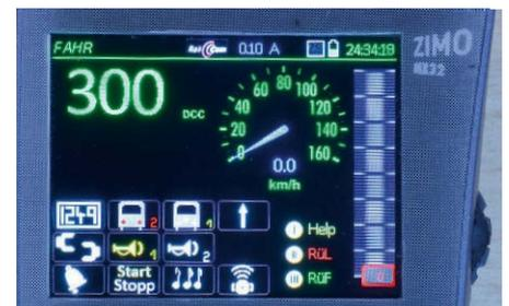
Statt der Anzeige F1, F2 usw. können auch Symbole der Funktionstaste zugewiesen werden, die in großer Auswahl zur Verfügung stehen. Bei der Lok 300 sind einige typische Symbole zu sehen. Da sie keinen RailCom-fähigen Decoder besitzt, ist die Tachonadel blau
