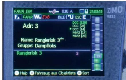
Die Lok kann einer Gruppe zugeordnet werden, was zwar optional ist, aber das Wiederfinden erleichtert. Hier ist es die Gruppe Dampfloks. Bei Bedarf kann das Digitalprotokoll ausgewählt werden, was rechts angezeigt wird. Diese Änderungen sind auch im Fahrbetrieb möglich, wie rechts am Balken des Schiebereglers mit der Fahrstufe 33 sichtbar
