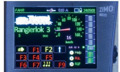
Nachdem die Taste „F“ gedrückt wurde, ist man wieder im Fahrmodus. Die Tachonadel wird bei dieser mit einem RailCom-Decoder ausgestatteten Lok in Magenta angezeigt, da die tatsächlich gefahrene Geschwindigkeit 16 km/h zurückgemeldet wird. Die Funktionen können über den Touchscreen oder auch die Zifferntasten aktiviert werden
