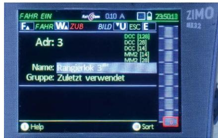
Wurde die Lokadresse eingegeben (hier die 3), kann ein Name vergeben werden. Wie am Mobiltelefon wird dazu mit den Zifferntasten der Lokname eingetippt
