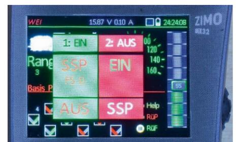
Wenn der Fahrstromausgang 2 ausgeschaltet wurde, kann man ihn durch Berühren der EIN-Schaltfläche auf dem Touchscreen oder mit einem langen Druck auf den Drehknopf wieder einschalten
