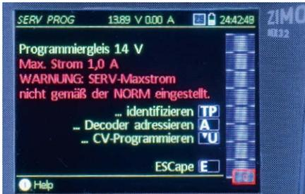
Nach Drücken von E-Taste und „MN“ erscheint der Auswahlbildschirm zum Programmieren. Der rote Hinweis kommt, wenn die Strombegrenzung am Programmiergleis beispielsweise für bestimmte Sounddecoder mit hohem Ruhestrom nicht auf den niedrigen Wert eingestellt wurde. Mit „TP“ wird der Decoder identifiziert, werden Decoder-CV automatisch ausgelesen und auch angezeigt
