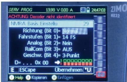
In der Betriebsart „SERV PROG“ wird auf dem Programmiergleis programmiert, hier das CV 29, wobei die Bedeutungen der Bits im Klartext angezeigt werden
