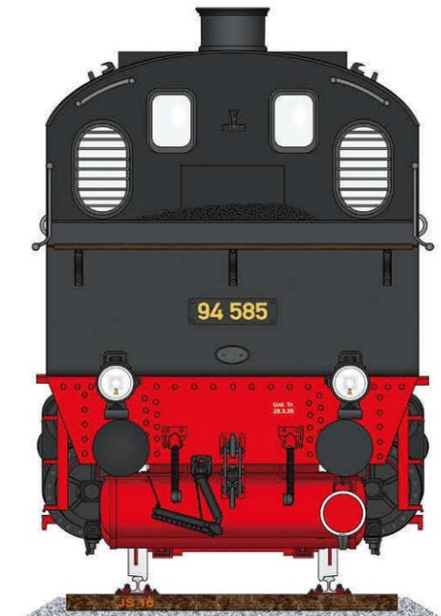
**DRG-Tenderlokomotive 94 585 des Bw Hamm (Westf) Rbf, gezeichnet im Bauzustand von etwa 1936 mit Zweilicht-Spitzensignal und ohne Kohlenkastenaufsatz**
