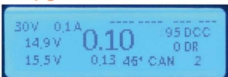
Der Standardbildschirm der Zentrale ist im Fahrbetrieb hellblau. Angezeigt werden links oben Eingangsspannung und Strom (hier 30 Volt und 0,1 Ampere); hinzu kommen die Werte für beide Gleisausgänge, die Temperatur in der Zentrale sowie Angaben für DCC-Pakete, RailCom und den CAN-Bus. Die Striche oben zeigen den Status der Eingänge
