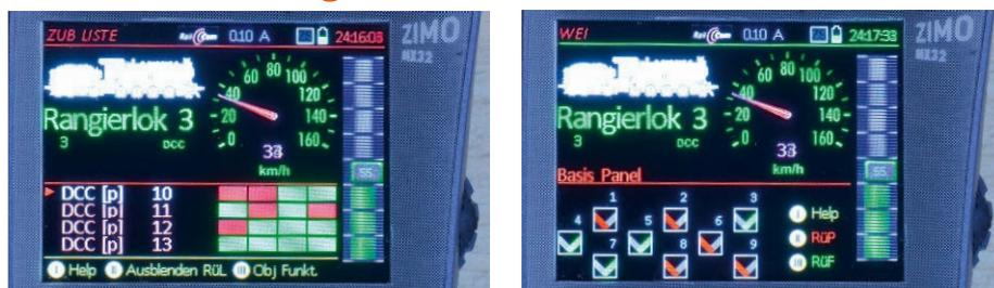
**Weichen können während des Fahrbetriebs über den Softkey II geschaltet werden. Links ist die adressorientierte Anzeige zu sehen, rechts im WEI-Bildschirm die objektorientierte**
