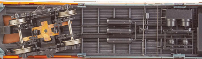
A.C.M.E.: FS-Az mit Scheiben- und Klotzbremsen sowie Achsschleifern
