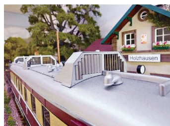
Eigenbau-Triebwagen der Bauart Wumag BC4vT in 1:32 mit motorisch öffnenden Türen und beweglichen Lüfterlamellen auf dem Dach
