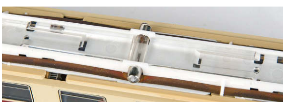
ade: seriensmäßige Innenbeleuchtung mit zwei Soffitten und Lichtleitern
