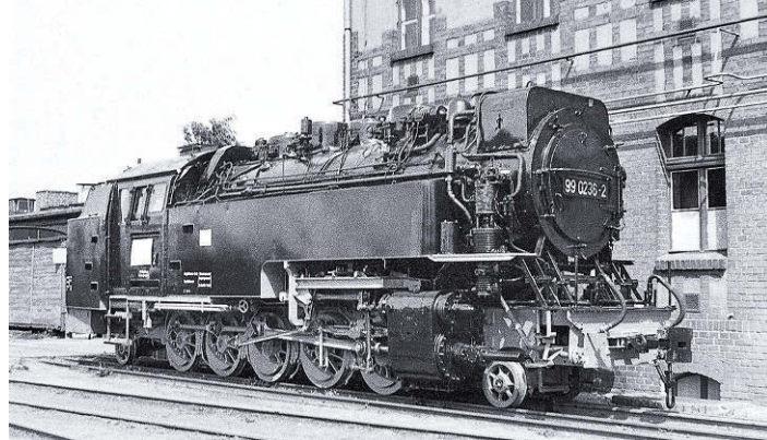
1978 erfolgte der Umbau auf Ölhauptfeuerung im Raw Görlitz auch bei 99 0236; doch das war nur eine vorübergehende Maßnahme
