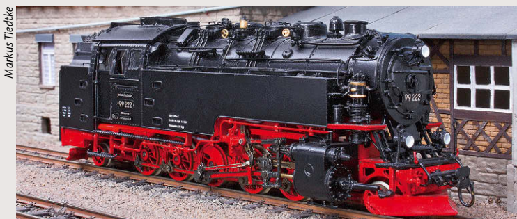
Das Highlight in puncto Harzbahn-Einheitslok ist die Weinert-Version von 99 222, hier in der Ausführung mit Oberflächenvorwärmer
