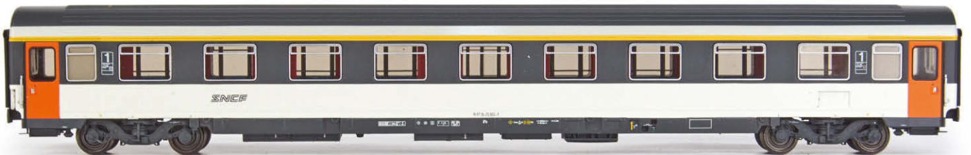
L.S. Models: SNCF-A9u VSE in Corail-Farben aus der Epoche IV mit einfacher Wandvertiefung für das Zuglaufschild
