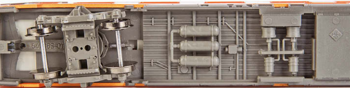
Roco: ÖBB-Amz ohne Scheibenbremsen-Nachbildung am Drehgestell
