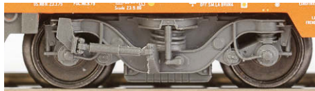
Märklin: verkürzter Achsstand und Ausrüstung mit Schlingerdämpfern und Magnetschienen-Bremsen
