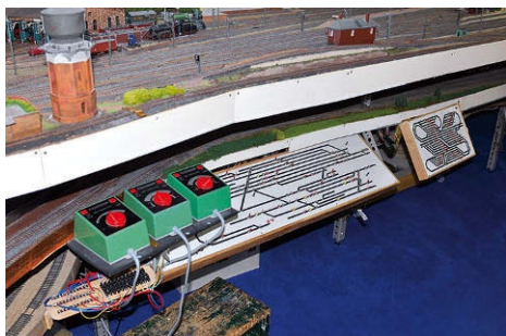
Jeder Bahnhof verfügt über ein eigenes Gleisbildstellpult
