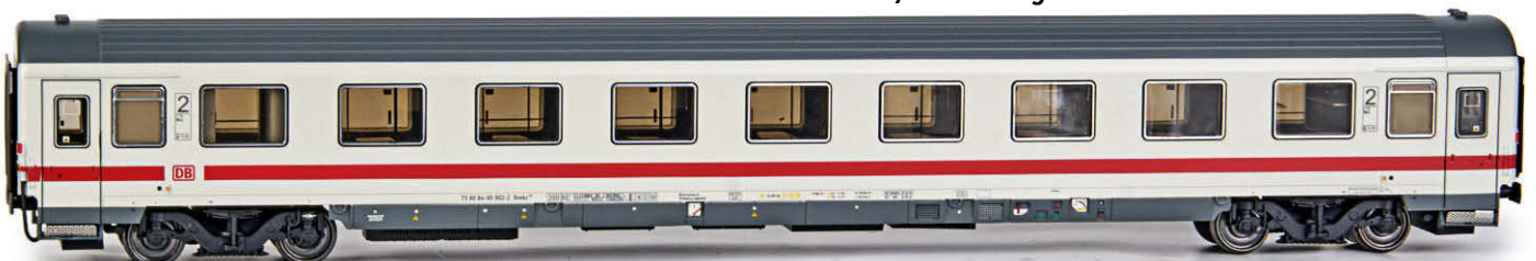
A.C.M.E.: druckertüchtiger DB AG-Bvmkz 856 als deklassierter ehemaliger Avmz 207 für 200 km/h mit neuen Türen und Fensterrahmen sowie entferntem Zuglaufschildkasten
