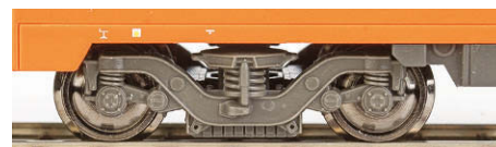
Roco: Die Wankstütze ist angeformt. Die Klotz- und Magnetschienen-Bremsen sind hier ebenfalls montiert
