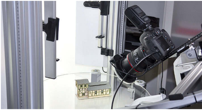
Der erstgebaute Prototyp wird mit der 3D-Kamera aufgenommen und am Computer-Bildschirm auf seine Qualität geprüft
