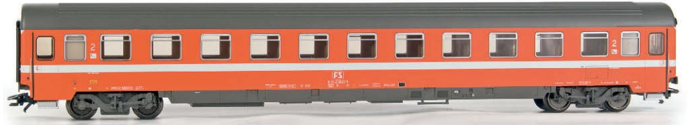
Märklin: FS-Az in C1-Lackierung mit Revisionsdatum von 1979 und Drehgestellen mit Schlingerdämpfern und Mg-Bremsen
