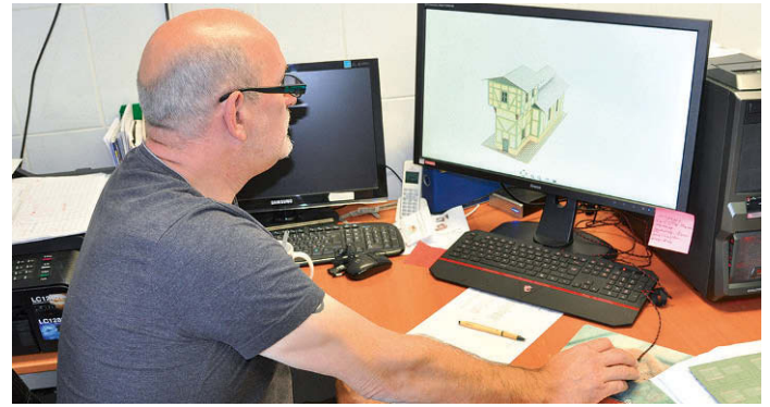
Der erstgebaute Prototyp wird mit der 3D-Kamera aufgenommen und am Computer-Bildschirm auf seine Qualität geprüft
