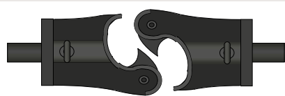
Prinzip der Janney-Kupplung (siehe auch Ausklapper-Zeichnung auf Seite 20)
