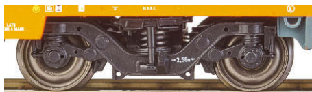
A.C.M.E.: Nur die Wankstütze ist als Teil angesteckt. Außerdem sind Klotzbremsen am Drehgestell vorhanden
