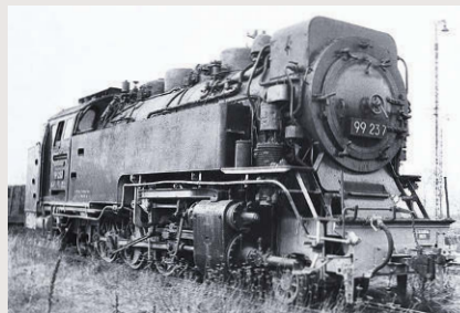
Tenderlok 99 237 bei einem Aufenthalt 1958 im Raw Görlitz-Schlauroth; sie war die einzige Lok mit Rauchkammer-Zentralverschluss und trug die Janney-Kupplung für die Strecke Eisfeld – Schönbrunn
