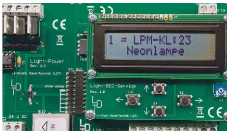
Auf Klemme 23 des Light-Powermoduls ist an Steckplatz 1 der Effekt „Neonlampe“ aktiviert
