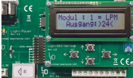
Beim Lichtquellentest wird hier der Ausgang 24 am Light-Powermodul 1 aktiviert
