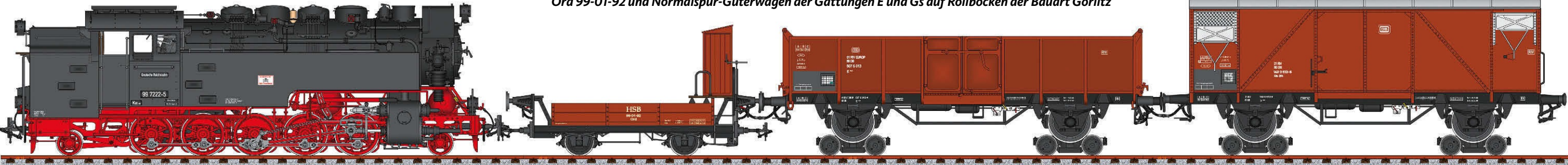
Reichsbahn-Rollbockzug Mitte der 1970er-Jahre mit der Tenderlok 99 7222-5, dem Zwischenwagen Ord 99-01-92 und Normalspur-Güterwagen der Gattungen E und Gs auf Rollböcken der Bauart Görlitz
