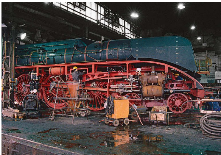
Ihrer Teilverkleidung und der Zylinderbeblechung beraubt, zeigt sich die vormalige 18 201 in der Richthalle des Meiningen Werkes
