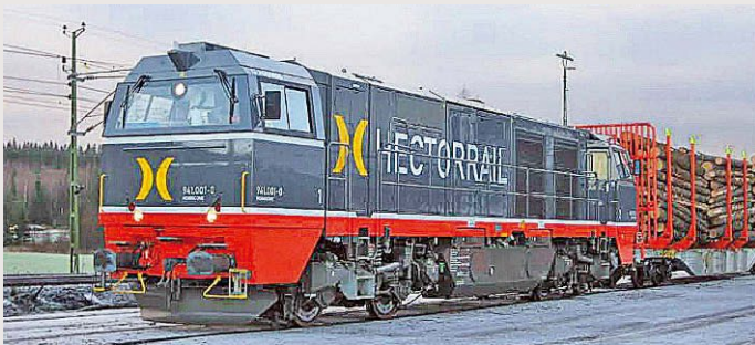
Gestoppte Weiterentwicklung: 2700 kW/3670 PS Antriebs- und 2000 kW Retarder-Bremsleistung hatte 2004 der Prototyp G 2000-4 BB, verkauft 2006 als 941.001 an Hectorrail
