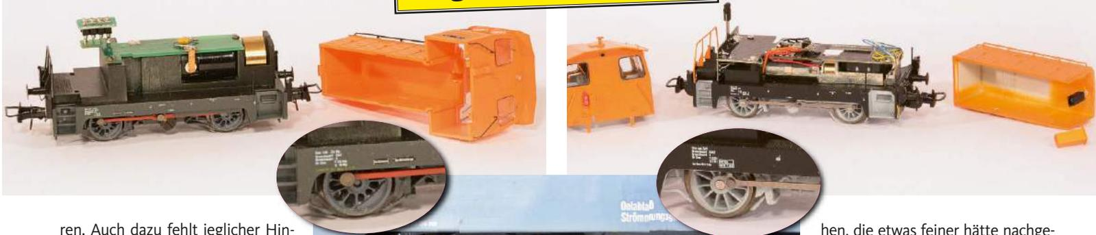
ren. Auch dazu fehlt jeglicher Hinweis, was zu einer Abwertung bei diesem Kriterium führt. Der Decoder-einbauplatz ist auf der Platine im Motorvorbau. Zum Einbau des Lautsprechers muss auch die Platine ausgebaut werden. Dort ist eine Halterung für einen ovalen Lautsprecher vorhanden, die ab Werk mit einem kleinen Zusatzgewicht ausgefüllt ist. Die Wartungsarbeiten sind problemlos durchführbar, und selbst die Radsätze kann man einfach entnehmen.
