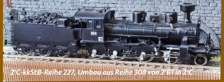
2'C-kkStB-Reihe 227, Umbau aus Reihe 308 von 2'B1 in 2'C
