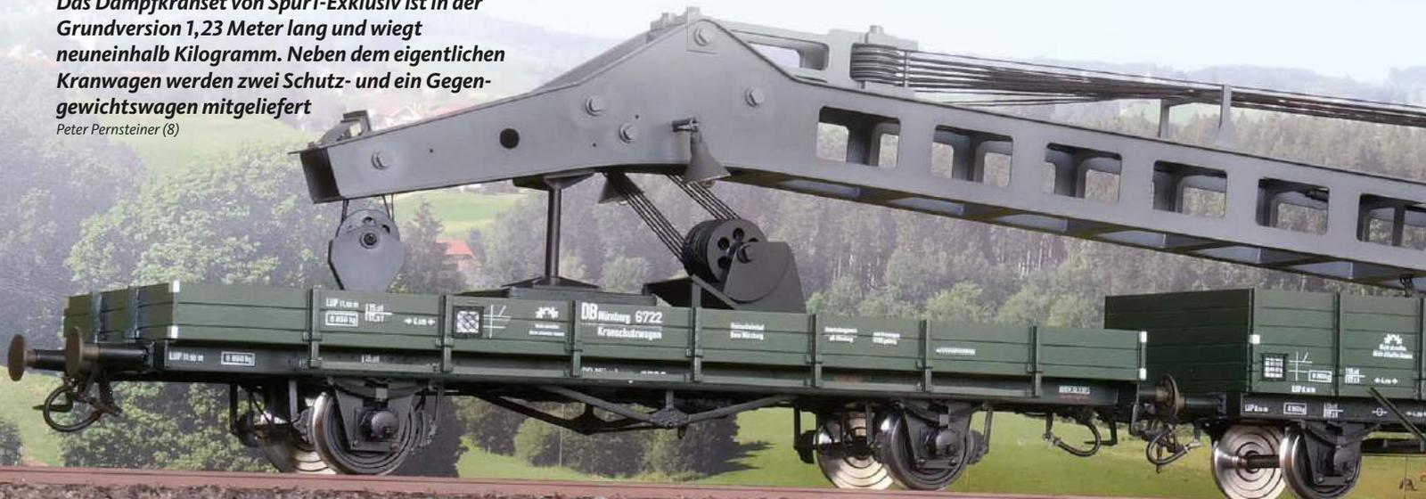
Die Stützarme des Dampfkrans lassen sich herausschwenken und mit beiliegenden Sicherungsstangen nebst Splinten arretieren. Dann können die Stützfüße herausgedreht und mit den Bodenplatten und Holzbohlen unterfüttert werden
