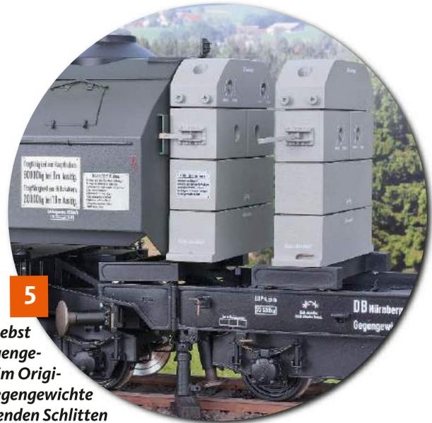
Der Kranwagen „Nürnberg 6700“ nebst Ausleger wiegt bereits ohne die Gegengewichte knapp fünf Kilogramm. Die im Original jeweils 28 Tonnen wiegenden Gegengewichte kann man wie beim Vorbild auf rollenden Schritten an den Kran heranschieben und am Kranhaus fixieren
