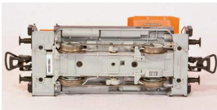
**Piko begnügt sich mit einem Einachsantrieb über das Getriebe und deckt das Zahnrad nicht komplett ab. Der zweite Radsatz wird über die stabilen Kuppelstangen aus Blech mitbewegt**
