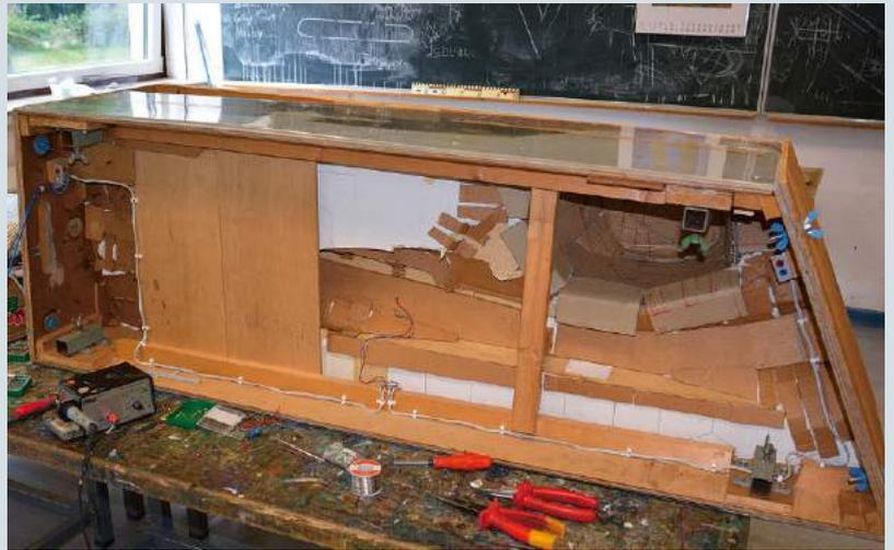
Als Gegenstück ein digitalisiertes FREMOdül mit wenigen, dafür aber dicken Kabeln und der Stromübertragung zu den Nachbarmodulen rechts und links
