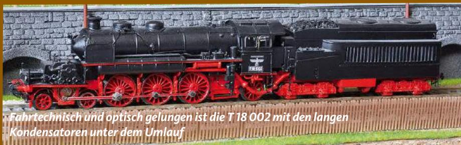
*Fahrttechnisch und optisch gelungen ist die T 18 002 mit den langen Kondensatoren unter dem Umlauf*
