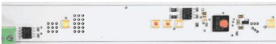
**Links und ganz rechts außen sind die beiden weißen Leuchtdioden zu sehen, die unbeleuchtet gelb aussehen. Die drei LED in der Mitte sind zweimal rot und einmal blau**
