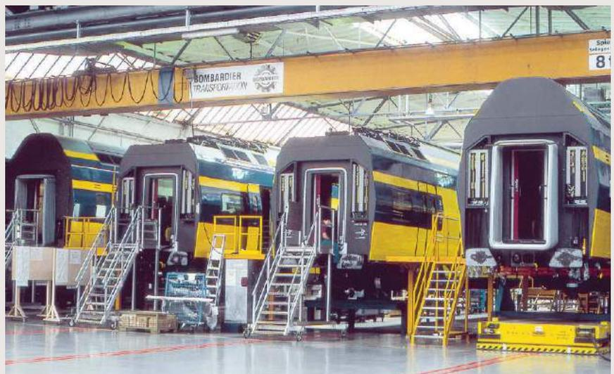
Endmontage der DD-IRM-Triebwagen für die NS im ehemaligen Talbot-Werk in Aachen (später Bombardier)
