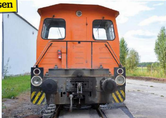
**Das Besondere an der DR-102' ist der Zugang zum Führerhaus über die rückseitige Bühne und die mittig an der Rückwand angeordnete Tür, was von beiden Fabrikaten gut umgesetzt wurde**
