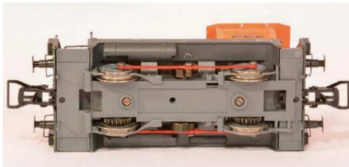
**Die Brawa-Lok ist übers Getriebe auf beiden Radsätzen angetrieben, doch liegen die Stirnräder seitlich an den Rädern offen und sind dadurch für Verschmutzungen empfindlich**
