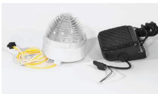
**Erweiterungs-Set „Gewitter“ mit Blitzlampe und über die SUSI-Schnittstelle angesteuertem Soundmodul samt Lautsprecher**
