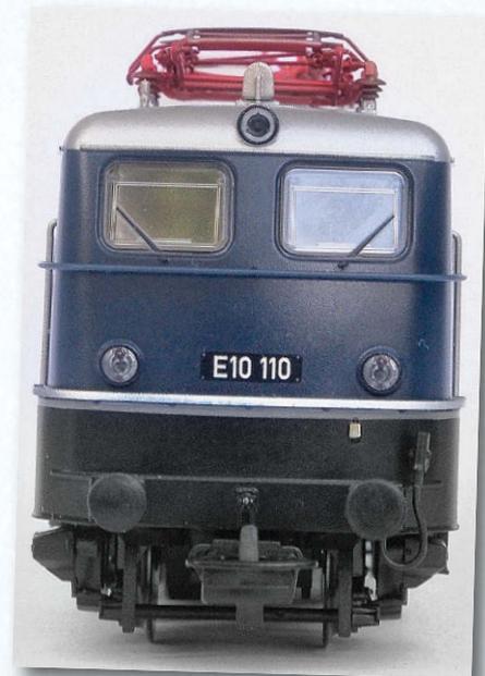
**Die Frontansicht unterstreicht den Detailreichtum, auch wenn die Scheibenwischer nur angraviert sind und die Zurüstteile noch unter der Pufferbohle eingesteckt werden müssen**
