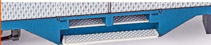
**Lima:** Aufgeklebte Roststreifen mit negativer Gravur; die Türrahmen reichen bis zum Langträger hinein
