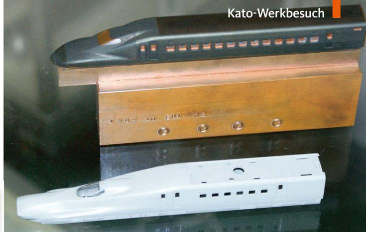
Beispiel aus dem Werkzeugbau: aufwendige Form für ein Gehäuse eines modernen Shinkansen-Triebkopfes
