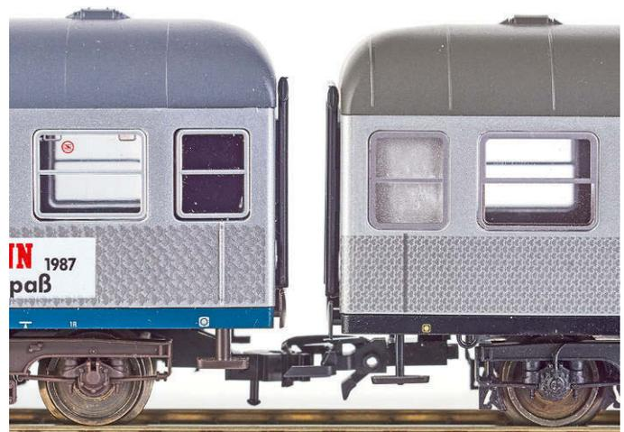
Fleischmann: Auch in Nürnberg hat man immer schon mit den Augenmustern experimentiert. Links ist das alte 1:100-Modell mit recht „metallisch blanker“ Bürstungsstruktur zu sehen. Rechts steht die aktuelle Ausführung des 1:93,5-Modells mit feinerem Muster
