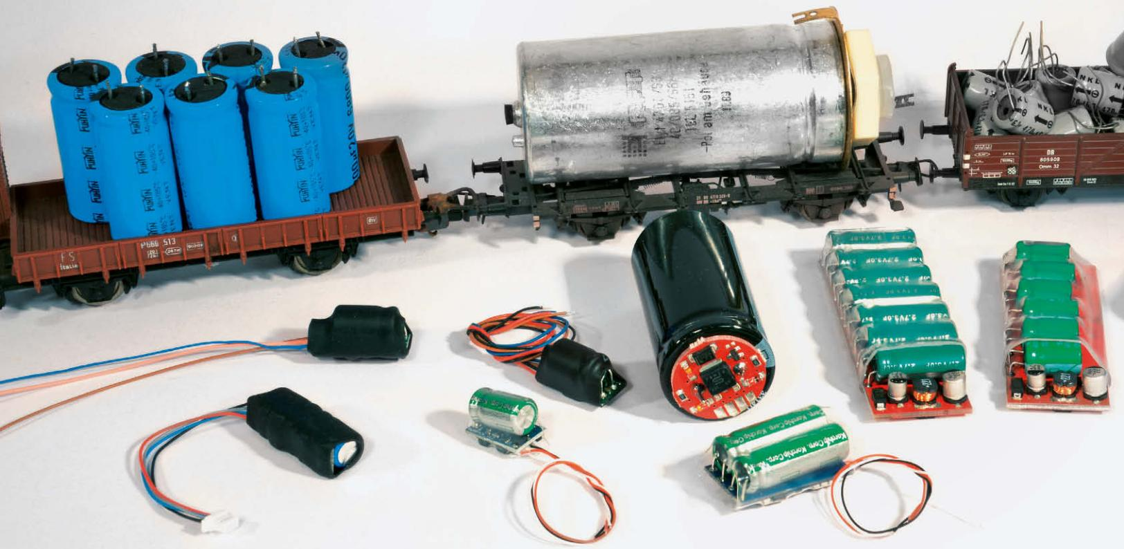
Einbau von Energiespeichern in Digital-Triebfahrzeuge
