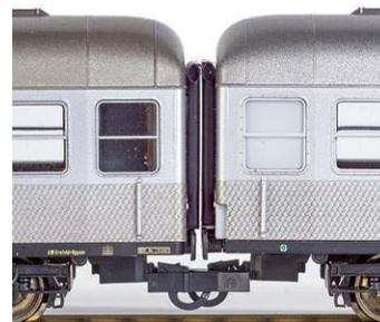
**Roco:** Kurzkupplungs-Abstand, Wagen mit Dach in Graualuminium und rechts in hellerem Ton
