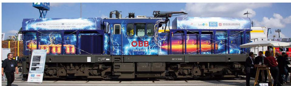
**ÖBB und Tecsol präsentierten die Hybrid-Probelok 1063 039. In den Aufbauten sind Supercabs, Lithiumakkumulatoren und Umrichter untergebracht**
