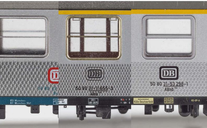
**Vergleich der Pfeuaugen-Muster und der Wagenkastenhöhen. Dazu wurden im Bild alle Fotosegmente an der Dachkante ausgerichtet: Märklin/Trix, Piko, Roco, Lima, ade und Fleischmann (von links). Bis auf den Märklin-Wagen sind die Seitenhöhen weitgehend gleich. Piko hat einen schmaleren Langträgerstreifen lackiert**
