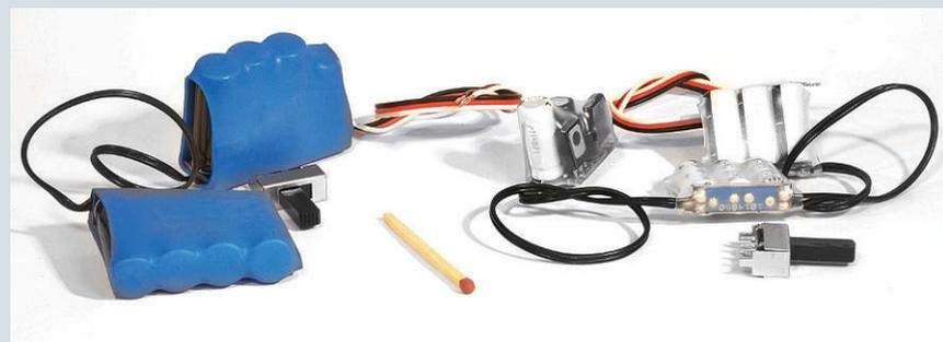
Bei Massoth sind mit den eMOTION-Powercap Maxi und Micro zwei unterschiedlich große Energiespeicher im Sortiment. An den Massoth-Decodern kann über den Decoderausgang BC (Buffer Control) der Energiespeicher gesteuert werden. An Fremddecodern ohne Ansteuerung sollte der beiliegende Schalter eingebaut werden, um beim Programmiervorgang den Energiespeicher abzuschalten. Durch die mehrteilige Bauweise ist es gut möglich, die Baugruppen verteilt im Fahrzeug einzubauen
