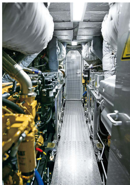
Vom Seitengang ist der Dieselmotor der 218 002 zugänglich (links). Rechts ein Blick in den Maschinenraum der 245 022 mit Mittelgang und vier Industrie-Dieselmotoren
