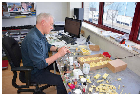
Nach dem Gießen und Entformen (links) müssen die Resin-Teile einige Tage aushärten und sorgfältig kontrolliert werden (Mitte), ehe sie schließlich zu Bausätzen zusammengestellt und verpackt werden können oder zu Fertigmodellen montiert werden, wie rechts zu sehen
