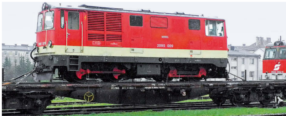
Zum Transportwagen umgebauter ÖBB-Rungenwagen mit der Schmalspur-Diesellokomotive 2095.009 als Ladegut am 19. April 2013 auf dem Gelände der Hauptwerkstätte St. Pölten
