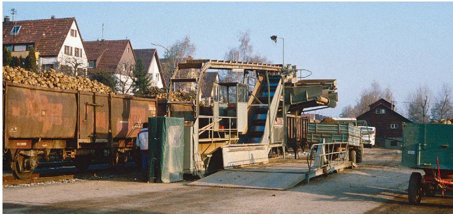
Mit einer Kippvorrichtung konnten die Landwirte die Rüben aus ihren Anhängern entladen. Über ein Förderband gelangten sie in die offenen Güterwagen
