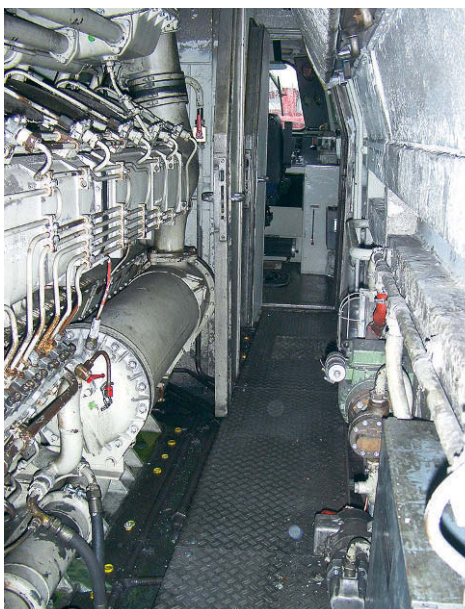
Vom Seitengang ist der Dieselmotor der 218 002 zugänglich (links). Rechts ein Blick in den Maschinenraum der 245 022 mit Mittelgang und vier Industrie-Dieselmotoren
