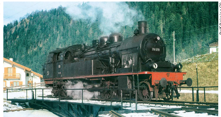
Nachdem sie mit dem Tender voraus Bayrischzell erreicht hat, wendet die Tenderlokomotive 78 070 auf der 20-Meter-Drehscheibe
