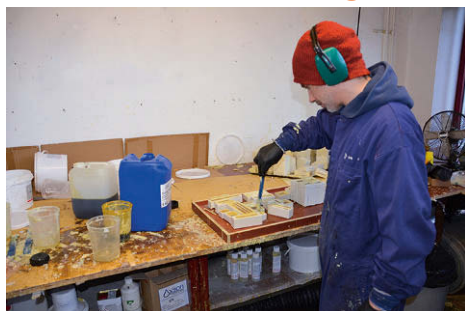
Nach dem Gießen und Entformen (links) müssen die Resin-Teile einige Tage aushärten und sorgfältig kontrolliert werden (Mitte), ehe sie schließlich zu Bausätzen zusammengestellt und verpackt werden können oder zu Fertigmodellen montiert werden, wie rechts zu sehen
