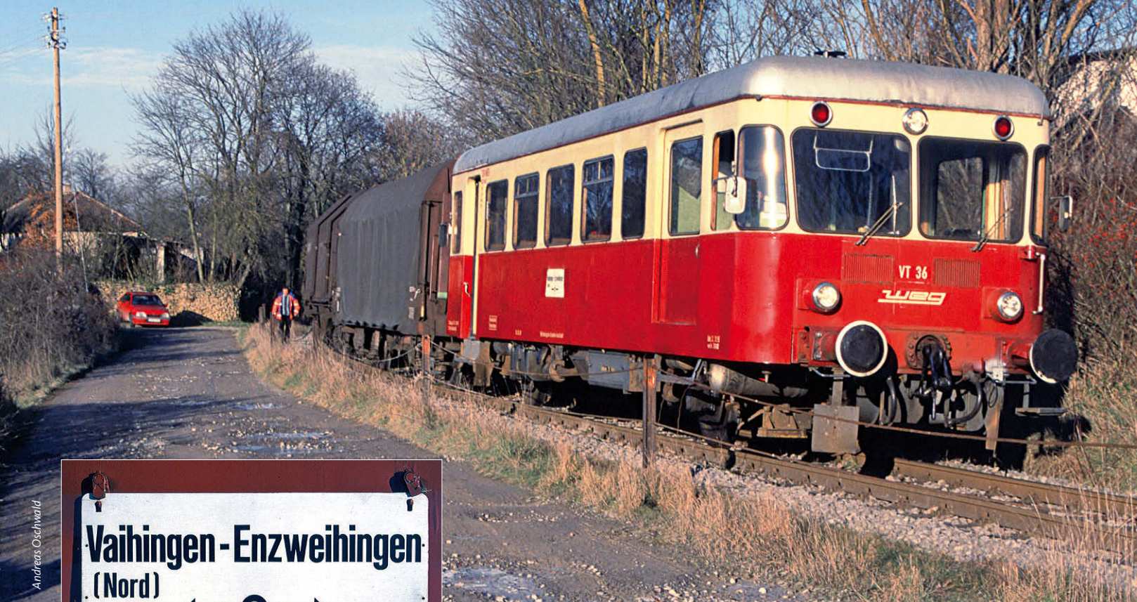
VT 36 hat das Vaihinger Industriestammgleis bedient und legt danach einen kurzen Zwischenhalt ein, damit die Anschlussweiche wieder verschlossen werden kann
