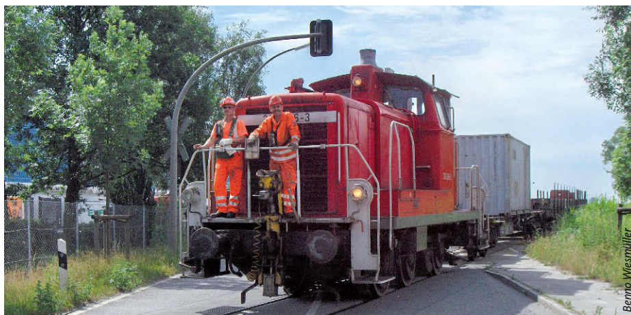
2007 fahren der Rangierlokfürer und der Rangierer im Hamburger Hafen bequem auf der vorderen Bühne der 363 216 mit, die fälschlicherweise Zweilicht-Spitzenlicht zeigt
