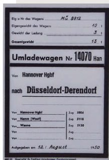
D ie maßgebenden Angaben über Güterwagen-Ladungen waren in den Zettelhaltern anzubringen. Darüber hinaus wurden von einigen Versendern an den Türen oder Wagenwänden Hinweise für den Empfänger angebracht – zum Beispiel, wo er die Tür öffnen sollte, aber auch kleinere Hinweiszettel auf den Wageninhalt, die auch ein wenig als Werbung dienten. Im Prinzip war Werbung an bahneigenen Güterwagen nicht erlaubt. Zwar wurden auch Zettel mit der Aufschrift „Vorsichtig rangieren!“ vom Absender an die Wagenwände geklebt, aber für das Rangierpersonal war das entscheidend, was die Bezettelung im Zettelhalter oder der Rangierzettel vor-schrieben. Weitere Hinweiszettel waren zum Beispiel „BASF Düngemittel“, „Linde“, „Miele“, „Kalkstickstoff“, „Stickstoff/Düngemittel“ usw. Bei einigen Wagen waren übrigens schon damals so genannte Stoßmesser im Fahrzeug angebracht, um feststellen zu können, ob die Wagen aufgelaufen waren, was die Fracht im Wageninneren meist beschädigte. Wurde bekannt, dass sich solch ein Gerät in einem Wagen befand, wurde das mit Kreide an der Wagengürtür mit dem Wort „Spion“ als Warnung für die Rangiererkollegen vermerkt. BV
