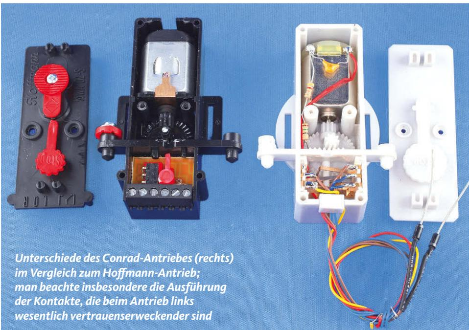
**Unterschiede des Conrad-Antriebes (rechts) im Vergleich zum Hoffmann-Antrieb; man beachte insbesondere die Ausführung der Kontakte, die beim Antrieb links wesentlich vertrauenserweckender sind**
