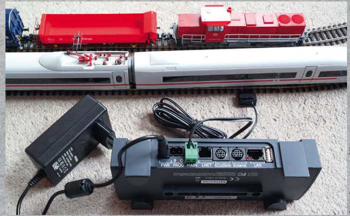
An der Rückseite der Smartbox sind Buchsen für Netzteil, Programmier- und Fahrgleis, LocoNet, EcoSlink für Booster und USB für Updates
