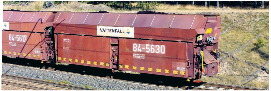
Kohlewagen mit 84 Kubikmeter Inhalt sind das Standardtransportmittel bei der Vattenfall-Werksbahn. Es handelt sich um Sattelboden-Selbstentlader. Bis zu 60 Tonnen Braunkohle passen in einen Wagen. Ein Zug besteht üblicherweise aus 16 Wagen
