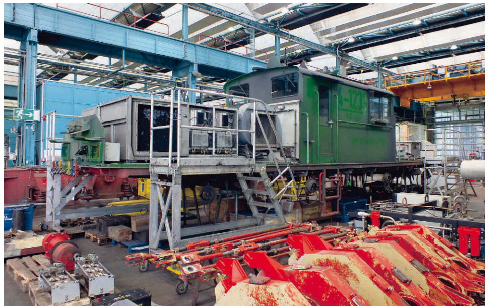
Im August 2015 weilte die Lok 4-1239 zur Aufarbeitung in der Werkstatt Schwarze Pumpe. Hier ist der teildemontierte Oberwagen dieser Lok zu sehen
