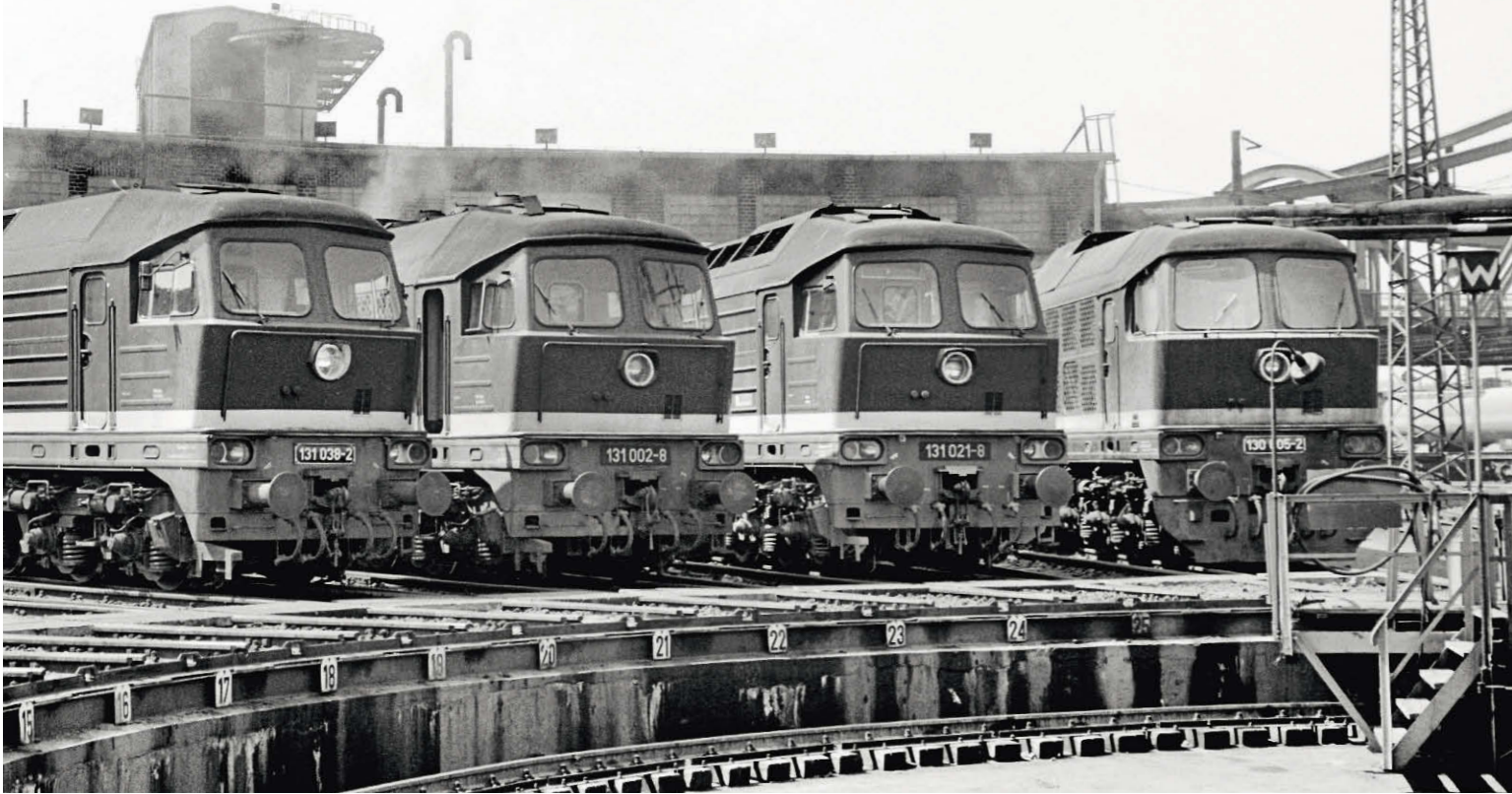
Lokparade am Ringlokschuppen des Bahnbetriebswerkes Halle G am 6. Juni 1975 mit den damals neuen Dieselloks der Baureihe 131 und 130 005
