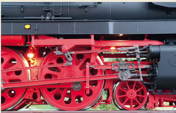
Nahaufnahme der Steuerung in der Position „Fahrtrichtung vorwärts“ sowie die beeindruckende Triebwerksbeleuchtung mit LED-Licht
