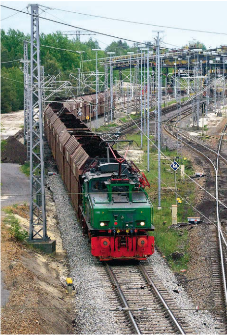
Ein Zug mit 4-1185 verlässt die Kohleverladung Welzow-Süd. Für Fahrleitungen in Seitenlage hat die Lok kleine Stromabnehmer
