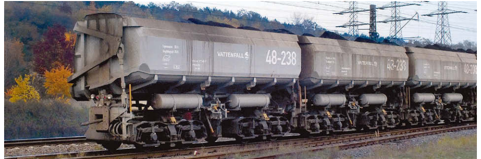
Der Waggonbau Niesky lieferte in den vergangenen Jahren Einseitenkippwagen mit 48 Kubikmeter Inhalt, die den Vorgängertyp mit 40 Kubikmeter Inhalt ersetzen. Transportiert werden mit solchen Wagen vor allem Asche und Ton
