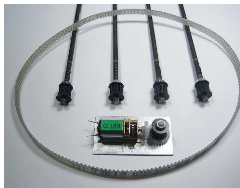
Der Antrieb der Brücke kann mit handelsüblichen Bauteilen erfolgen. Die Positionierung ist abhängig von der Länge des Zahnriemens
