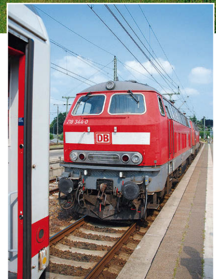
IC-Züge nach Westerland sind ab Itzehoe mit Dieselloks der Baureihe 218 bespannt. Das Umspannen erfordert aufwendige Rangiermanöver
