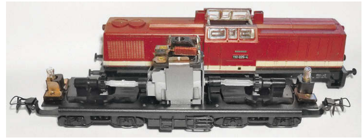
Auch die vor 50 Jahren erstmals gebaute Gütsold- DR-V 100/110 bekam einen Mittelmotor-Antrieb mit Kardangelenken und Drehgestell-Getrieben
