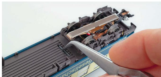
An der Unterseite des Wagens gibt es einen unscheinbaren 13-mm-Schlitz. Wenn man mit einer spitzen Pinzette auf die darin befindliche microSD-Speicherkarte drückt, wird diese entriegelt, einige Millimeter herausgeschoben und kann dann entnommen werden
