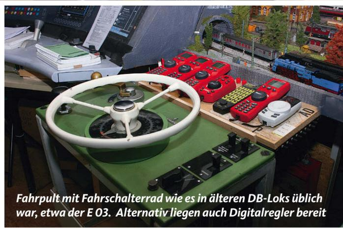
**Fahrpult mit Fahr Schaltrrad wie es in älteren DB-Loks üblich war, etwa der E 03. Alternativ liegen auch Digitalregler bereit**
