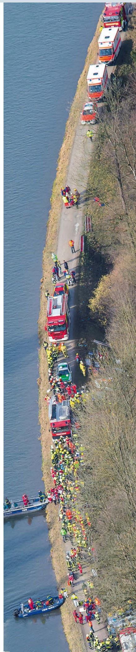
Die schwer zugängliche und unübersichtliche Unglücksstelle: Der dreiteilige FLIRT (ET 355, unten) war auf dem Weg in Richtung Bad Aibling. Sein Kopf-Segment wurde beim Zusammenprall von dem ihm entgegen kommenden ET 325 regelrecht aufgeschlitzt. Im Luftbild erkennt man die fast im 90-Grad-Winkel abstehende linke Seitenwand
