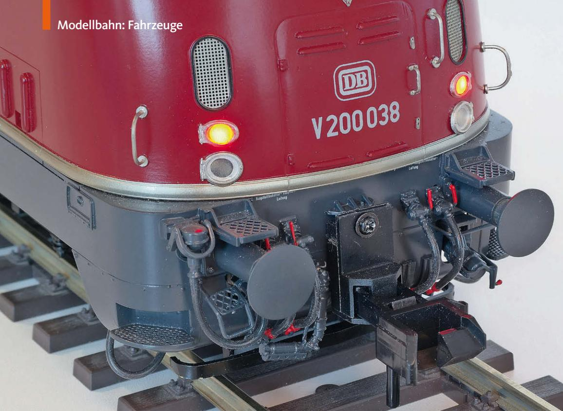
**Wer die V 200 von KM 1 (links) mit einer Klauenkupplung betreiben will, muss diese von außen auf die Schraubenkupplungsdurchführung montieren. Die Märklin-Lok (rechts) verfügt stattdessen vorn und hinten über einen 40 Millimeter breiten Schlitz für Klauenkupplungen**
