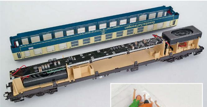
Für einen Blick ins Innere und zum Einbau der lose beiliegenden Figuren (rechts) müssen an den Wagenenden die beiden Balgenübergänge abgezogen und danach der Wagenaufbau abgehoben werden. Die Elektronik des Gesellschaftswagens besteht aus einer langen Leiterplatte, zwei Lautsprechern, dem unter der Platine aufgesteckten Multiprotokoll-Digitaldecoder (oben links) und dem Lesegerät für die microSD-Speicherkarte (oben rechts)
