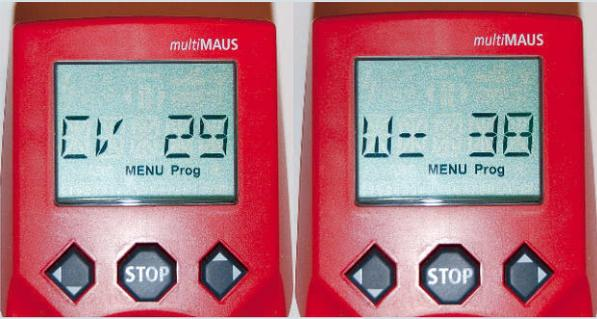
Die für die Decodergrundeinstellungen wichtige CV 29 wurde an Rocos multiMAUS angewählt. Im nächsten Schritt wird der Wert 38 (lange Adressen aktiv sowie 28/128 Fahrstufen) programmiert
