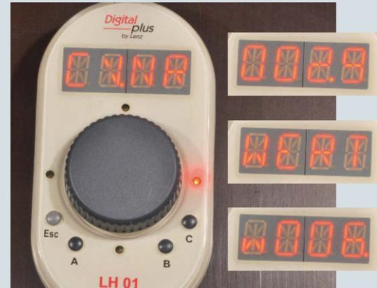
**Displayinhalte beim Auslesen an Einsteigerzentralen wie der Lenz-LH 01: Bei der Decoder-Programmierung im POM-Modus wird zuerst die CV 29, dann der Wert 06 eingegeben**
