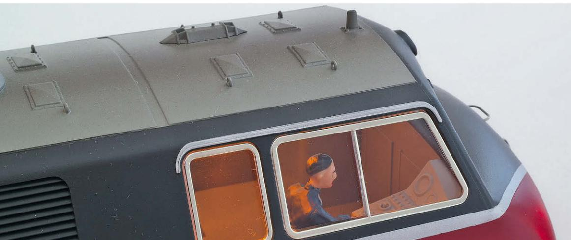
**Der Führerstand der KM 1-Lok (ganz oben) wurde umfassend detailliert. In der Märklin-Lok (darunter) ist der Führerstand weitaus spartanischer dekoriert. Im Dach sieht man in der zweiten Reihe der Lüftungsklappen die Nachbildung des eigentlich erst in Epoche IV realisierten Lüfters der Bauart Kuckuck**
