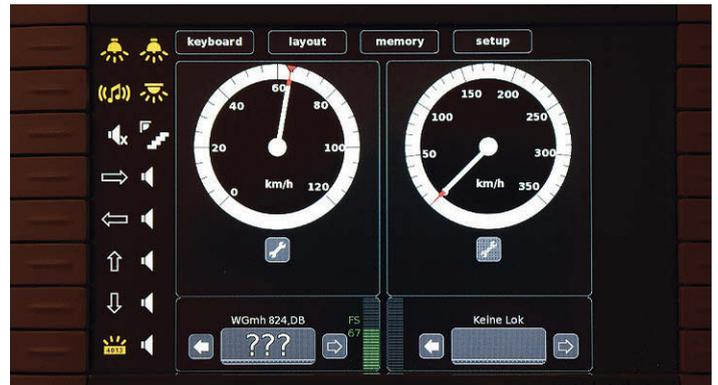
Nach dem Aufgleisen stehen an der CentralStation 2 nicht weniger als 16 schaltbare Digitalfunktionen zur Verfügung, die sich über ihre Funktionssymbole von selbst erklären
