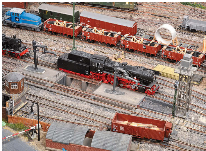
Für die Versorgung der zahlreichen Dampfloks sind ein Hochbunker mit Kohlekran, mehrere Wasserkranne, ein Besandungsturm sowie ein Entschlackungsumpf erforderlich. Im Hintergrund wird gerade von der Henschel-DHG 500 ein Überseekabel transportiert
