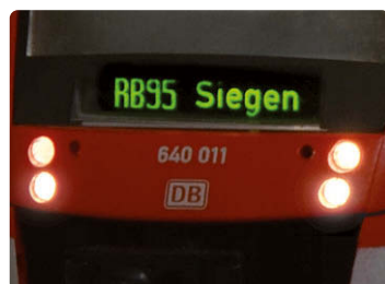
Triebwagen mit zuschaltbarem Fernlicht
