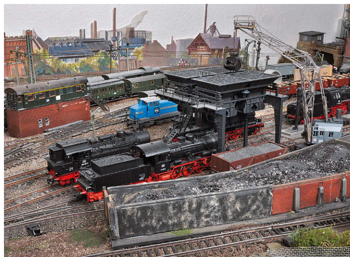
Für die Versorgung der zahlreichen Dampfloks sind ein Hochbunker mit Kohlekran, mehrere Wasserkranne, ein Besandungsturm sowie ein Entschlackungsumpf erforderlich. Im Hintergrund wird gerade von der Henschel-DHG 500 ein Überseekabel transportiert
