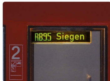
Beleuchtete Zuglaufschilder, auch seitlich
