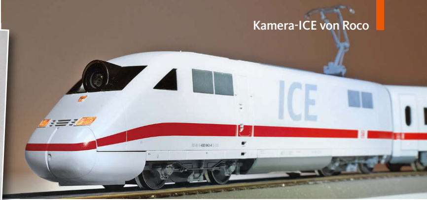
Die Videokamera ragt oben leicht aus dem Frontfenster heraus. Per Funktionstaste in der WLAN-Fernbedien-App kann die Spitzenbeleuchtung des Triebkopfs zugeschaltet werden
