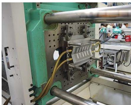
**Die andere Hälfte der Form mit der Sichtseite des Spritzgussteils; über die Schläuche wird die Form mit Wasser gekühlt**
