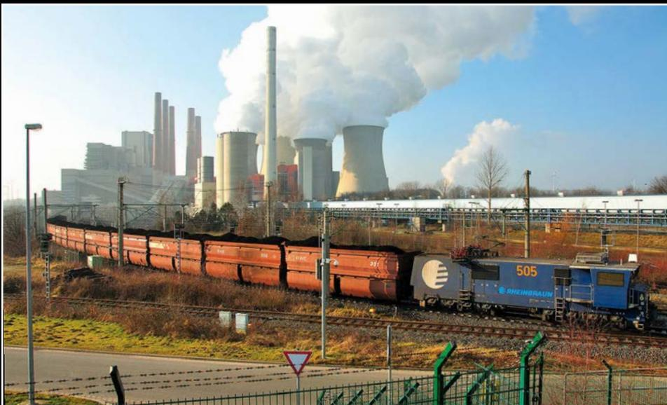
Im Rheinischen Braunkohlerevier, zwischen Köln und Aachen gelegen, betreibt die RWE Power AG ein umfangreiches normalspuriges und elektrifiziertes Werksbahnnetz. Es verbindet die Tagebaue mit den zahlreichen Kraftwerken. Eine moderne Lokomotive vom Typ EL2000 bedient am 16. Februar 2015 die Bunkeranlagen des Kraftwerkes Neurath *Stephan Karkowski*
