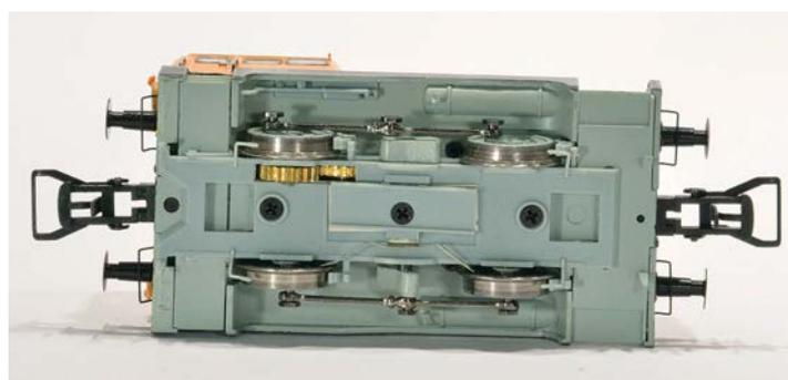
Das Brawa-101-Fahrwerk mit frei liegenden Stirnzahnrädern und klobigen Sechskantschrauben zur Befestigung der Kuppelstangen
