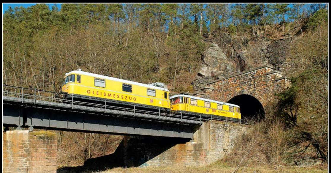
*Auf der Elstertalbahn von Gera über Greiz und Plauen nach Weischlitz steht am 10. März 2014 eine Messfahrt zur Gleisgeometrie an. Der zweiteilige Gleismesstriebzug der Baureihe 725/726 prüft mit Ultraschall den Zustand der Gleise, hier auf der Elsterbrücke am Lochgut-Tunnel zwischen Wünschendorf (Elster) und Berga (Elster)* Frank Barteld
