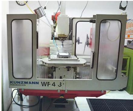
**Mit der CNC-Fräsmaschine, die mit CAD-Daten gefüttert wird, werden die Rohlinge für die Formen grob bearbeitet**
