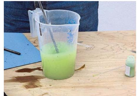
Die Zutaten aus dem Langmesser-Sortiment sowie Werkzeuge für das Anmischen des Gießharz-Wasserimitats, das mit einem Schuss grüner Puderfarbe versetzt und gründlich durchmischt wird, wobei ein Akkuschauber mit einem eingespannten Rührstab gute Dienste leistet
