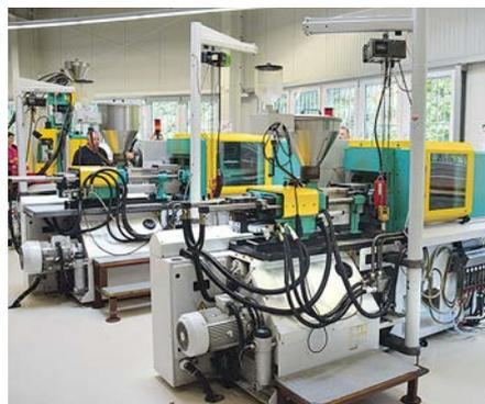
**Über den Trichter oben wird das Plastik-Granulat in Verbindung mit Farbkonzentrat der Spritzgussmaschine zugeführt**
