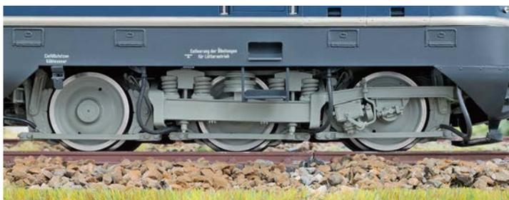
Die Drehgestelle sind nicht nur super detailliert, sondern erhielten auch Kugellager zur verschleißarmen Stromaufnahme sowie Einzelradfederung
