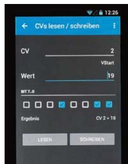
CV-Programmierung für Decoder-Parameter
