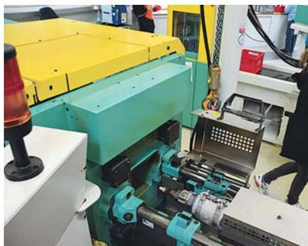
**Das Ende der beheizten Förderschnecke der Spritzgussmaschine; von hier aus wird das Material in die Form gespritzt**
