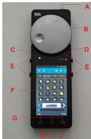
Stelle des Balkens die neue Sollgeschwindigkeit vorgeben. Wie von Zauberhand setzt sich dann auch der Motorregler für den Drehknopf in Bewegung, bis er die Winkelstellung des gewünschten Sollwerts erreicht hat. Auf diese Weise kann auch ein Komfortbremsvorgang ausgelöst werden, indem man per Finger links neben den Balken tippt.
