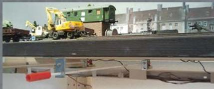
Signalmechanik mit einer Kappe eines Faserstiftes
