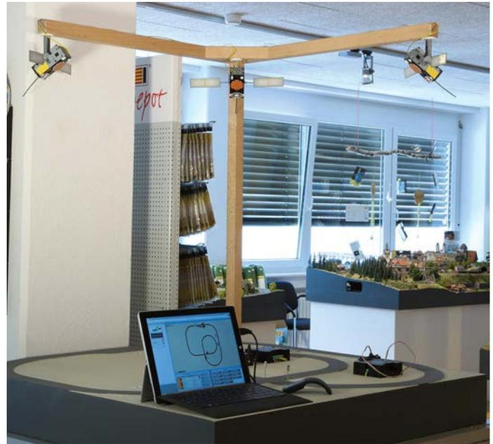
**Digital-3.0-Demo-Schaustück im Schulungsraum der Firma Faller; zu sehen sind die an Galgen angebrachten Satelliten für die Ortung, die Fahrbahnen, verschiedene Steuergeräte und ein Tablet-Computer**
