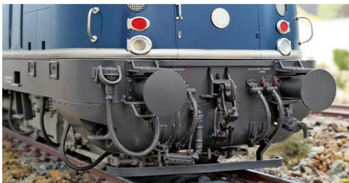
Lokfronten wie beim Vorbild; sie weisen unter anderem flexible, aushängbare Bremschläuche und eine Schraubenkupplung auf
