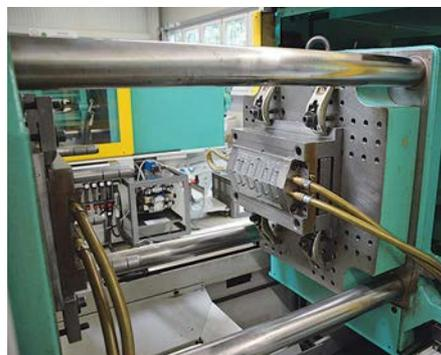
**Halbte einer Gussform für ein Fabrikdach; die herausstehenden Stifte sind die Auswerfer, die das Teil aus der Form drücken**
