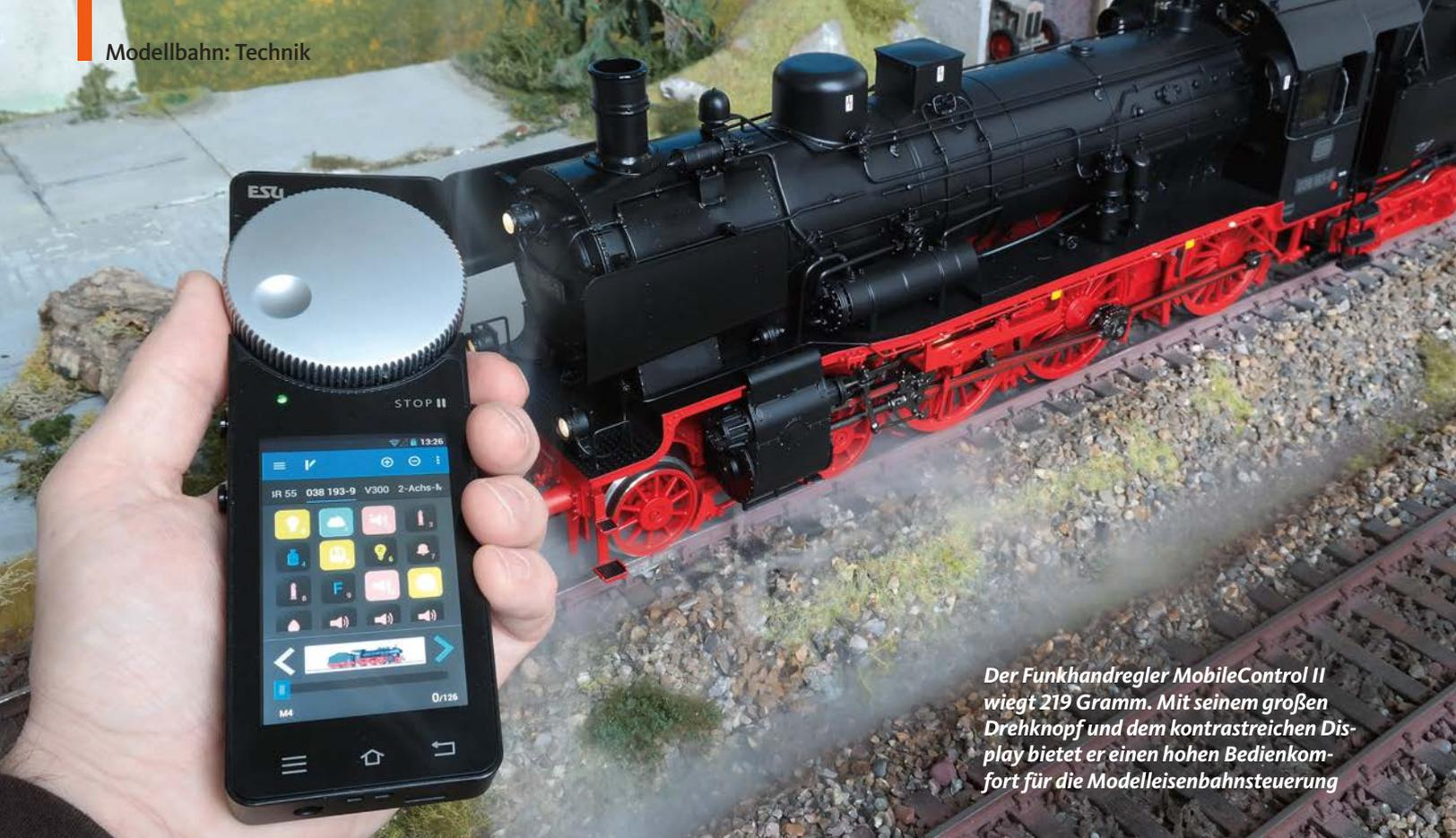
*Der Funkhandregler MobileControl II wiegt 219 Gramm. Mit seinem großen Drehknopf und dem kontrastreichen Display bietet er einen hohen Bedienkomfort für die Modelleisenbahnsteuerung*
