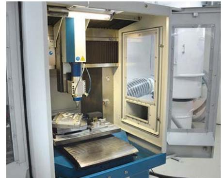
**Die Konturen in der Form werden teilweise mit der CNC-Fräse gefräst, teilweise aber auch erodiert**
