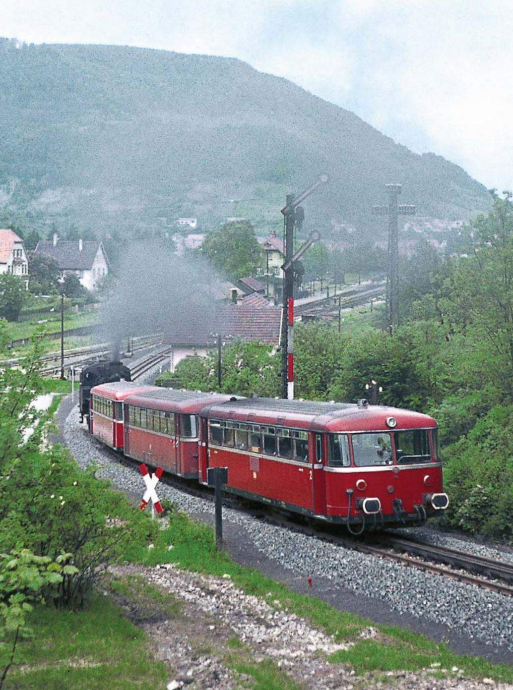
LINKS Die Strecke Reutlingen – Kleinengstingen wurde schon 1956 vollständig auf VT 98 umgestellt, doch im Zahnstangenabschnitt Honau – Lichtenstein mussten die Zahnradampfloks der Reihe 97<sup>s</sup> unverändert nachschieben oder abbremesen. Am 1. Juni 1961 rollt der VT 98 mit Bremslok in den Bahnhof Honau ein. Erst mit dem Erscheinen der VT 97 konnte hier der Dampfbetrieb aufgegeben werden. FOTO: HANS GEORG KNAPP
