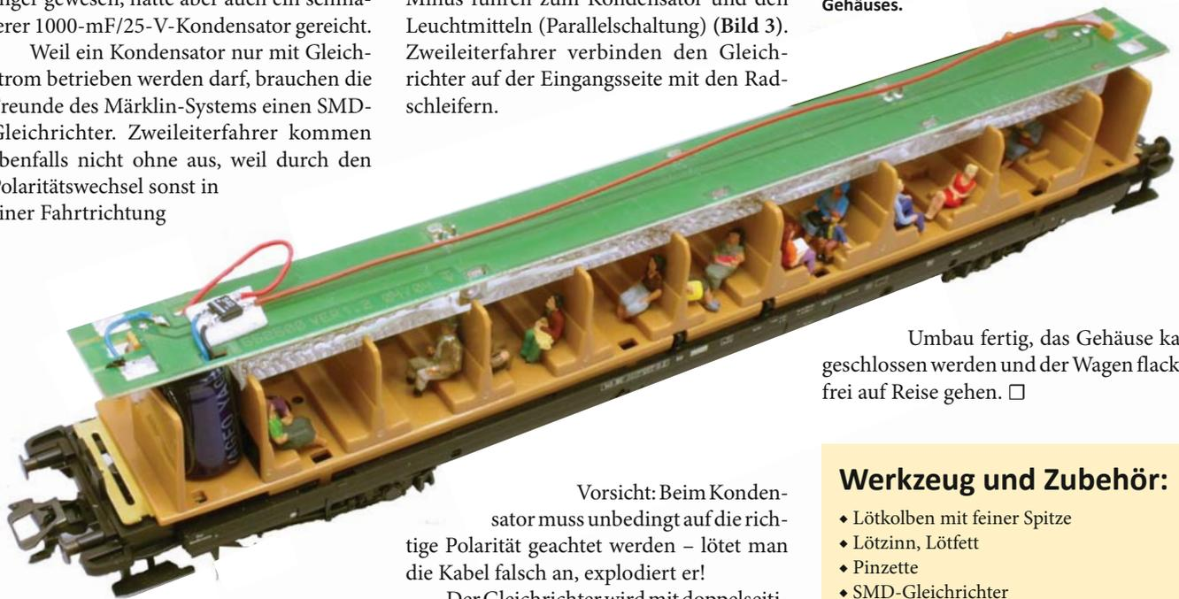
Umbau fertig, das Gehäuse kann geschlossen werden und der Wagen flackerfrei auf Reise gehen. □
