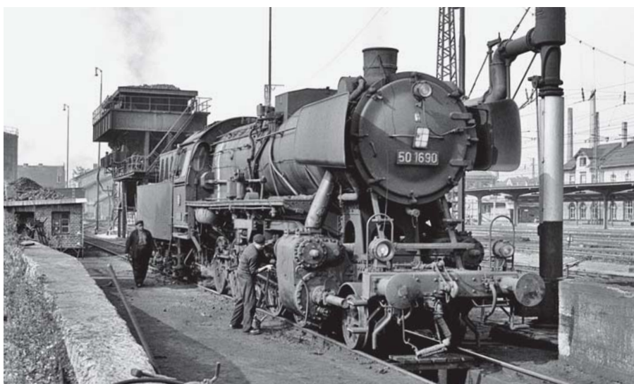
Ständig auf der Rampe und doch nie im Rampenlicht: die weitgehend im Schiebedienst tätigen Bebraer 50er. Wir sehen 50 1690, erkennbar für den Schiebedienst mit Mühlhausen-Kupplung ausgerüstet, beim Restaurieren im Bw Bebra Westseite, Frühjahr 1963.
