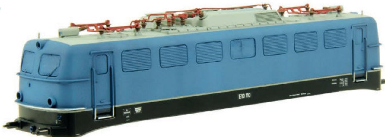
se geklebt und lassen sich nicht entnehmen. Um die Scheiben vor Farbe zu schützen, müssen sie abgedeckt werden. Am einfachsten verwendet man dafür Maskierfilm, den man mit einem kleinen Holzspieß aufträgt, der vorne leicht abgerundet wurde (Bild 2).
