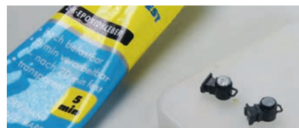
Mit Uhu plus schnellfest imitiert man die Lampengläser.
