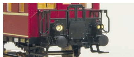
Ohne Lampenglas funktioniert die vorgesehene Lichtführung nicht mehr.
