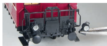
Die reparierten Lampen werden auf ihre Sockel geschoben.
