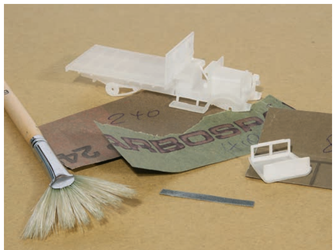
Vor dem Lackieren müssen die Bauteile glattgeschliffen werden.
