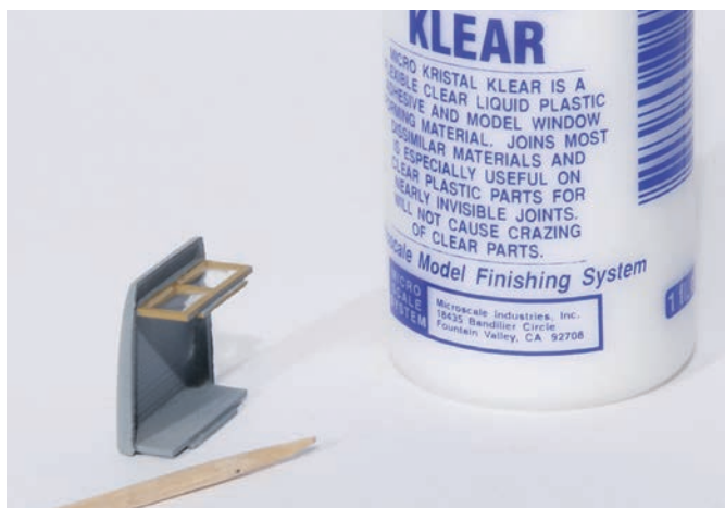
Die Windschutzscheibe entsteht aus einer Verglasungsflüssigkeit.
