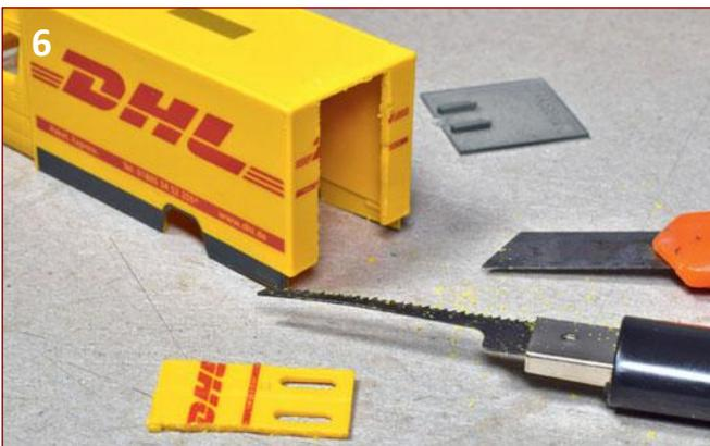
**Bild 6:** Auch eine dünne Bastelsäge kann beim Aussägen der Türöffnung gute Dienste leisten. Im Hintergrund ist der einteilige Fenstereinsatz zu erkennen.
