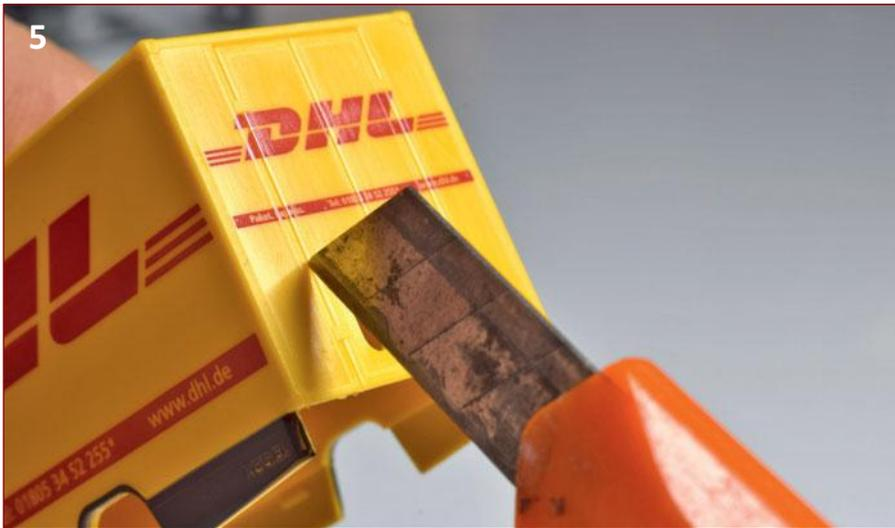
**Bild 5:** Mit einem scharfen Tapetenmesser oder Skalpell schneidet man zunächst vorsichtig die Türkanten und den Türsturz am Heck entlang, anschließend vertieft man die Schnitte in mehreren aufeinanderfolgenden Durchgängen immer weiter.
