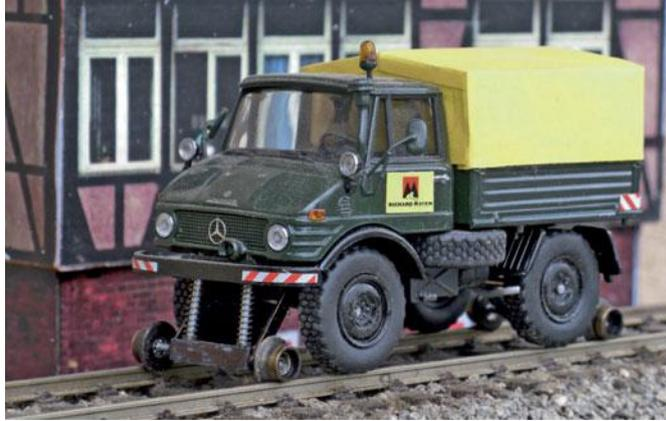
Hingucker für die Bahn: Die Spurweite des Unimogs entsprach exakt der Schienenspurweite. So entstand die Idee eines Zweibegefahrzeugs: „Die Aufgleisung dauert nur 20 Sekunden!“
