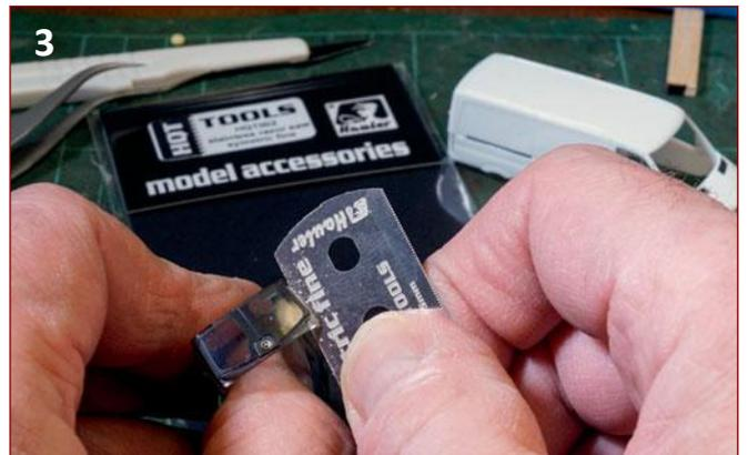
**Bild 4:** Anschließend wurden diese ausgesägten Fenster in die hinteren Türausschnitte eingeklebt und mit feinem Naßschleifpapier (Körnung 400) bündig verschliffen.
