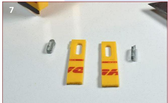
**Bild 7:** Die Türen lassen sich auf einer passenden Schneideunterlage leicht trennen. Größere Probleme bereitet das spröde Trägermaterial der Heckfenster, das entfernt werden muss, um die Fenster exakt in die Öffnungen einzupassen. Alternativ kann man auch neue Fenster aus Folie zuschneiden.
