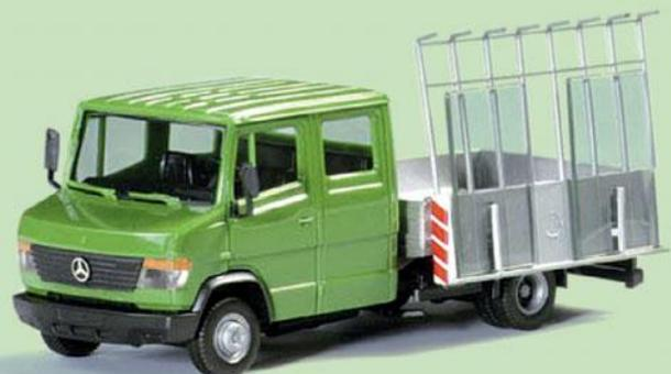
Der Vario besetzt den Übergangsbereich von Transporter zu Lkw. Auf das solide Fahrgestell in Lkw-Technik konnten auch ausladende oder schwere Sonderaufbauten gesetzt werden, ein Führerschein der Klasse 3 reichte immer, um das Fahrzeug zu bewegen.
