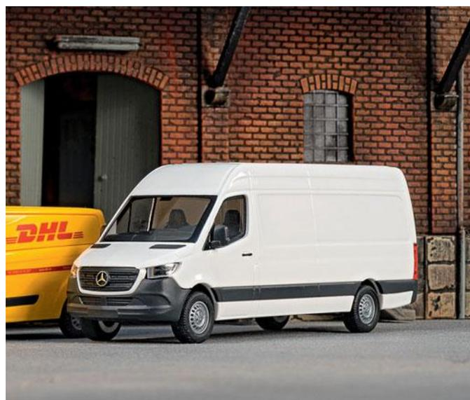
Mit Längen von rund 5,5 bis über 7 Metern, mit verschiedenen Radständen und unzähligen Aufbauvarianten gibt es kaum eine Aufgabe in der Fahrzeugklasse bis 7,5 Tonnen, die der Sprinter/ Crafter nicht erledigen könnte.
