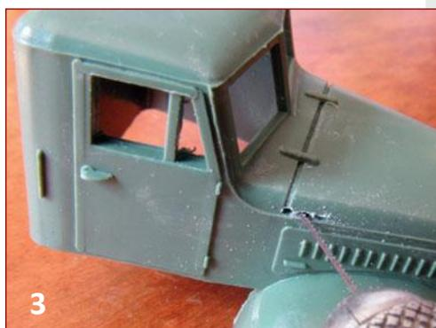
**Bild 1:** Als Ausgangspunkt für die Bastelarbeiten dient ein Bausatz eines KrAZ 256 der Firma SMK (Z@Z) im Maßstab 1:87. Alternativ haben auch ZZ Modell sowie der österreichische Spezialist für Militärmodelle Arsenal M ein Modell dieses ukrainischen Lkw-Klassikers im Sortiment. Zur Türöffnung werden neben einem scharfen Messer ein Laubsägeblatt, ein Minibohrer (0,3 Millimeter) sowie eine scharfe Rasierklinge benötigt.
