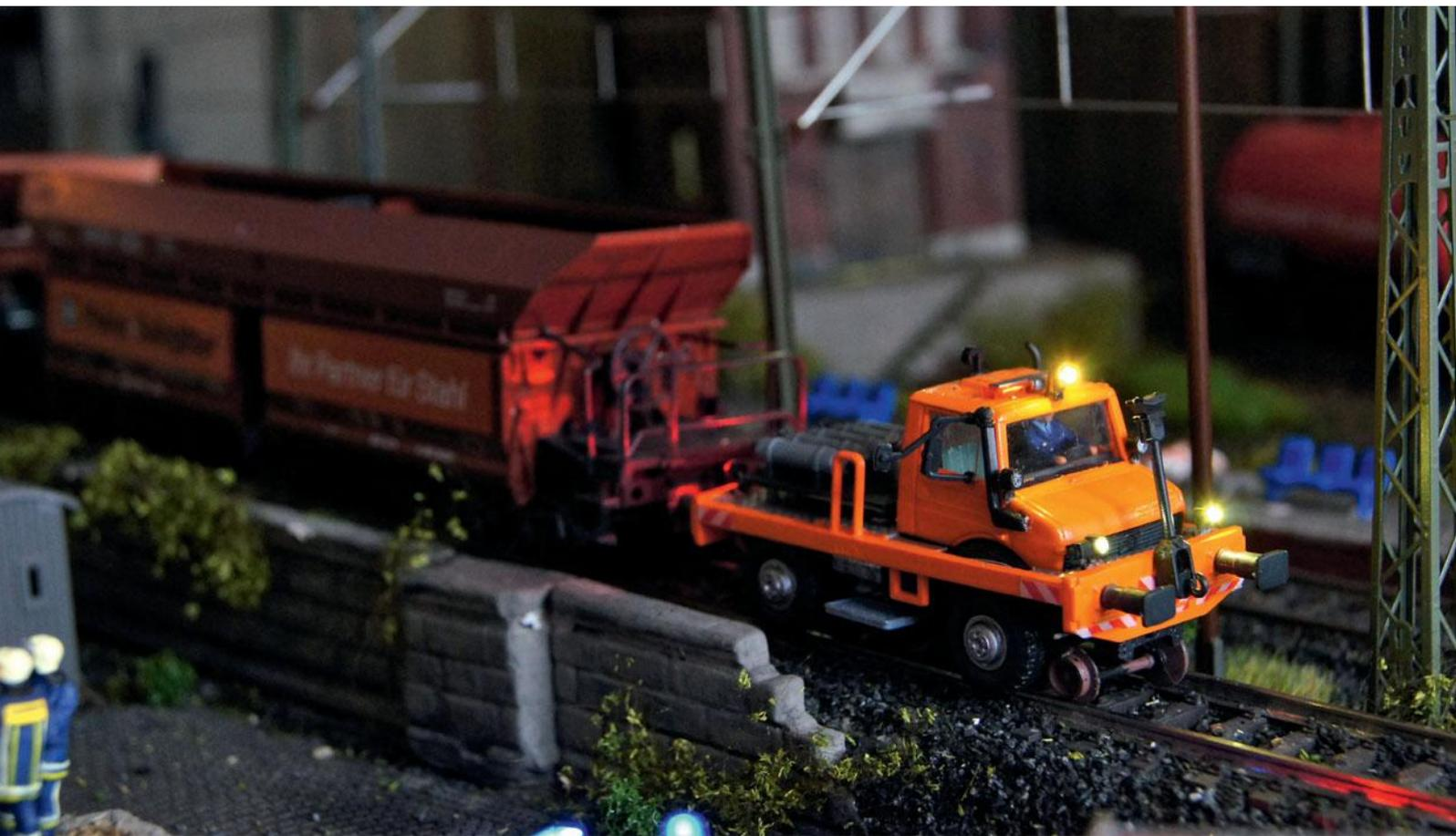
ten) und fasste die Anoden (Pluspol der LEDs) zusammen. Die Kathoden (Minuspole) der LEDs erhielten noch den passenden Vorwiderstand entsprechend der späteren Betriebsspannung. Alle Leitungen führte ich dann unter der Fahrzeugunterseite heraus. Bei späterem Betrieb an einem Wechselspannungstrafo sollte in die gemeinsame Anodenleitung noch eine weitere Diode zum Schutz der LEDs eingebaut werden. Beim Betrieb an einer Gleichspannung kann diese entfallen.
