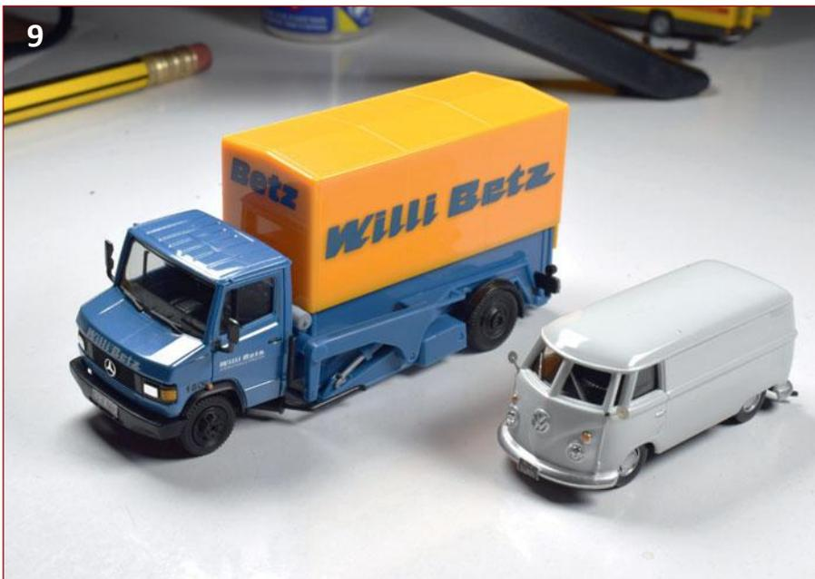
**Bild 5:** Der Blinker über dem Kotflügel wird in einem Gemisch aus Gelb und Orange (Revell 310 und 30) ausgelegt, ebenso die Blinker am Kühler.
