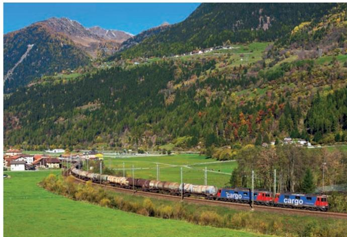
*Für die Bespannung des 542 m langen leeren Kesselwagenzuges 66585 mit einem Gewicht von 728 Tonnen hätte auch eine Re 6/6 ausgereicht. Vermutlich brauchte man aber für eine Rückleistung aus Chiasso eine Re 10/10.*
