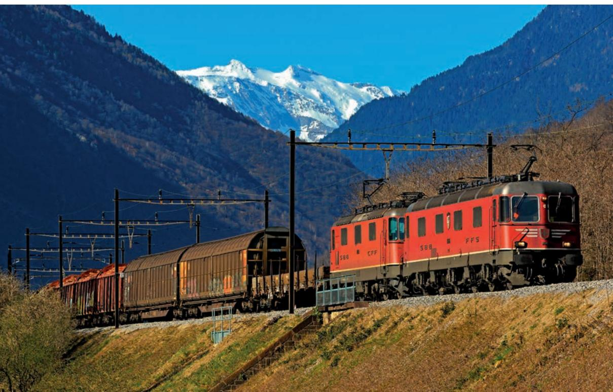
*Rechte Seite: Auch bei den Re 6/6 werden die Anschriften geändert. So erhalten die Loks die lange TSI-Nummer. Die Lokschilder entfallen. An den Frontseiten werden die Loknummern in siebenstelliger Form als 620 xxx-x angeschrieben. Bei den Fahrzeugen im Cargo-Design wurde dies schon beim Neulack so gehandhabt. Die 620 065 wird gleich durch den Strahlloch-Tunnel (39 m) fahren.*
