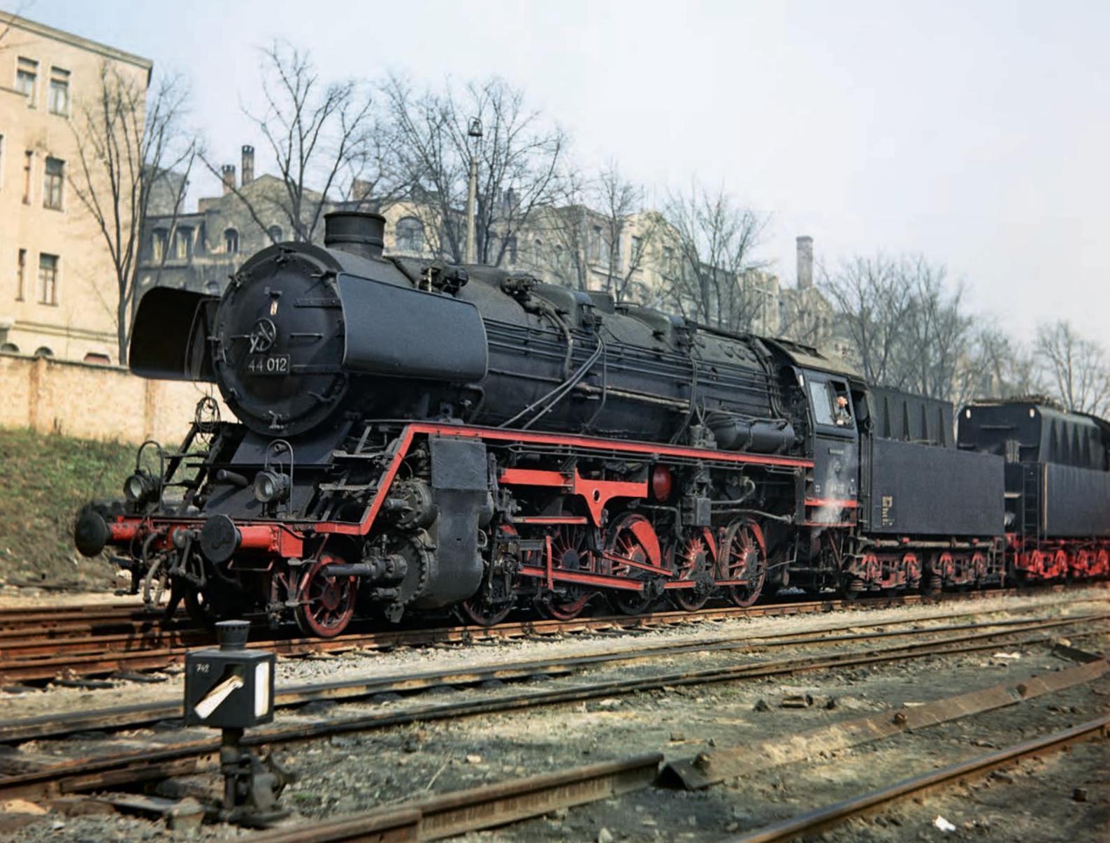
Bis 1961 wurde die 44 012 vom Versuchsamt Halle als Bremslokomotive für leistungstechnische Versuche eingesetzt (April 1958). FOTO: G. ILLNER/SLG. GARN
