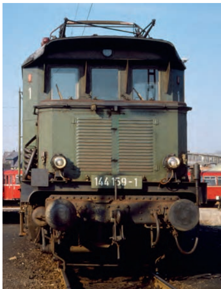
September 1979: Die Loks der Baureihe 144 erhalten eine Hauptluftbehälterleitung für die Türschließeinrichtung von Reisezugwagen.
