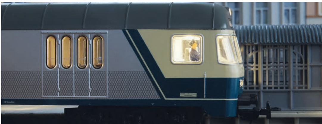
Obwohl das Licht vom beleuchteten Bereich des Steuerwagens etwas durchscheint, bleibt es im Gepäckabteil relativ dunkel. Der Decoder ist dadurch nicht zu sehen.
