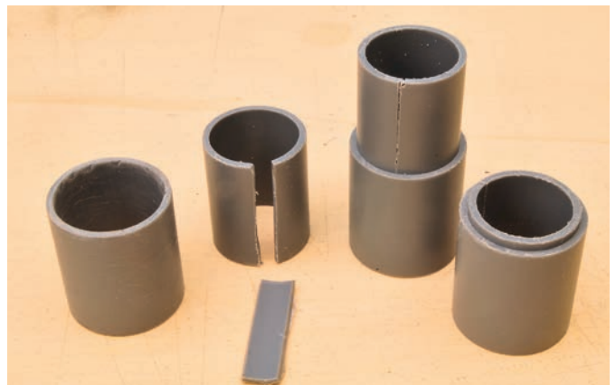
Die Hälfte der Rohre wird aufgeschnitten und in die anderen gesteckt.
