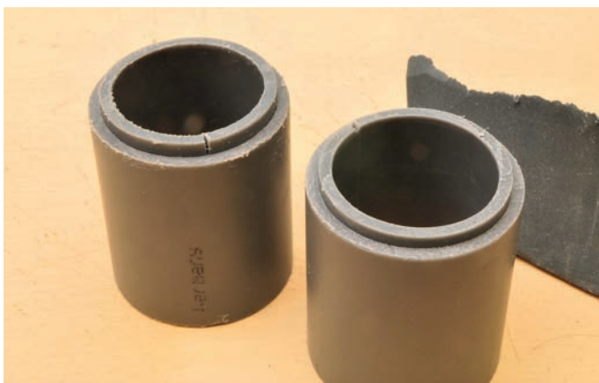
Vor dem Bemalen müssen die Rohrenden saubergeschliffen werden.
