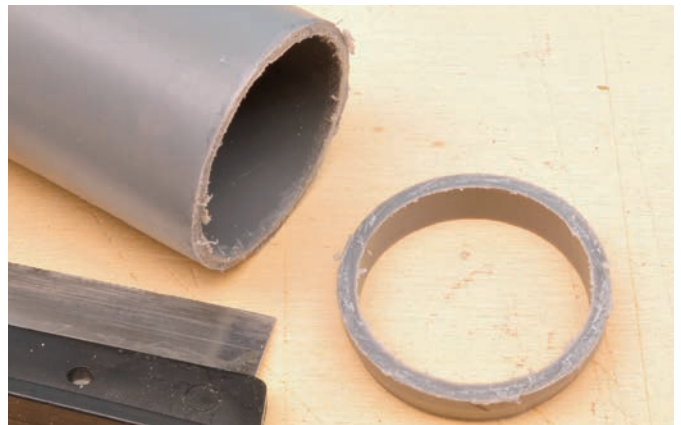
... und an ihm entlang das konische Rohrende abgesägt.
