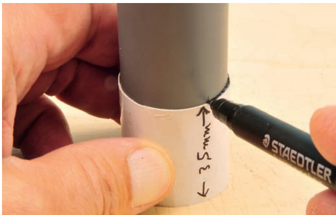
Eine Schablone hilft, die abzusägenden Rohrstücke exakt zu markieren.
