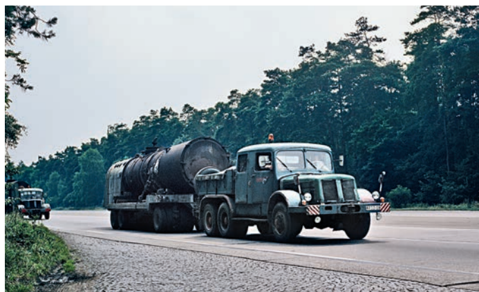
Straßentransport eines Kessels der Baureihe 52 zu einem volkseigenen Betrieb, der ihn für Heizzwecke nutzen wird.
