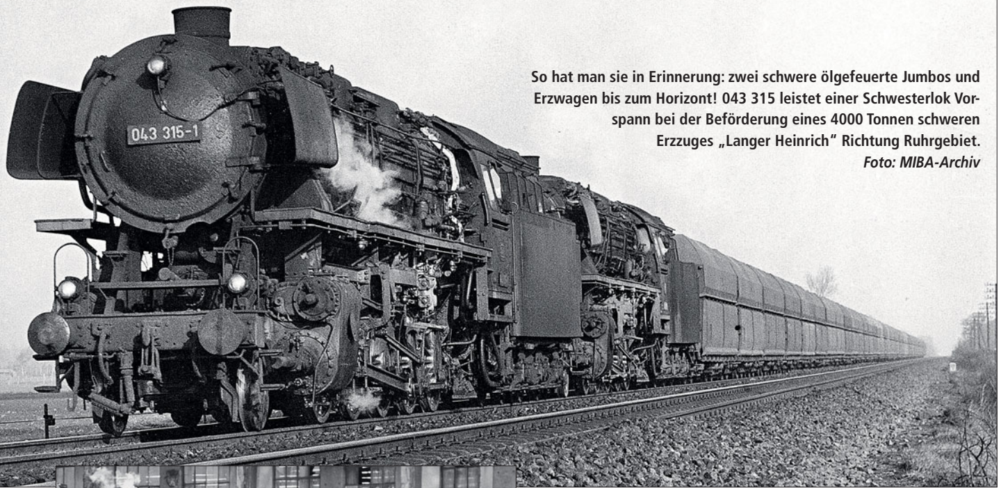
Die ölgefeuerten Loks waren nicht nur am Ölbunker des Tenders zu erkennen. Sie hatten auch zusätzliche Dampfleitungen linksseitig vor dem Führerhaus.
