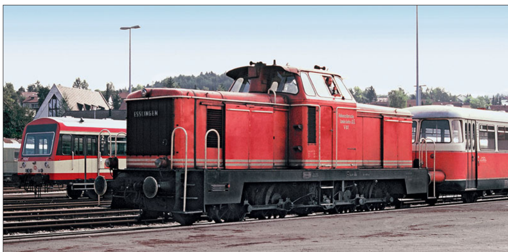
Die von der Maschinenfabrik Esslingen als „Alb-Klasse“ bezeichnete V 81 blieb ein Einzelstück; das vierachsige Fahrwerk mit den Kuppelstangen erinnert an die V 65 der DB. Die beiden Aufnahmen entstanden im August 1994 im Bahnhof Gammertingen (oben) und in Burladingen (links).
