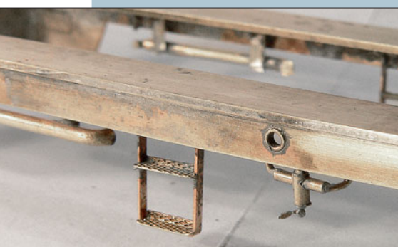
Die Griffstangen am Gehäuse und an der Pufferbohle bestehen aus 0,4 mm dickem Messingdraht. Die Laternen stammen von Weinert.
