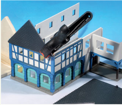
Das neue Bauteil wird aus einer Dachschieferplatte zurechtgeschnitten und entgratet.
