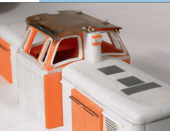
Die Griffstangen am Gehäuse und an der Pufferbohle bestehen aus 0,4 mm dickem Messingdraht. Die Laternen stammen von Weinert.
