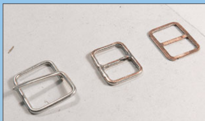
Die mittleren Fensterrahmen entstanden aus Messingdraht, der zurechtgebogen, verlötet und danach flach geschliffen wurde.
