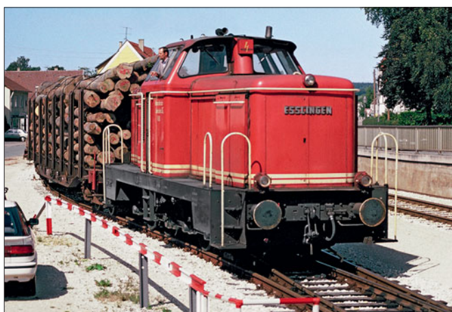
Die von der Maschinenfabrik Esslingen als „Alb-Klasse“ bezeichnete V 81 blieb ein Einzelstück; das vierachsige Fahrwerk mit den Kuppelstangen erinnert an die V 65 der DB. Die beiden Aufnahmen entstanden im August 1994 im Bahnhof Gammertingen (oben) und in Burladingen (links).
