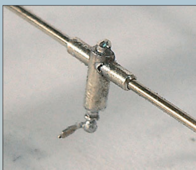
Die noch fehlenden Details am Rahmen. Der Wasserabscheider wurde aus Messingröhrchen in unterschiedlichen Durchmessern zusammengesetzt. Für die Trittstufen unter dem Führerhaus wurde das fein geätzte Riffblech von Weinert verwendet.
