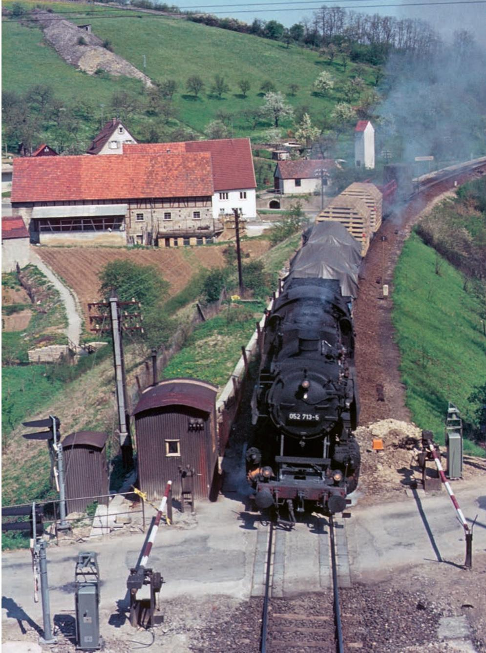
Was für ein Kleinod: Bahnübergang in Niederstetten mit Wellblechbuden, Kleinschranken, Endmast mit Zuführungsleitung und beidseitiger Abspannung sowie Andreaskreuzen mit doppelten Blinkleuchten. Da wird die Crailsheimer 052 713 mit ihrem Güterzug nach Crailsheim fast zur Nebensache.
