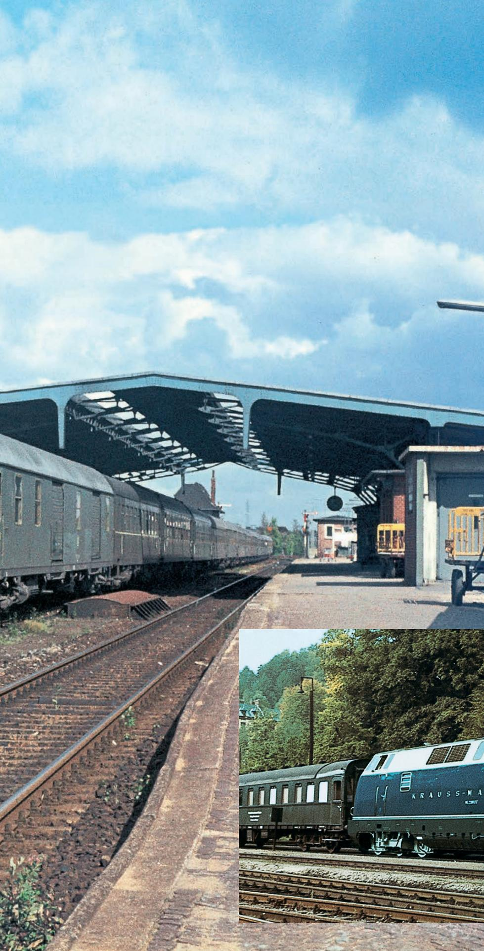
**Als sechssachsige Vorführlok von Krauss-Maffei wurde die spätere V 300 001 im August 1957 in Betrieb genommen. Mit dem Einbau stärkerer Motoren stieg die Leistung auf beachtliche 3000 PS. Die Maschine bewährte sich zwar, blieb jedoch ein Einzelstück**
