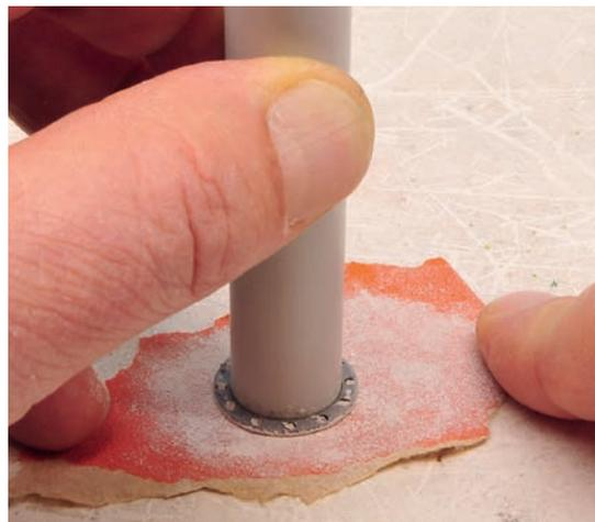
Innen: Um zu verdecken, dass der Flanschring im Modell auf das Rohr gesetzt wird, anstatt davor, wird das Rohrende mit verdünntem Acrylspachtel bestrichen.
