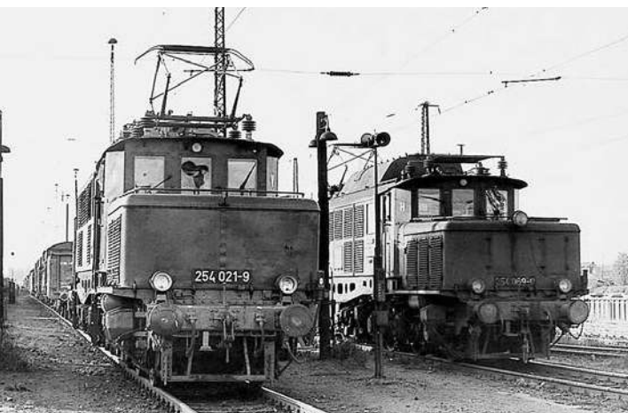
Die 254 069 baute man 1981 für den Abdruckdienst in Zwickau um (Funkplatte am Dach des hinteren Führerstands). Am 14. November 1982 kam die 254 021 II (ex 254 078) daneben zufällig vorbei.
