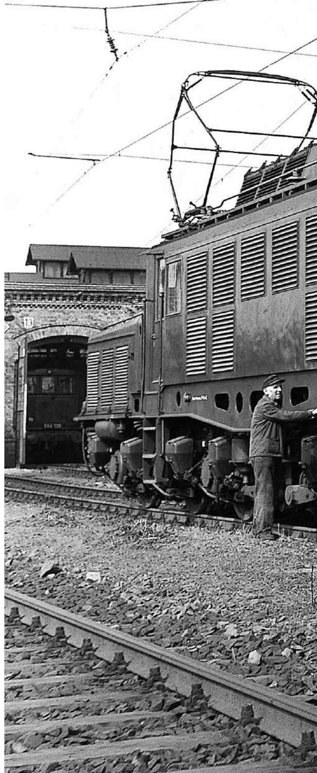
Die 254 069 baute man 1981 für den Abdruckdienst in Zwickau um (Funkplatte am Dach des hinteren Führerstands). Am 14. November 1982 kam die 254 021 II (ex 254 078) daneben zufällig vorbei.
