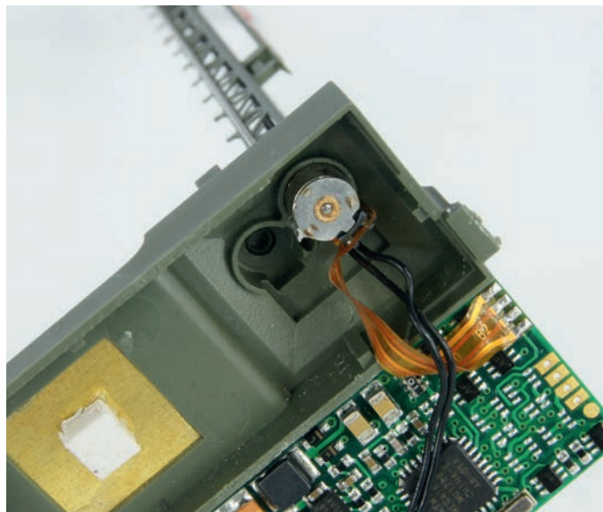
Der Signalfuß mit ausgeklapptem Decoder. Oben unterhalb des Masts der winzige Motor.
