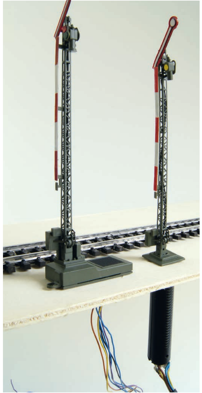
Der Vergleich zeigt, wie weit die alten Antriebe unter die Anlagenplatte ragten. Bei den neuen sind es nur noch die Kabel.
