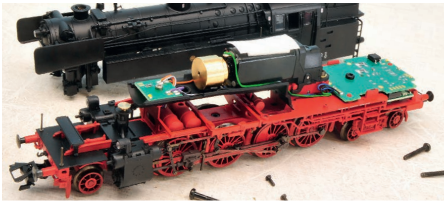
Bei abgenommenem Gehäuse ist nur wenig zu sehen. Ganz hinten unter der Platine versteckt sich der Decoder, darüber im Kohlenkasten ist der Lautsprecher untergebracht.
