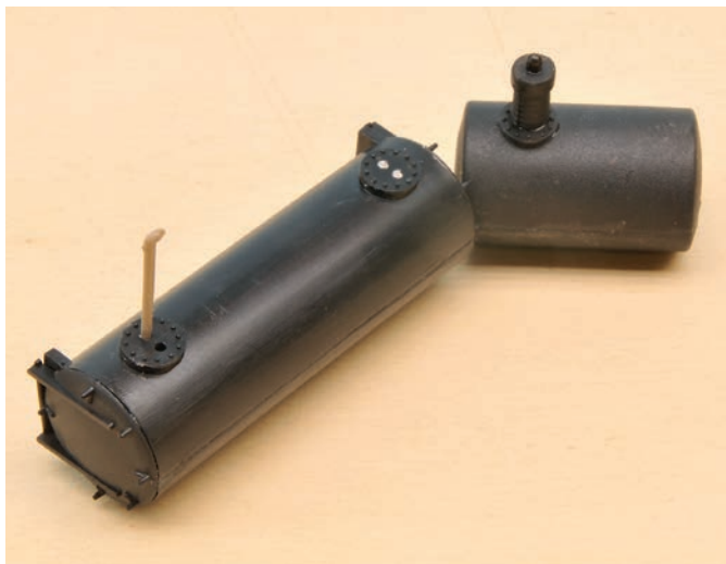
Die Öffnungen in den Deckeln werden mit Rundstäben verschlossen.
