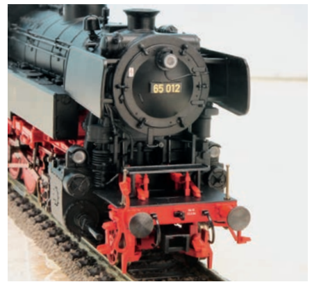
Die Stirn der Lok mit montierten Zurüstteilen an der Pufferbohle.
