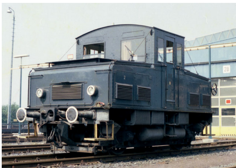
Ganz oben: Der 515 505 wurde 1990 zum antriebslosen Stromschienen-Enteisungswagen 732 001 umgebaut. Zwei Köf III sorgten für die Zugkraft. Mitte: Die Akkulok 382 001 rangiert im April 1997 in Ohlsdorf. Unten: Bis Mitte der 1980er Jahre versah diese Akkulok von Jung (gebaut 1929) Rangierdienst. Fotos: M. Werning (2), B. Wiesmüller
