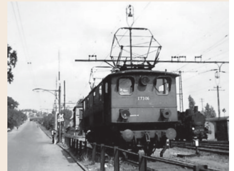
Altona Kai: Die 1925 in Dienst gestellte E 73 06 besaß als Besonderheit einen Antrieb der Bauart „Westinghouse-Quill-Drive“. Foto: Slg. Kobschätzky
