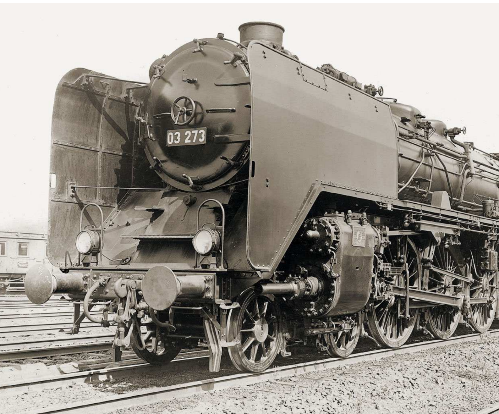
Die 03 273 besitzt Druckausgleich-Kolbenschieber und Scherenbremsen an den Kuppelradsätzen (September 1937). Foto: C. Bellingrodt/Slg. Wunschel
