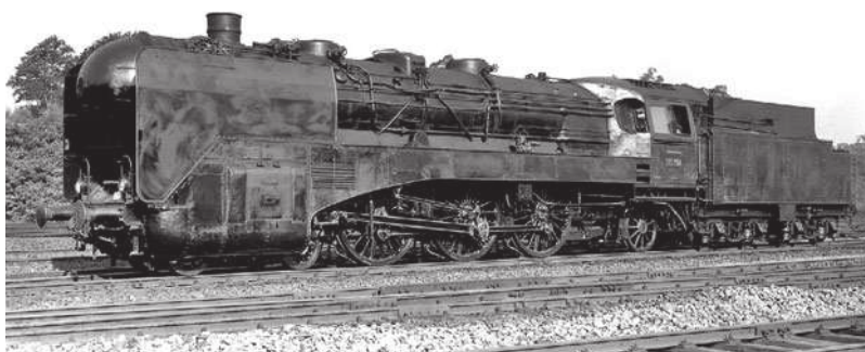
03 154 mit zurückgeschnittener Triebwerksverkleidung. Fotos: H. Maey/Eisenbahnstiftung (2)
