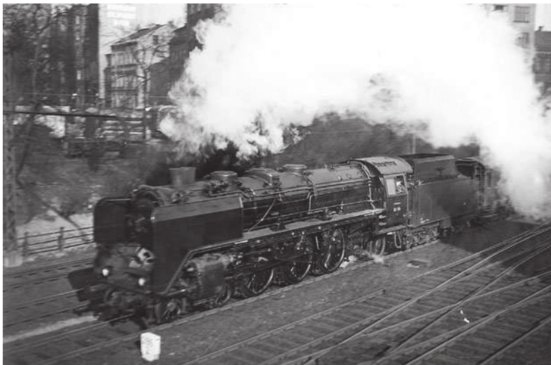
03 194 mit Doppelblasrohr (3. Ausführung) vor D 6 aus Berlin in Hamburg, fotografiert 1939.
