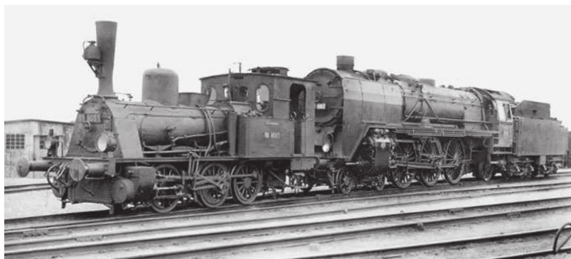
89 8061 mit 03 082, die eine Abdampfstrahlpumpe besaß. Foto: C. Bellingrodt/Slg. Gerhard UNTEN: 03 156 mit nach hinten verlegten Pumpen (ab 03 123). Foto: RVM/Slg. Gerhard
