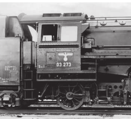
03 273 erhielt im Lieferjahr eine Indusi. Foto (1937): C. Bellingrodt/Slg. Schwarz
