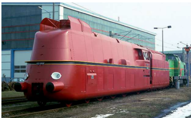
Der Torso der 03 002 erhielt 2000/2001 eine Stromlinienverkleidung. Fotos: H. Dörschel (2)
