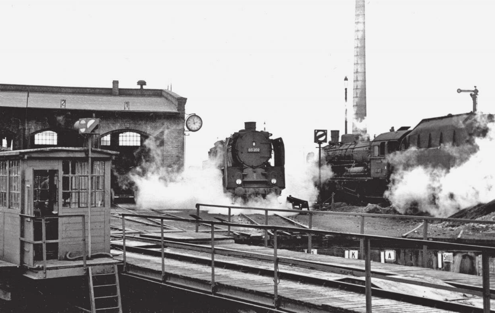
03 202 (mit Behelfs-Rauchkammertür) und die kohlenstaubgefeuerte 17 1077 im Bw Leipzig Hbf West (August 1956). Foto: G. Illner/Eisenbahnstiftung
