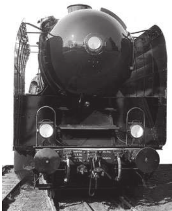
03 154: Der Rauchkammertür wurde eine parabolische Haube vorgesetzt.
