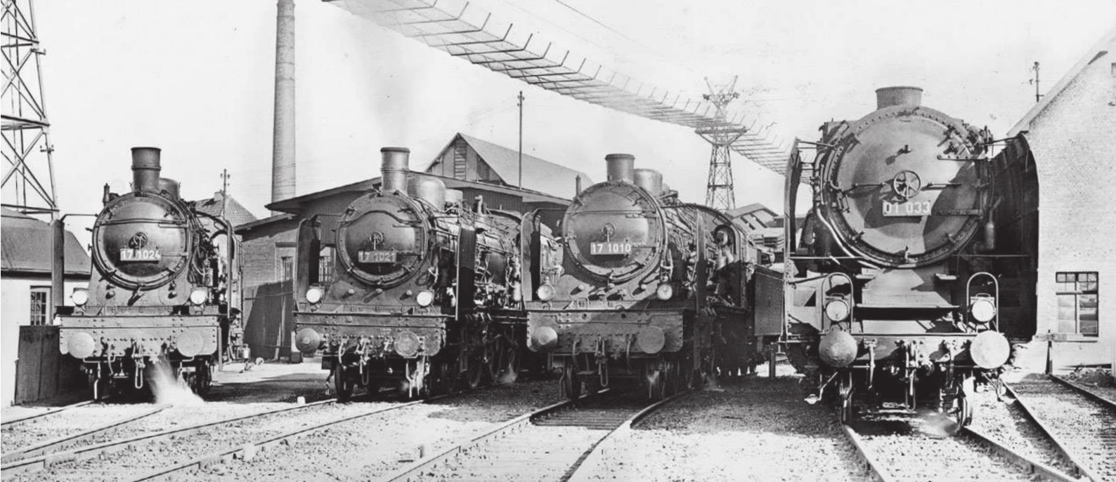
Im Vergleich mit der preußischen S 10' wirkt der Kessel der 01 geradezu gigantisch (Bw Köln Bbf, 24. März 1933). Fotos: C. Bellingrodt/Slg. EJ (2)
