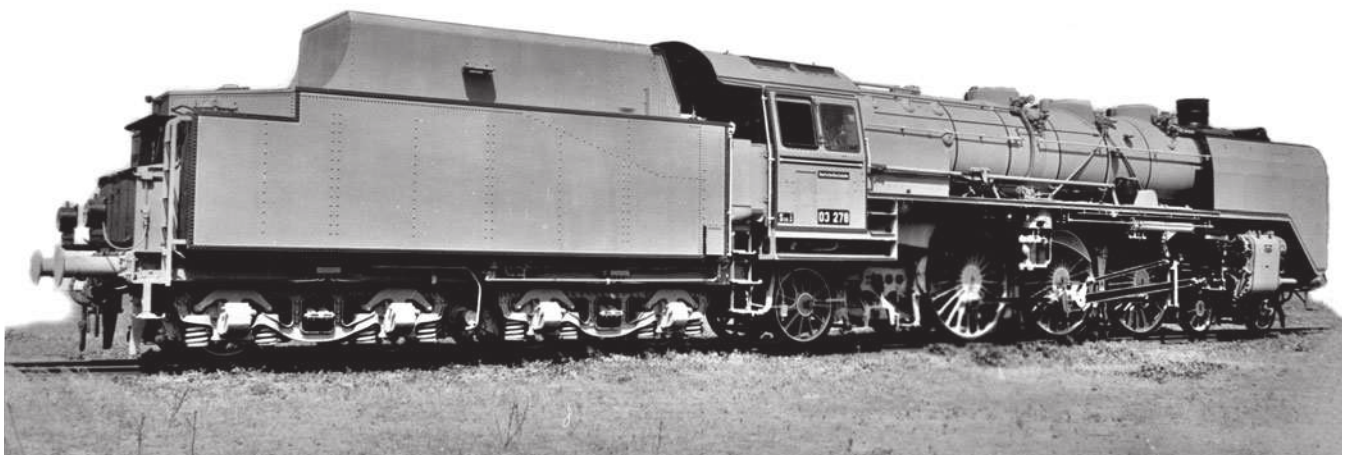
03 278 im Fotografieranstrich: Sie ist mit einem Tender 2'2' T 32 „neuerer Bauform“ gekuppelt. Werkfoto Borsig/Bildarchiv der Eisenbahnstiftung
