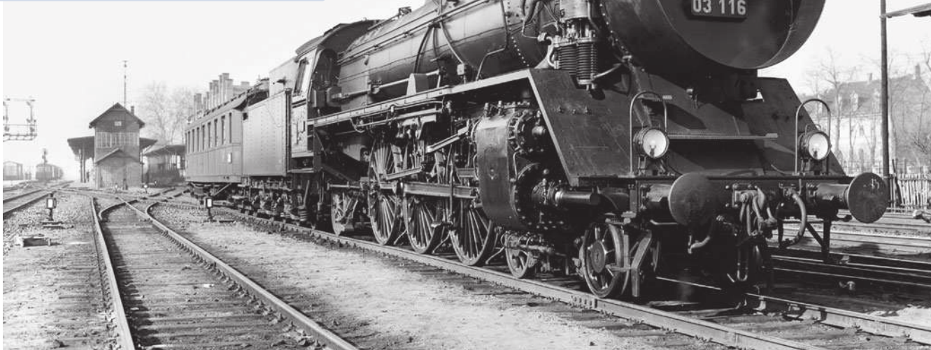
Die mit einem Windfangkasten ausgerüstete fabrikneue 03 116 wurde im Mai 1933 in Brandenburg Reichsbahn porträtiert. Foto: Slg. Asmus
