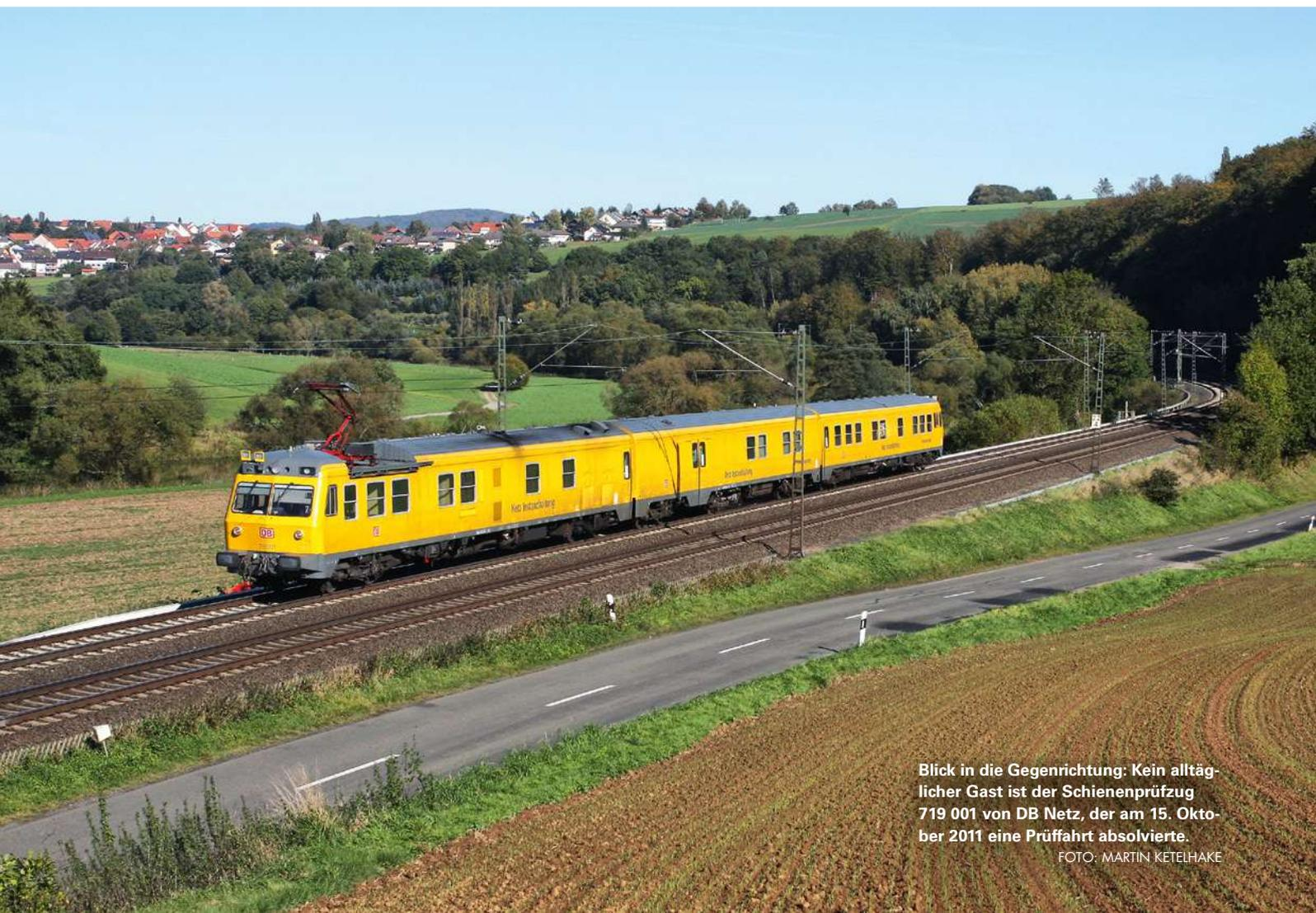
Blick in die Gegenrichtung: Kein alltäglicher Gast ist der Schienenprüfzug 719 001 von DB Netz, der am 15. Oktober 2011 eine Prüffahrt absolvierte.
