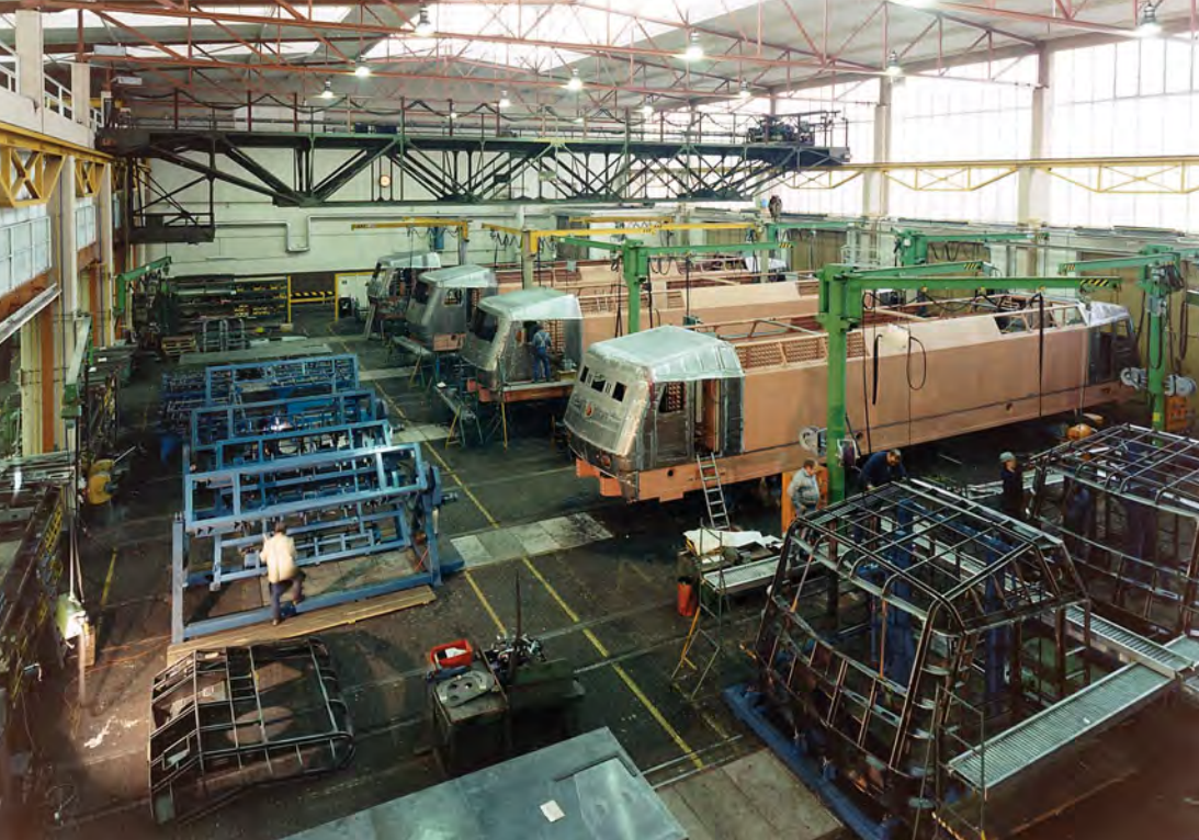
Die grundierten Seitenwände und Untergestelle fertigte Thyssen-Henschel, die hier noch blanken Führerraumstrukturen Krauss-Maffei in München. Werkfotos Krauss-Maffei/Slg. Ritz (3)
