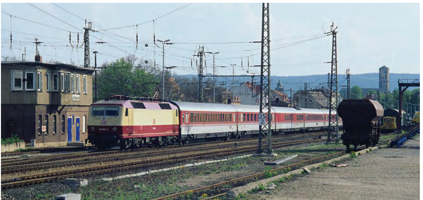
Die 120 003 bekam Drehgestelle mit radial einstellbaren Radsätzen: IC 706 „Bertolt Brecht“ in Jena Saalbahnhof (2. Mai 1996). Foto: O. Buhler
