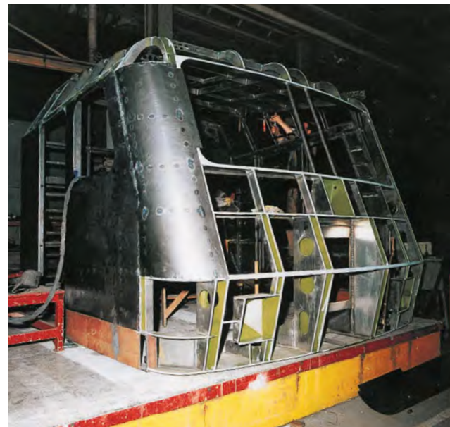
Links oben: Führerraum 2 der 120 002. Rechts oben: Um sie für Tempo 200 zu ertüchtigen, erhielten die 120.0 die Einrichtungen der Linienzugbeeinflussung: Die senkrechte Säule zeigt die Zielentfernung an. Darunter: Führerraumstruktur im Rohbau. Fotos: DB (3)
