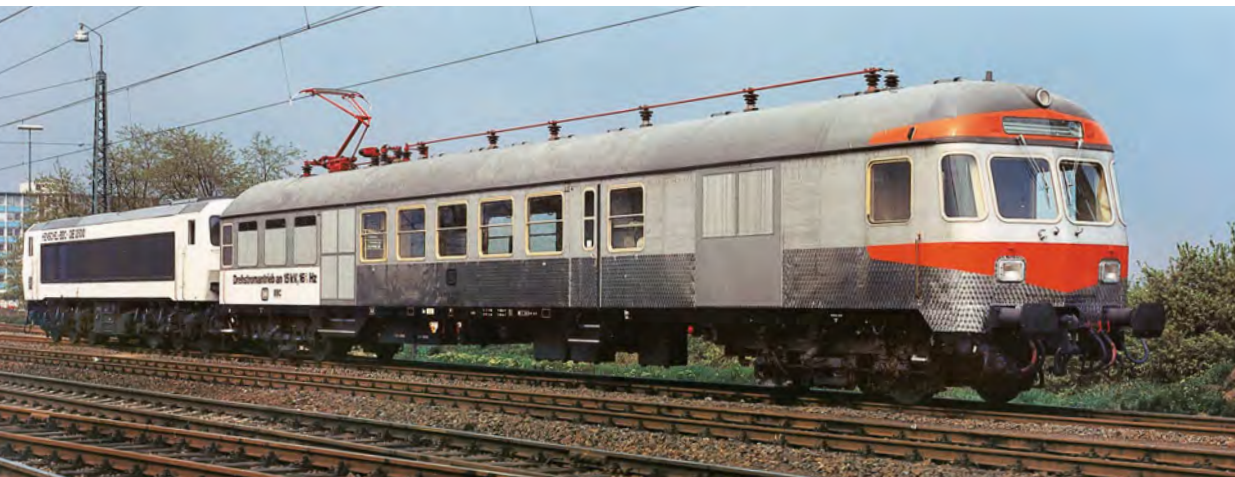
Fotos oben: 1974 wurde die 202 002 mit einem Steuerwagen der Bauart 740.2 fest gekuppelt, um die Versorgung mit Strom aus der Oberleitung zu erproben (Mannheim Hbf, 15.1.1975). Fotos: K.-H. Buchholz (3)
