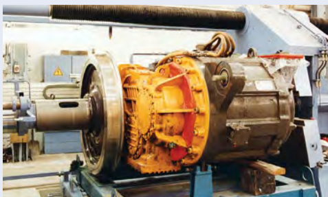
Antrieb auf der Radsatzpresse beim Aufpres-sen des Rades neben dem Getriebe (1995).
