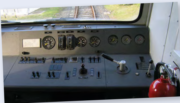
Führerpult der sechsachsigen 202 002, deren Leergewicht 80 t betrug. Die vierachsige 202 003 wog 76 t. Foto: J. Hörstel
