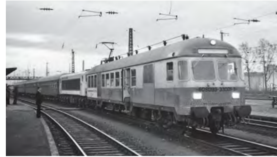
Fotos oben: 1974 wurde die 202 002 mit einem Steuerwagen der Bauart 740.2 fest gekuppelt, um die Versorgung mit Strom aus der Oberleitung zu erproben (Mannheim Hbf, 15.1.1975). Fotos: K.-H. Buchholz (3)
