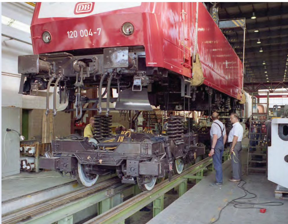
Aufsetzen des umgebauten Lokkastens auf die neuen Drehgestelle (1992).
