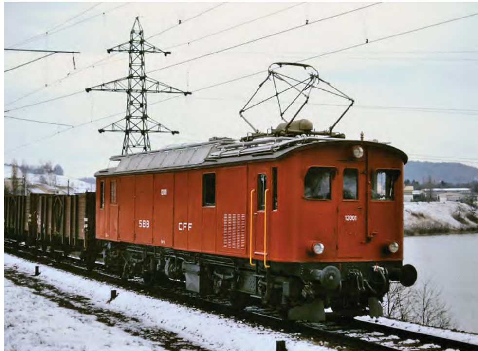
Schweizer Versuchslokomotive mit Umrichtertechnik: Be 4/4 Nr. 12001 der SBB – Umbau aus einem Gepäcktriebwagen – auf Probefahrt bei Wettingen (12.2.1973). Fotos: B. Studer (3)
