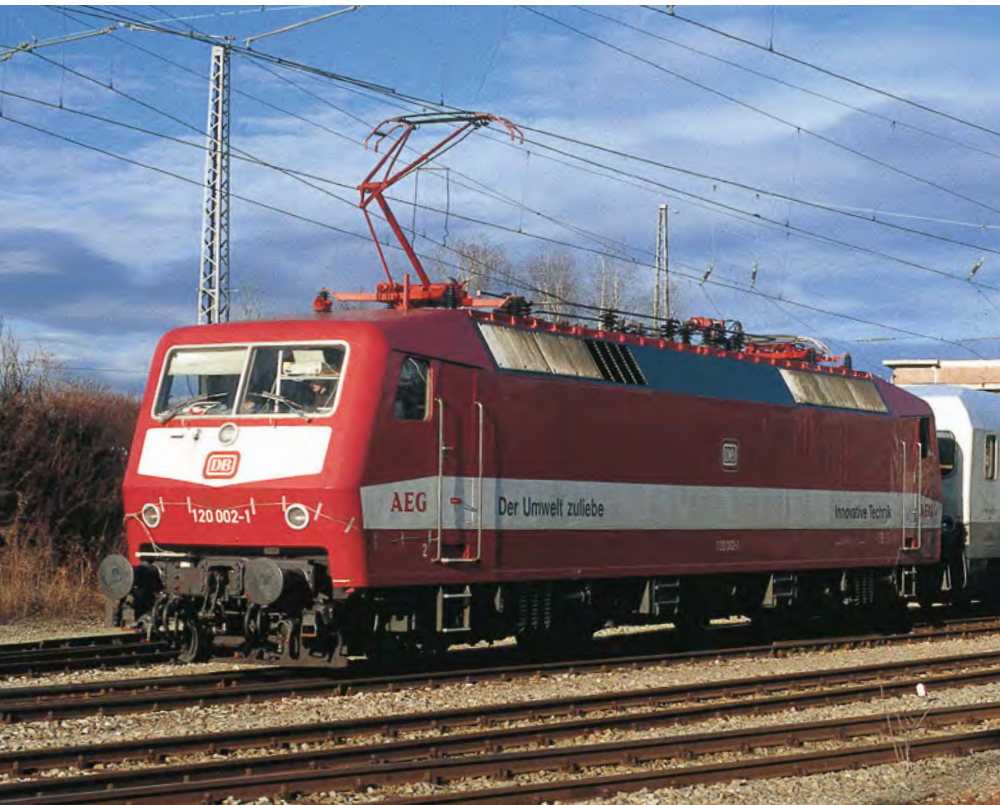
Die 120 002 erhielt u.a. wassergekühlte Stromrichter (5.1.1994). Foto: H. D. Andreas
