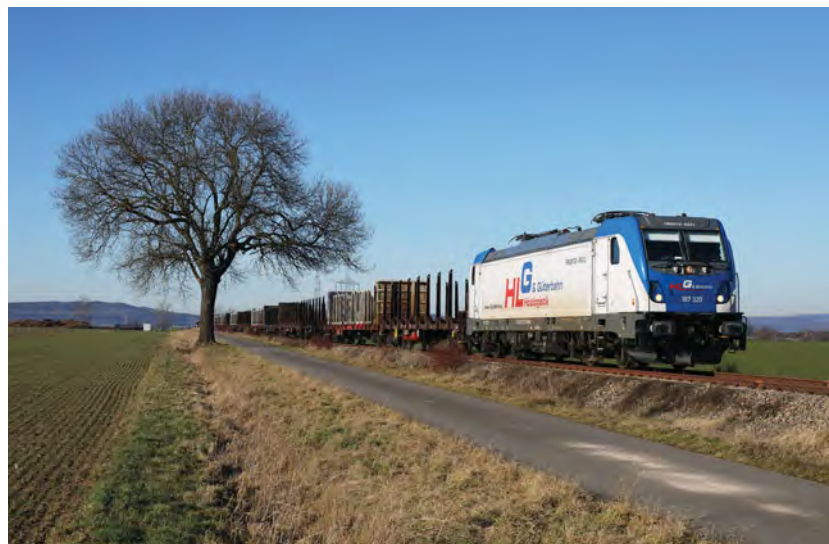
Ellok mit Last-Mile-Dieselmotor: HLG-187 320 bei Grohnde (14.2.2019).
