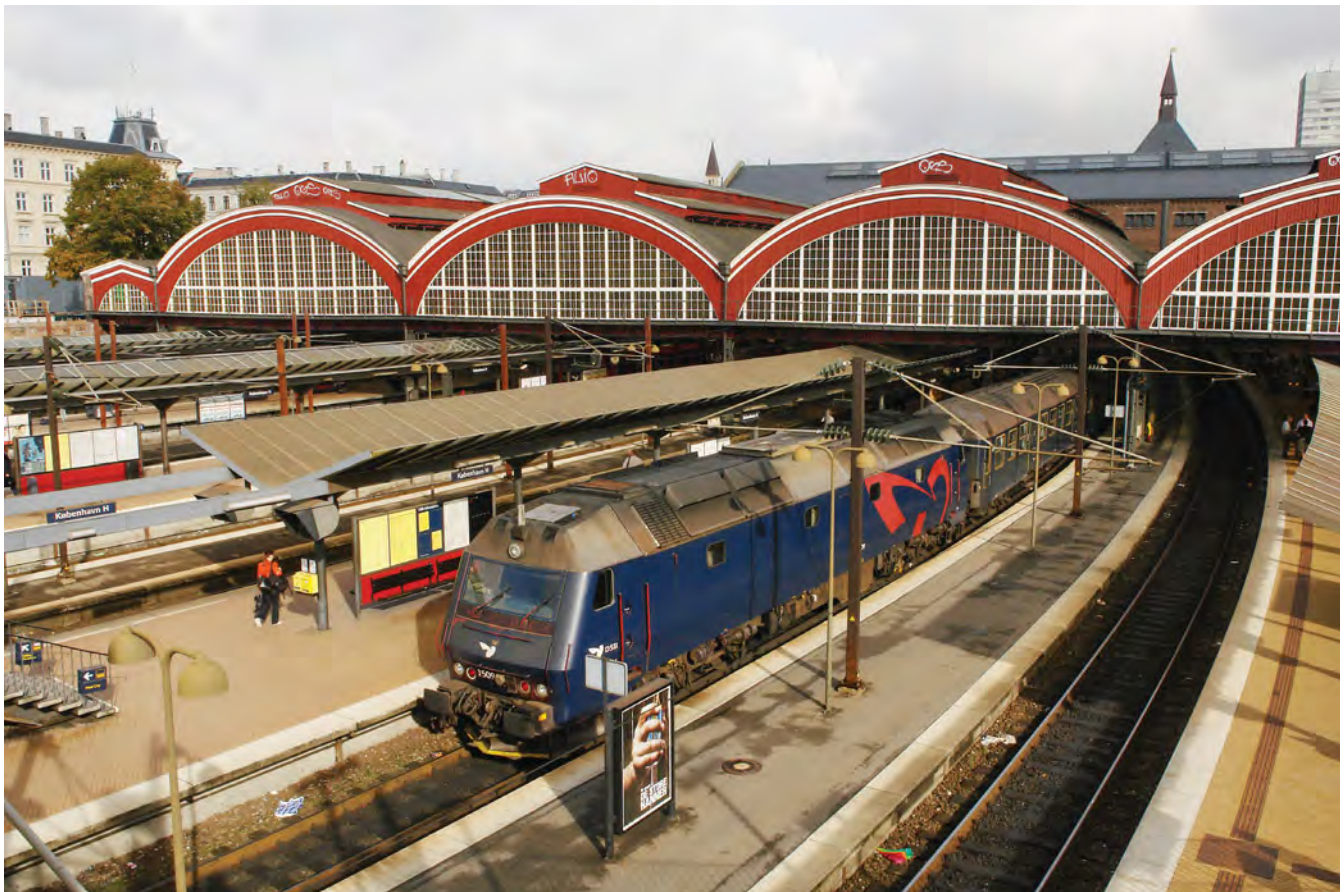
In den Jahren 1981 bis 1985 erhielten die Dänischen Staatsbahnen DSB 37 Exemplare der Baureihe ME. Hinsichtlich der Antriebsanlage und weiten Teilen der Elektrik sind die ME baugleich mit den norwegischen Di4 (Kopenhagen Hbf, 8.8.2008). Fotos: J. Hörstel (3)
