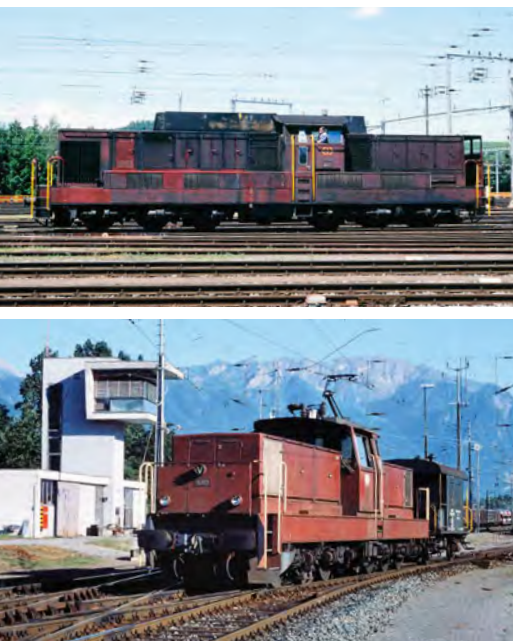
Die Ee 6/6 II der SBB von 1980 ist eng verwandt mit der Am 6/6 (Buchs SG, 1985). Darüber: Dieselelektrische Am 6/6 der SBB, geliefert 1976 von Henschel (Lausanne, 1997).
