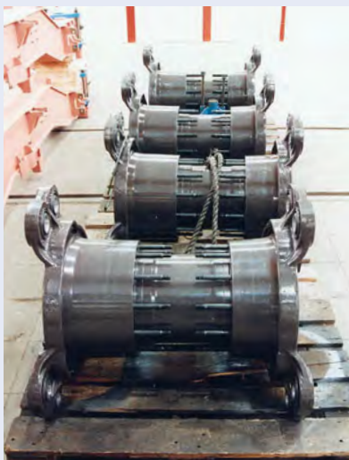
Die vier neuen Antriebshohlwellen vor der Montage der Bremsscheiben (1995).
