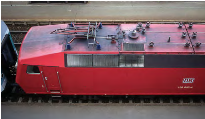
Die 120 002 erhielt u.a. wassergekühlte Stromrichter (5.1.1994). Foto: H. D. Andreas
