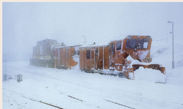
Eine Diesellok der Baureihe 199.8 mit einem zum Schneepflug umgebauten NWE-Güterwagen und der Schneeschleuder LSF 071 (19.11.2004).
