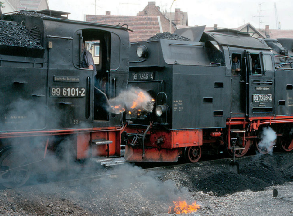
Der Rost der 99 6101 ist verschlackt, das Feuerbett wird geputzt (Wernigerode, Juni 1990). Foto: C. Gussmann
