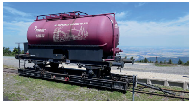
Ein normalspuriger Kesselwagen dient während der Sommerperiode auf dem Brocken als Löschwasserreserve (2018). Foto: V. Emerleben
