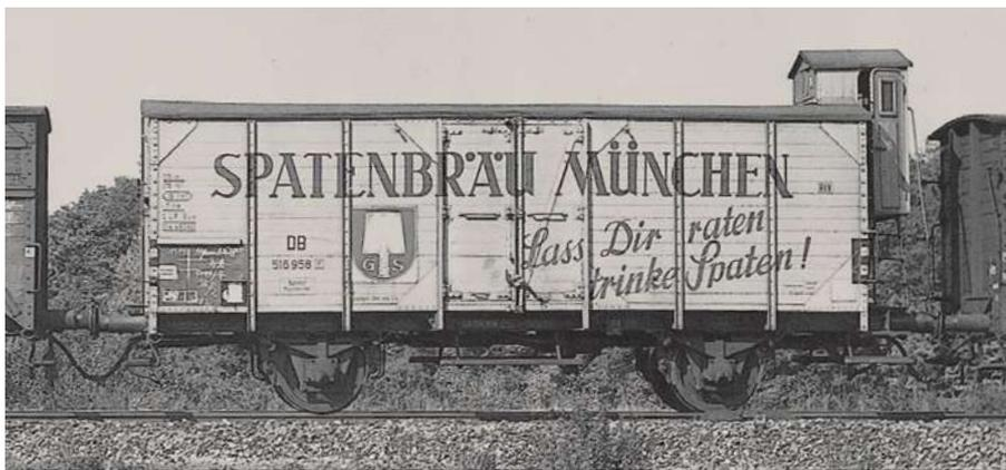
Bierwagen Nr. 516 958 [P] trägt am 9.9.1959, aufgenommen bei Fulda, noch sein Bremserhaus. Der Wagenkasten ist mit Knotenblechen versteift, der rechte Türflügel trägt eine Diagonalversteifung.
