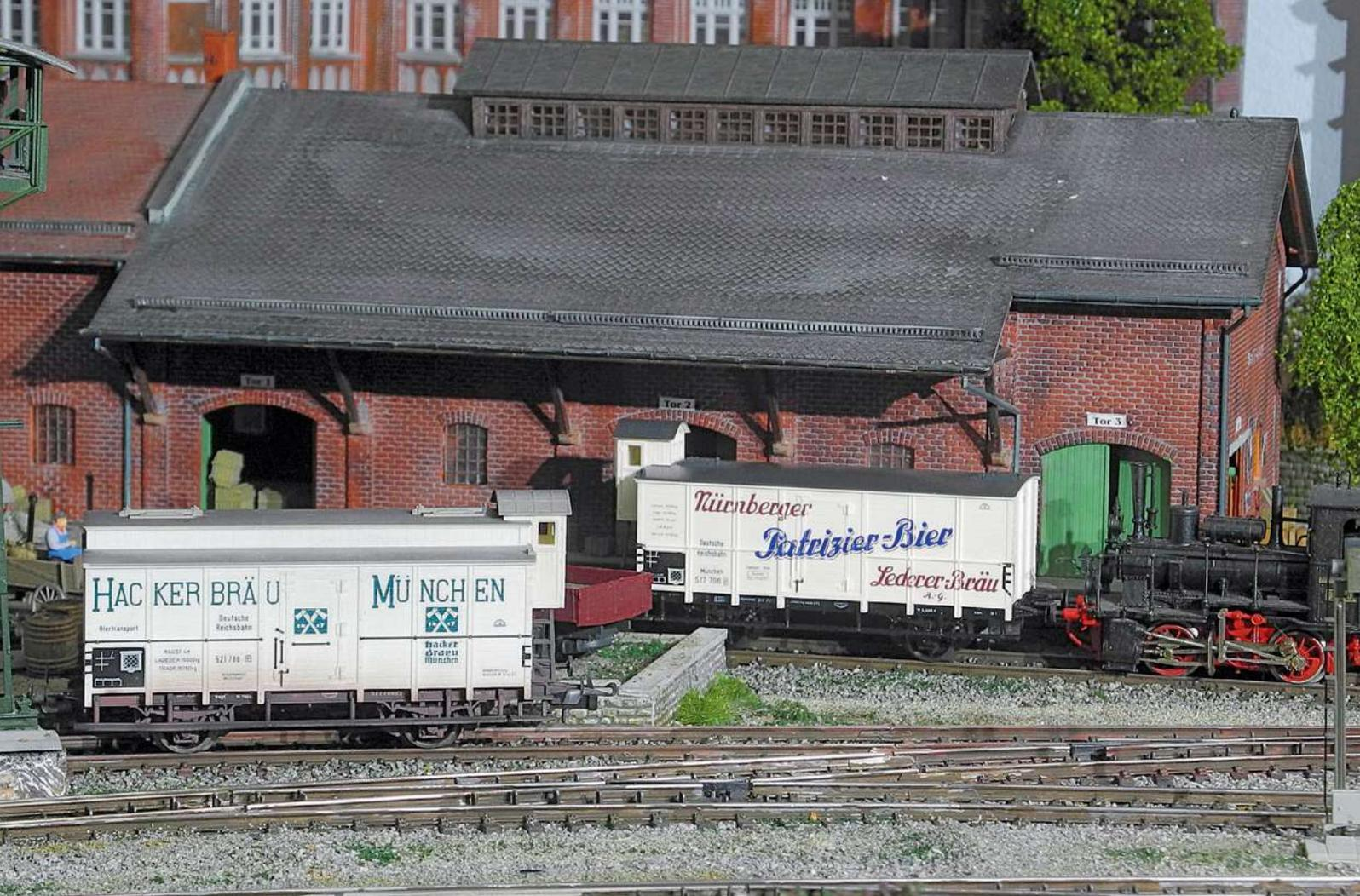
Zwei ehemalige Bayern von Trix in einem Güterbahnhof. Der Münchner ist mit Eiskästen auf dem Dach ausgestattet, die ein besonders großes Volumen aufweisen. Solche Wagen wurden vornehmlich auf langen Strecken eingesetzt. Beide schon älteren Modelle sind weitgehend vorbildgetreu.
