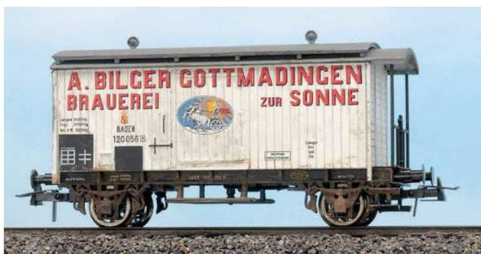
Bierwagen Schweizer Bauart aus Baden (gealtert). Bis auf die fehlenden seitlichen Griffstangen und Laufbretter sowie die nicht epochengerechten Hülsenpuffer entspricht das Liliput-Modell dem Vorbild.
