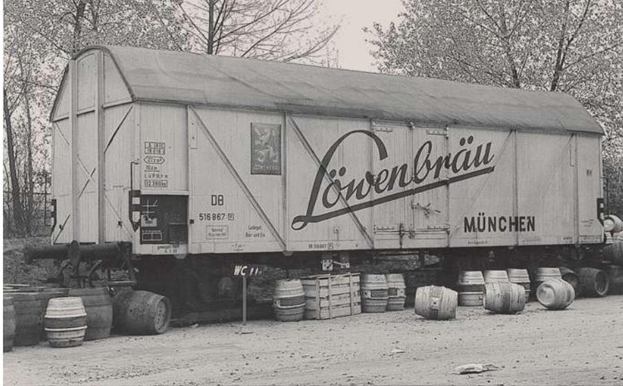
Seine Herkunft aus einem Universalkühlwagen Ths 42 „Berlin“ kann der Wagen mit der Nr. 516 867 [P], aufgenommen am 3.5.1963 in Hannover, nicht leugnen; allerdings fehlen die Eisluken in dem für diese Bauart typischen trapezförmigen Dach. Umringt von (leerem) Ladegut, zeigt der Wagen an der Stirnwand Diagonalszugbänder zur zusätzlichen Versteifung.
