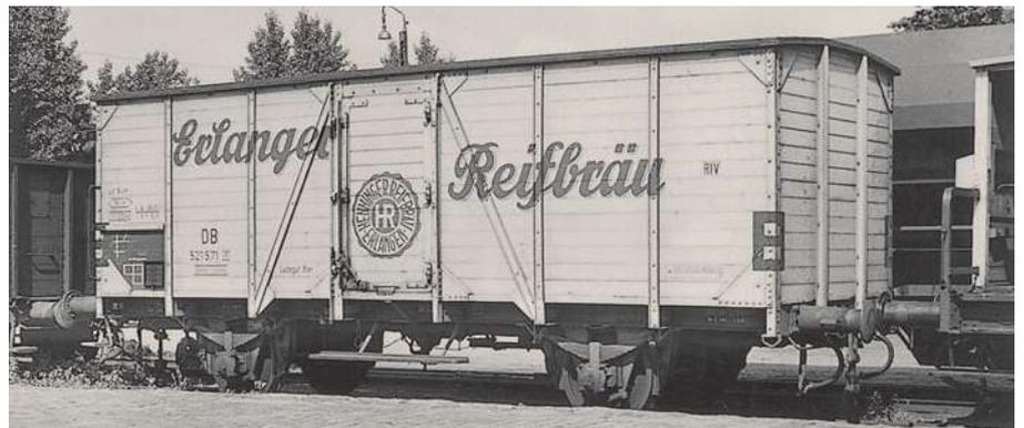
In ausgezeichnetem Erhaltungszustand zeigt sich dieser Bierwagen Nr. 521 698 [P], aufgenommen ebenfalls im Jahr 1963 in seinem Heimatbahnhof Nürnberg Nord. Von dem oben abgebildeten Wagen unterscheidet er sich durch das Wärmeschutzdach, die Eisluken in den Endfeldern und die fehlenden Diagonalversteifungen.
