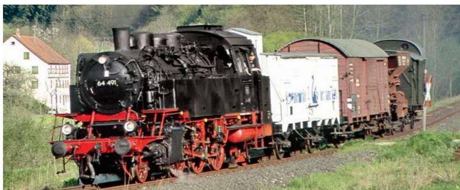
Falschbier: Fahrzeuge wie der „Schwanenbräu“-Wagen der Dampfbahn Fränkische Schweiz sind bei Museumsbahnen beliebt. Schiebetüren und Lüftungsöffnungen verraten aber den schnöden G 10-Güterwagen hinter der schmunzigen Dekoration. Foto: Gudrun Höllerer
