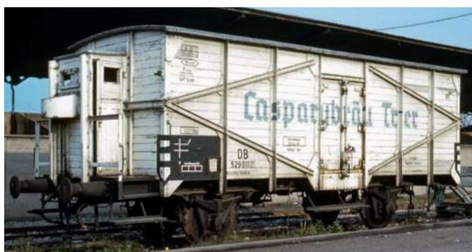
Ein in den 20er-Jahren von der EVA aufgearbeiteter Typ mit stehendem Bremserhaus und massiven Verstärkungsprofilen. Foto: Ulrich Hesse, Slg. Carstens.
