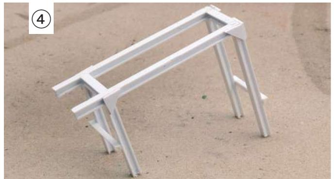
Die Stahlkonstruktion des Ladegerüsts
