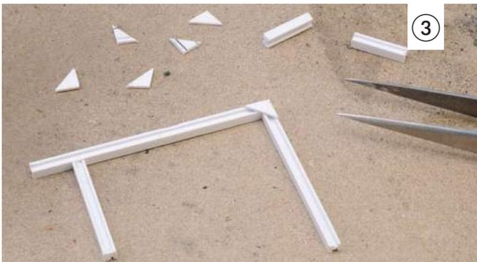
Kleine Winkel versteifen die Ecken der Kunststoffprofil-Konstruktion.
