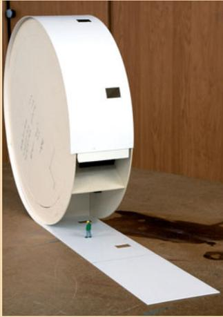
Links: Die aus Bristol-Karton zuge-schnittene Außenwand des Rund-eindickers wird um die Finnapppe-Innenkonstruktion gewickelt.
