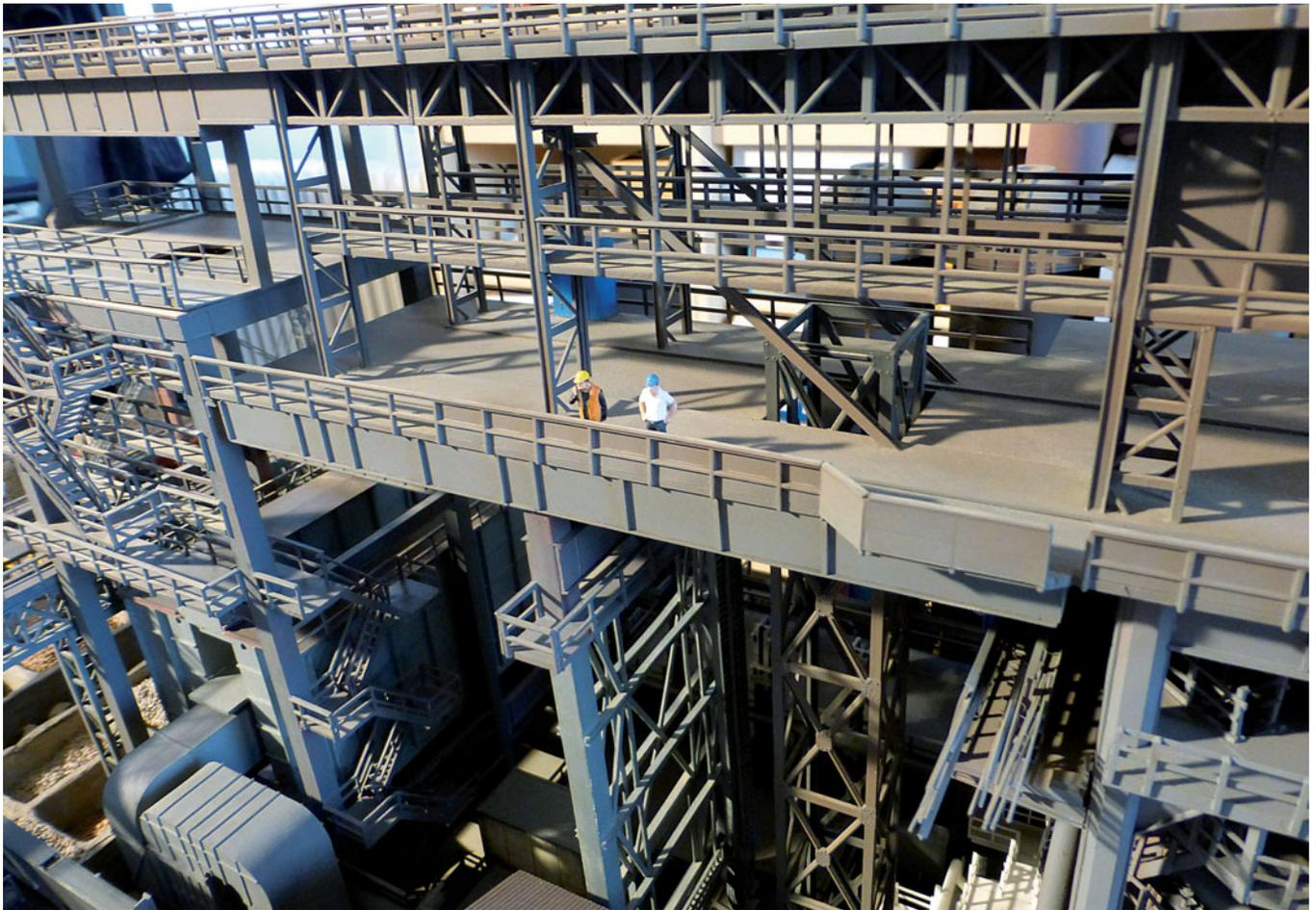
Kontrollgang auf der Gichtbühne. Auch hier fehlen überall noch Details, wie z.B. die Absturzsicherung am Schacht für die Gichtkübel.
