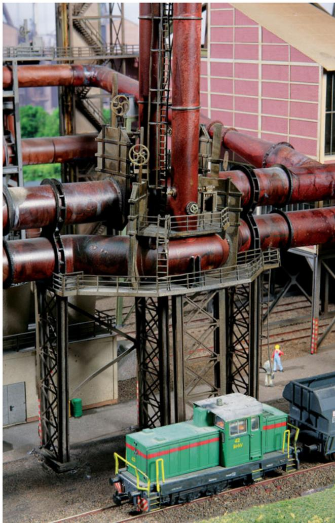
*Der untere Teil der Gasfackel. Hier sieht man sehr schön die großen Schieber zum Öffnen und Schließen der angeschlossenen, hier...*
