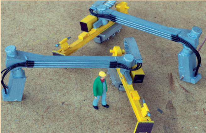
Die schiefe Aufhängung der Stopmaschinen wird von den Stichloch-Bohrmaschinen noch weit übertroffen. Diese müssen beim Schwenken erst über die Stopmaschinen hinweg und dann in die Abstichrinne eintauchen, was durch schräge Lagerung und schiefwinklig angebrachte Drehachsen erreicht wird.
