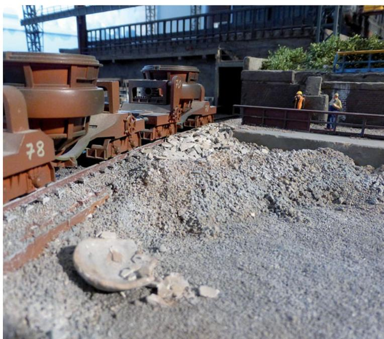
*An der Schlackegrube. In der Bildmitte häufen sich die Scherben der Schlackekrusten, die nach dem Abguss häufig mit Wasserdruck aus den Pfannen geschlagen werden müssen.*
