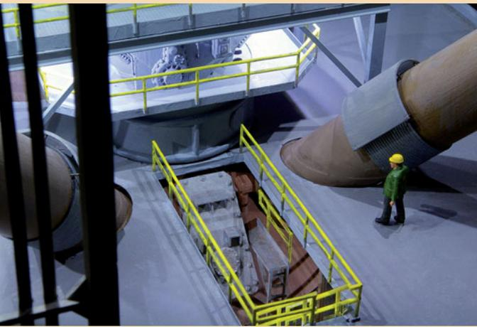
Links: Gichtbühne mit Zugang zum Drehschurren-Wartungsdeckel. Da musste ich erst mal lernen, was eine Drehschurre ist ...
