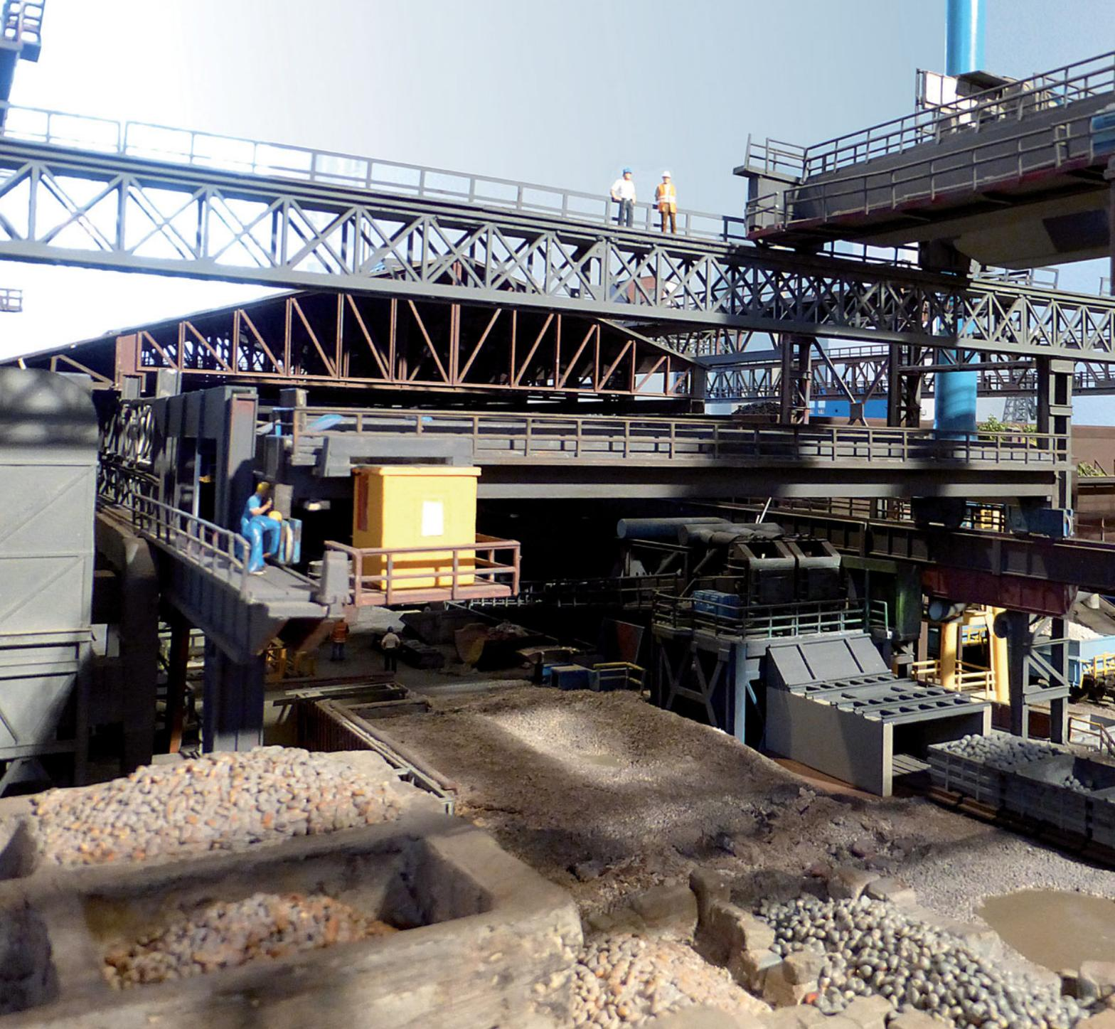
Ein Blick auf die Roheisenkranbahn. Zurzeit läuft das Entladen der Masselwagen in die Bunkertaschen (Bildmitte).
