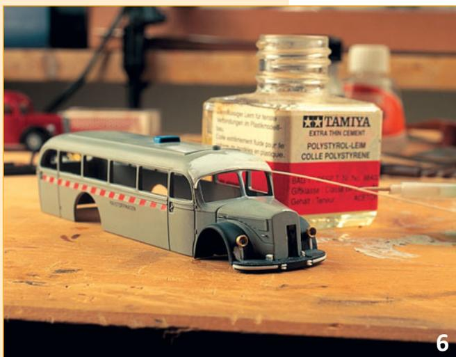
**Bild 6:** Über dem Stirnfenster wird eine schmale Zierleiste aufgesetzt. Gelebt wird mit Flüssigkleber. Die Scheinwerfer stammen aus dem Weinert-Scheinwerfersatz 4354.
