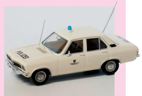
Der Polizei-Ascona ist mit gleich zwei Antennen aus Heki-Borsten ausgestattet. Sie werden in sehr vorsichtig gebohrte Löcher (links) geklebt und silber bemalt.
