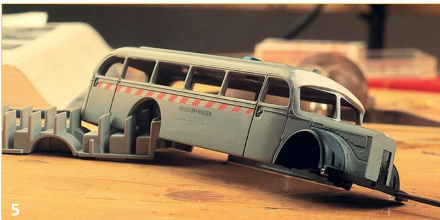
**Bild 1:** Die Stirnpartie des Dachvorbaus wird mittels eines Kunststoffstreifens und Nitropachtel neu modelliert und anschließend mit Schmirgelpapier geglättet.
