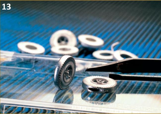
**Bild 13:** Die stark vereinfachten Kunststoffräder werden gegen Trilex-Räder von Weinert ausgetauscht. Um platte Reifen darzustellen, sind die Reifen etwas flachgefeilt.
